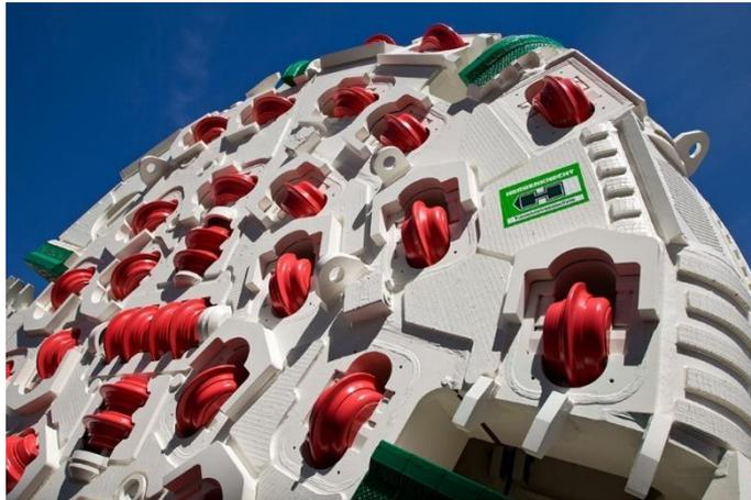
Figura 2.18 - Dettaglio testa fresante TBM doppio scudo (Herrenknecht.com)
