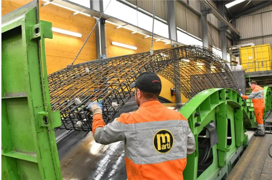
Figura 2.20 - Posizionamento gabbia armatura in casseforme per getto (Solothurnerzeitung.ch)
