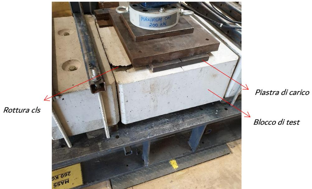
Figura 2.27 - Shear test: schema di carico e rottura del blocco (Geodata)
