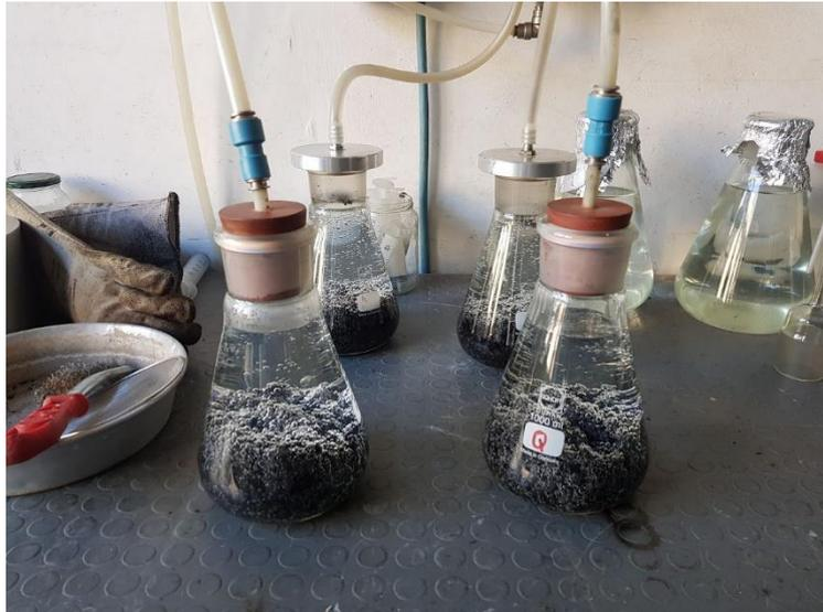
Figura 10 - Disareazione della miscela in acqua distillata
