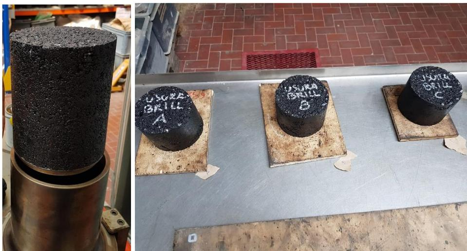
Figura 21 - A sinistra: campione durante l'estrusione; a destra: tre campioni finiti lasciati raffreddare
