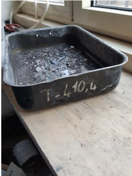
*Figura 16 – Agregati posto lavaggio ma pre essiccazione in stufa*
