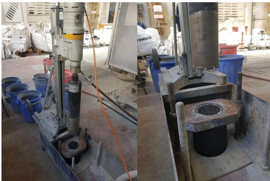
*Figura 28 - Carotatrice con campione nella configurazione corretta per l'avviamento della prova*
