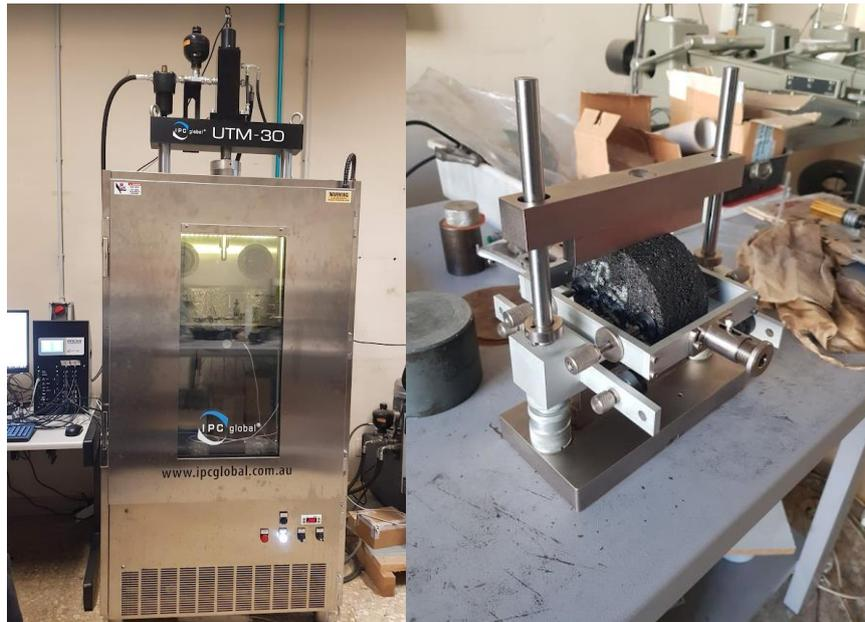
*Figura 25 – A sinistra: UTM-30; a destra: configurazione del campione compattato e del castelletto*
