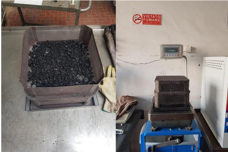
Figura 11 – Posizionamento della miscela nel cestello e valutazione della massa del cestello più la miscela
