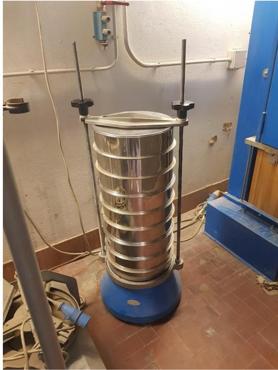
*Figura 17 – Setacci in colonna durante l'azione dell'agitatore meccanico*
