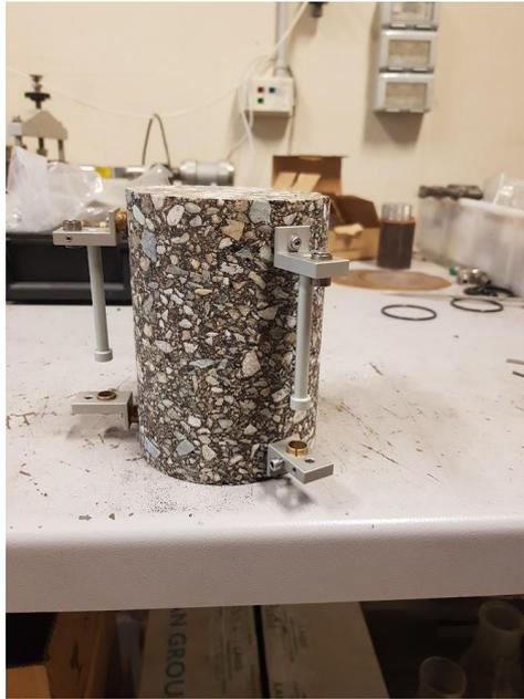
*Figura 32 - Campione per modulo dinamico con porta trasduttori*
