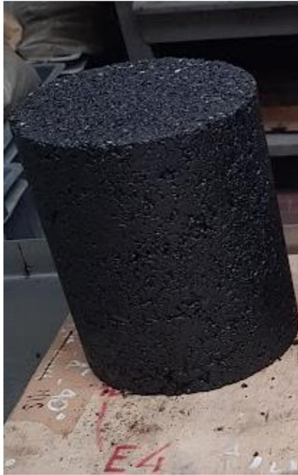
*Figura 27 - Campione compattato ad altezza con pressa a taglio giratorio di dimensioni
