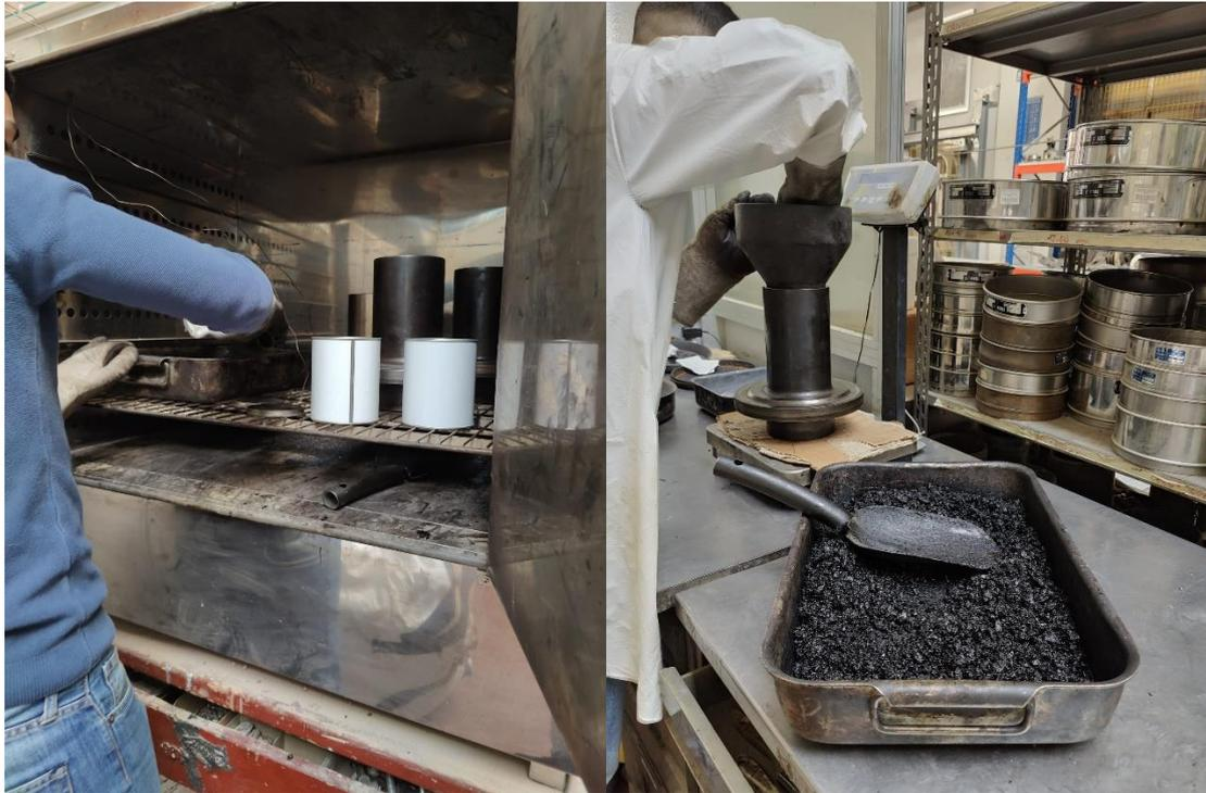
*Figura 18 - A sinistra: riscaldamento della miscela e delle fustelle; a destra: riempimento della fustella con conglomerato bituminoso*
