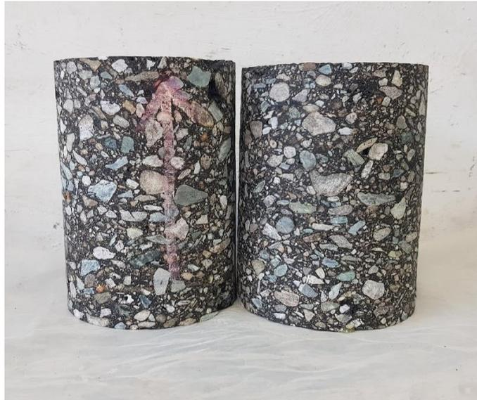
*Figura 40 - A sinistra campione non soggetto al test del flow number, a destra deformazione post test*
