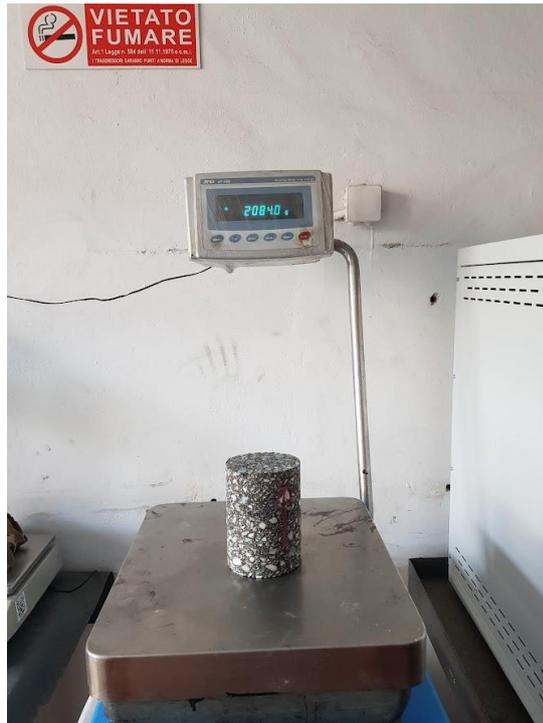
*Figura 30 - Campione finito durante il controllo della completa evaporazione dell'acqua*
