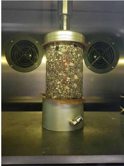
*Figura 39 - Campione nella configurazione di prova all'interno della UTM-30*
