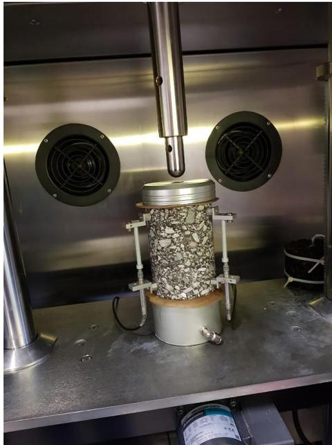
*Figura 33 - Configurazione di prova per il modulo dinamico*
