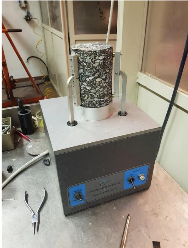
*Figura 31 - Campione finale durante il processo di incollaggio dei dadini*
