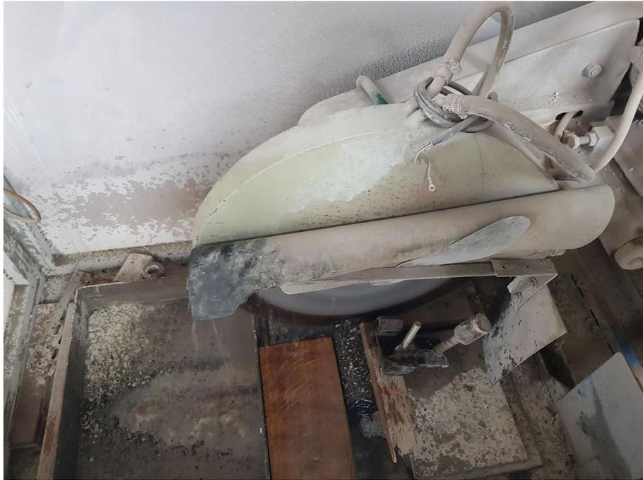
*Figura 29 - Campione carotato durante il processo di taglio di una delle due basi*
