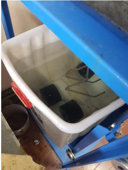
Figura 23 - Campioni immersi in acqua: seconda fase del processo per ricavare MV
