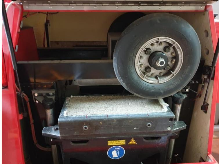
Figura 29 - Macchina ormaiatrice con lastra di materiale pronta per la prova
