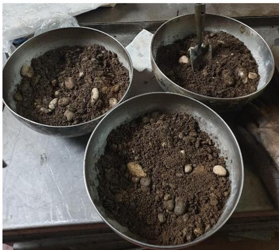
Figura 30 - Preparazione del materiale da inserire nello stampo
