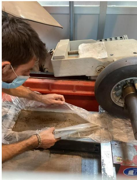
*Figura 31 - Compattazione del materiale*
