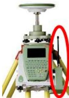
Figura 69: Telefono o radio per trasmissione correzioni differenziali
