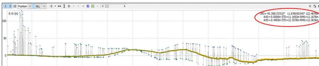
Figura 114: sovrapposizione di 2 soluzioni, relative alla direzione E-W, ossia soluzione SNR 30+cutoff10° e SNR30 + cut off 15°. Valori statistici delle 2 soluzioni nell'area cerchiata in rosso (rispettivamente 2° e 3° rigo)
