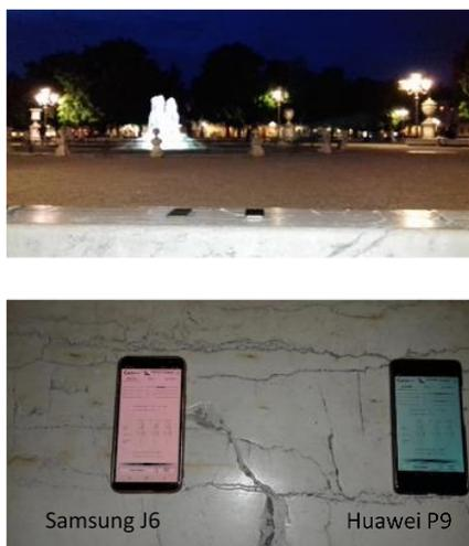
Figura 157: Smartphones in fase di rilievo, affiancati e distanti 30 cm
