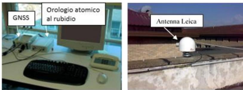
Figura 79: Stazione permanente GNSS del Politecnico di Torino: Ricevitore GNSS con orologio atomico al rubidio + antenna
