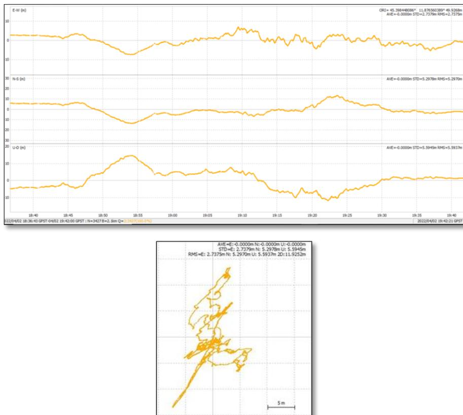
Figura 129: In alto grafico di posizionamento della nuvola di soluzioni ottenute nelle direzioni East-West, North-South, Up-Down; in basso vista planimetrica della nuvola di soluzioni 100 % FLOAT (modalità fissaggio ambiguità: OFF)
