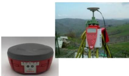
Figura 77: Ricevitore professionale multifrequenza e multi costellazione sia singolo che su treppiedi con antenna e display
