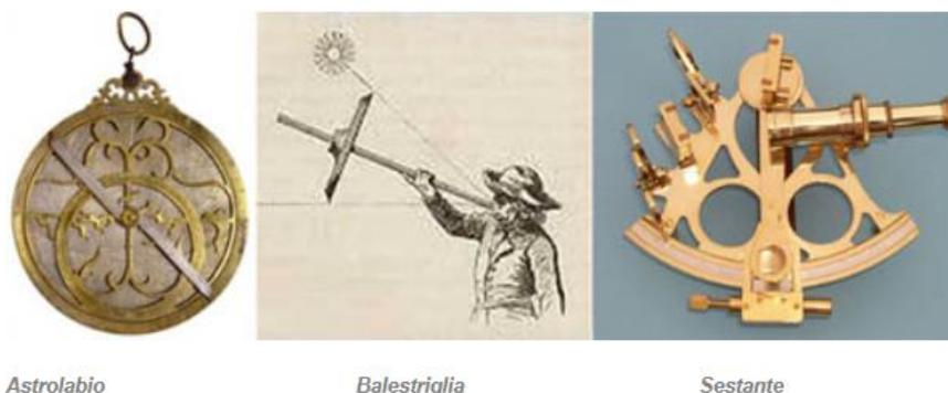
Figura 1: Strumenti di antica navigazione; partendo da sinistra si ha un astrolabio, balestriglia e sestante
