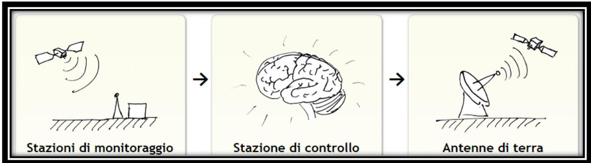
Figura 17: Successione dei passaggi nel segmento di controllo (www.gps.gov)
