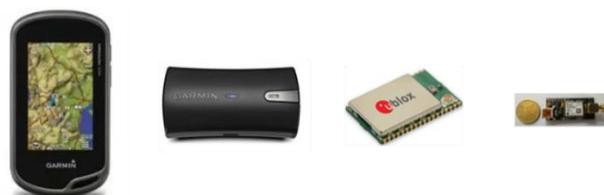
Figura 21: A partire da sinistra: Palmare, Ricevitore esterno GPS/Glonass Bluetooth; scheda ublox; chipset GPS
