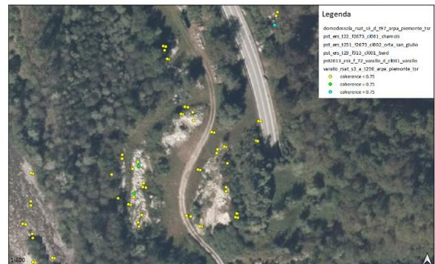
Figura 95 – Esempio 3 di confronto tra velocità media annua di spostamento e coherence dei punti; scala 1:800
