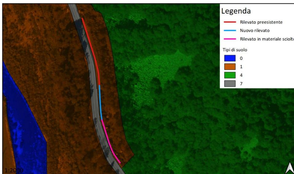
Figura 164 – Rappresentazione del poligono indicante il vallo realizzato a tergo dei rilevati paramassi e del rilevato in materiale sciolto; scala 1:2000
