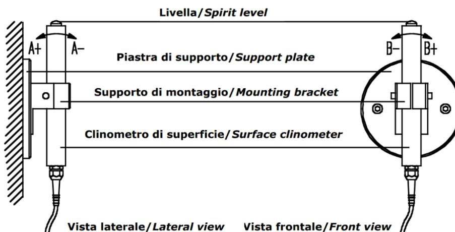
Figura 45 – Esempio di clinometro di superficie
