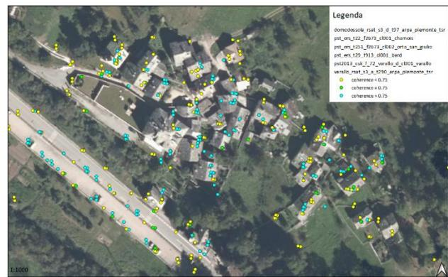
Figura 97 – Esempio 5 di confronto tra velocità media annua di spostamento e coerenza dei punti; scala 1:1000
