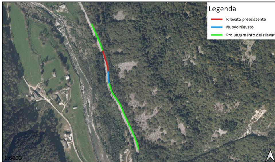
Figura 167 – Rappresentazione del rilevato preesistente, del rilevato di somma urgenza e del prolungamento proposto a nord e a sud di essi; scala 1:6000
