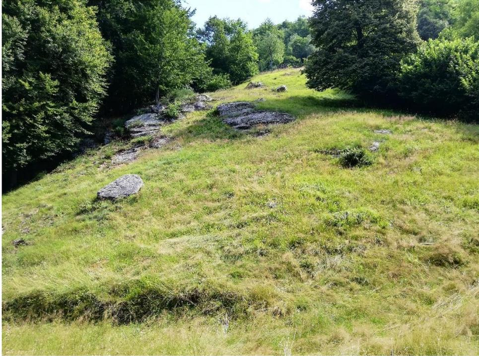
*Figura 82 – Prato in pendenza con rigonfiamenti e gradini morfologici che rivela un senso di spanciamento verso l'osservatore; foto scattata durante il rilevamento di campagna del 14 luglio 2022*
