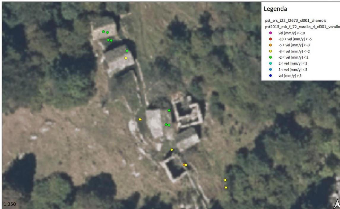
*Figura 91 – Esempio di movimento associabile alla deformazione gravitativa profonda di versante; scala 1:350*
