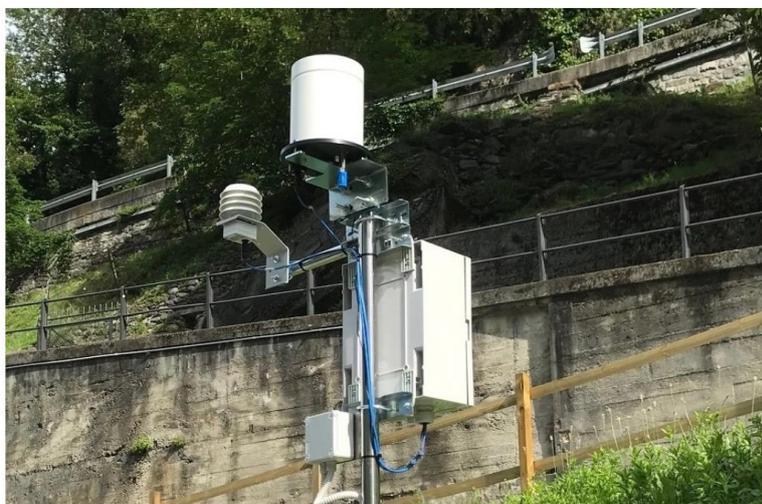
Figura 23 – Esempio di pluviometro
