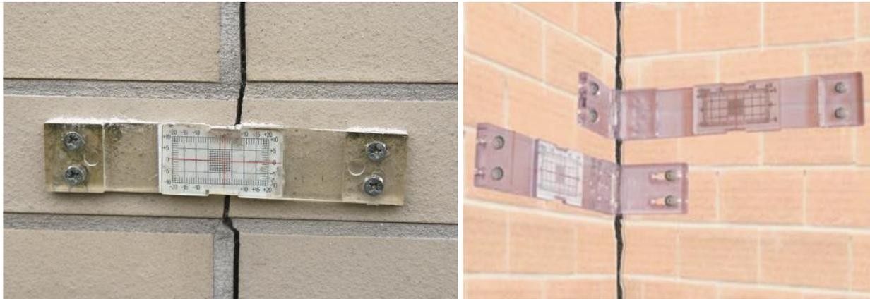
Figura 42 – Esempi di fessurimetri piano (a sinistra) e angolare (a destra)
