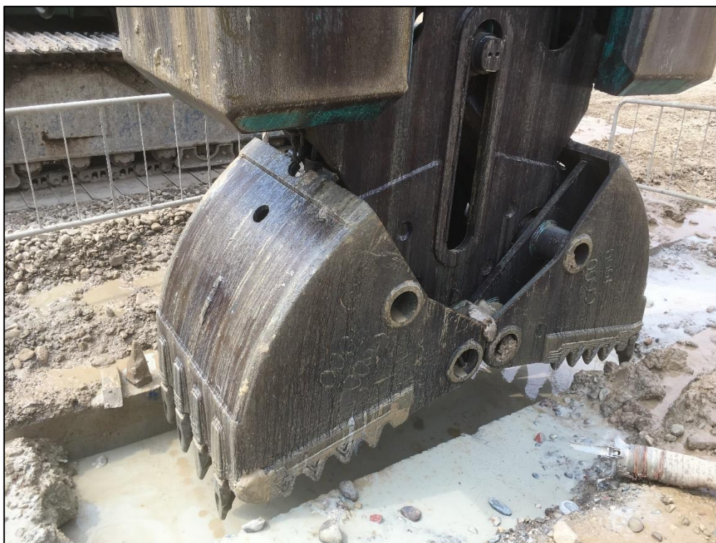
Figura 8.6: dettaglio utensili benna da 7 tonnellate (Casagrande)
