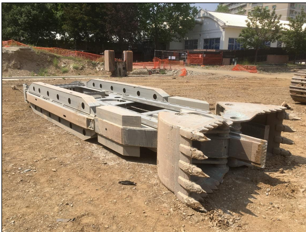
Figura 8.2: benna mordente da 24 tonnellate della Casagrande
