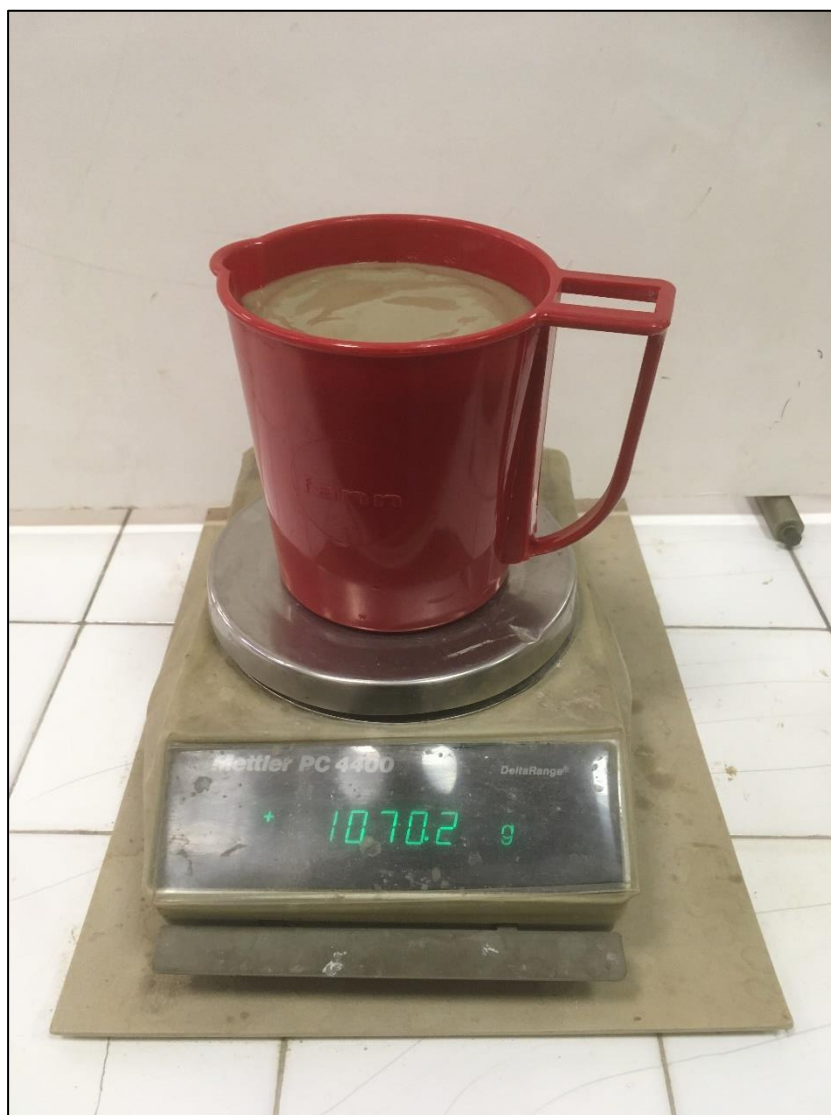
Figura 10.5: misurazione del peso della miscela di slurry per il controllo della massa volumica
