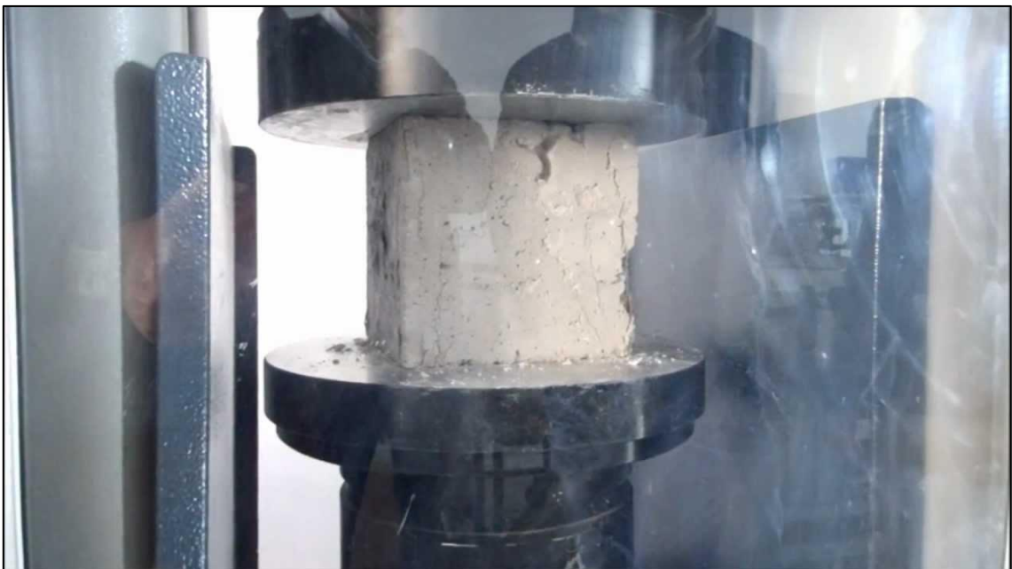
Figura 7.7: esecuzione della prova a compressione cubica su cubetto di calcestruzzo (fonte immagine: Istituto Tecnico per Geometri di Camerino)
