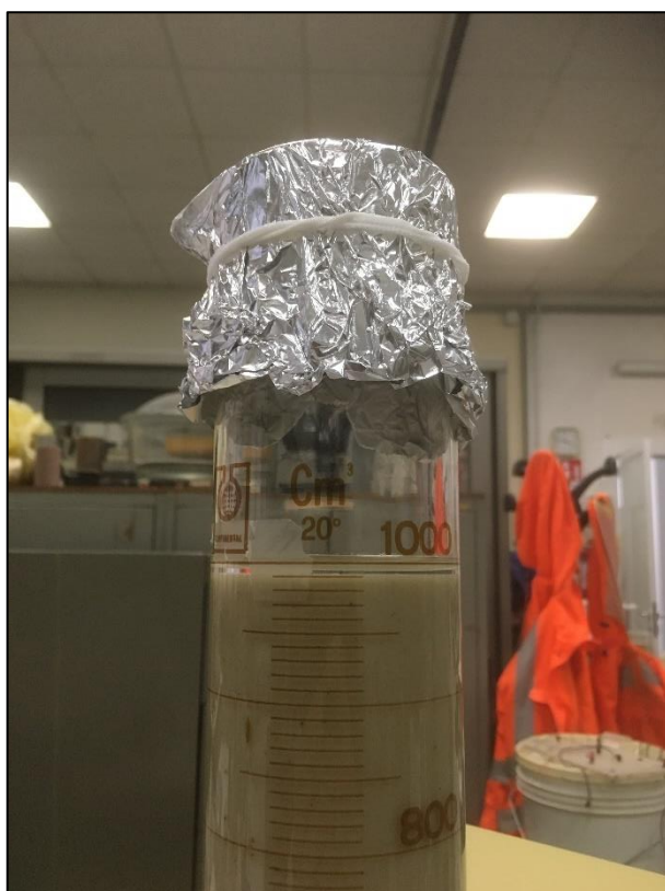
Figura 10.9: livello di sedimentazione raggiunto dalla miscela di slurry ricircolata passata attraverso il dissabbiatore
