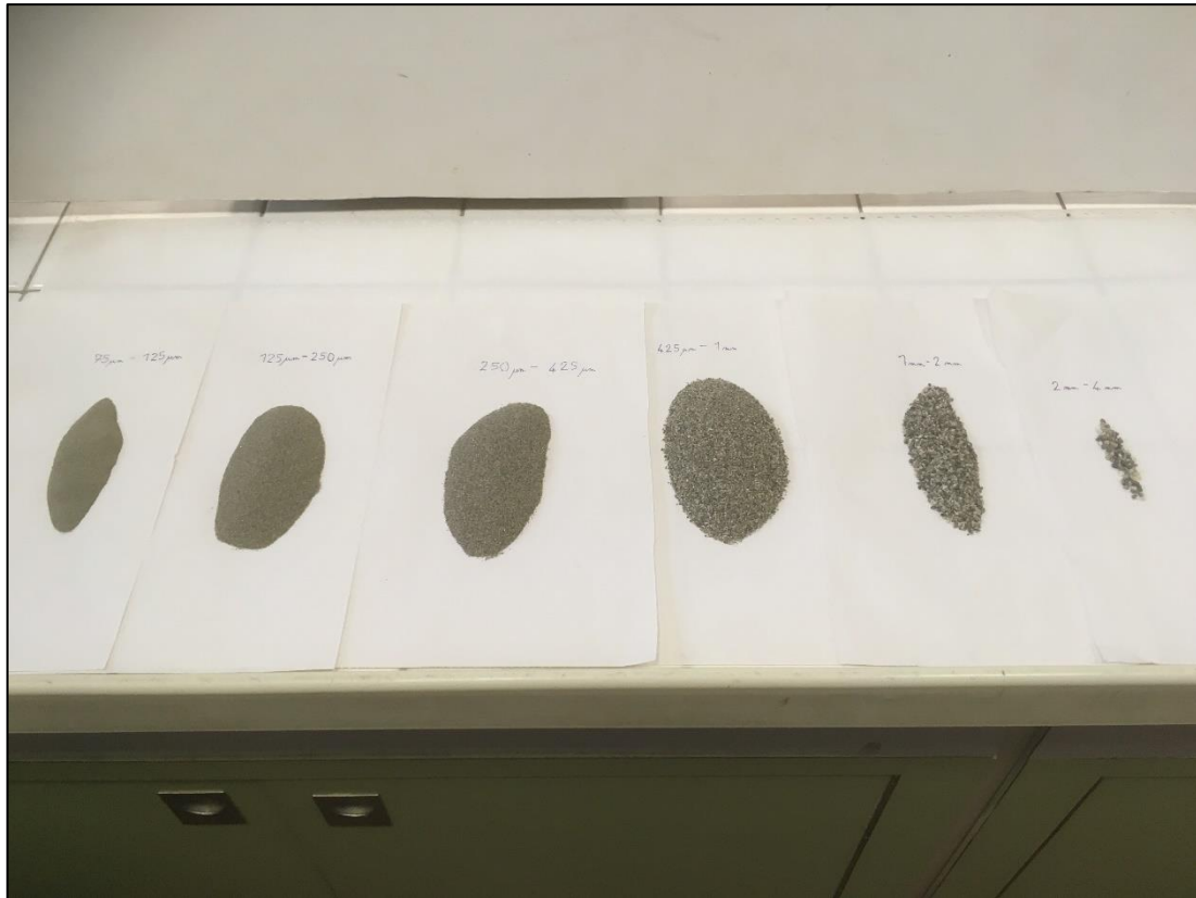
Figura 11.13: comparazione di tutte le frazioni di sabbia raccolte dopo la setacciatura
