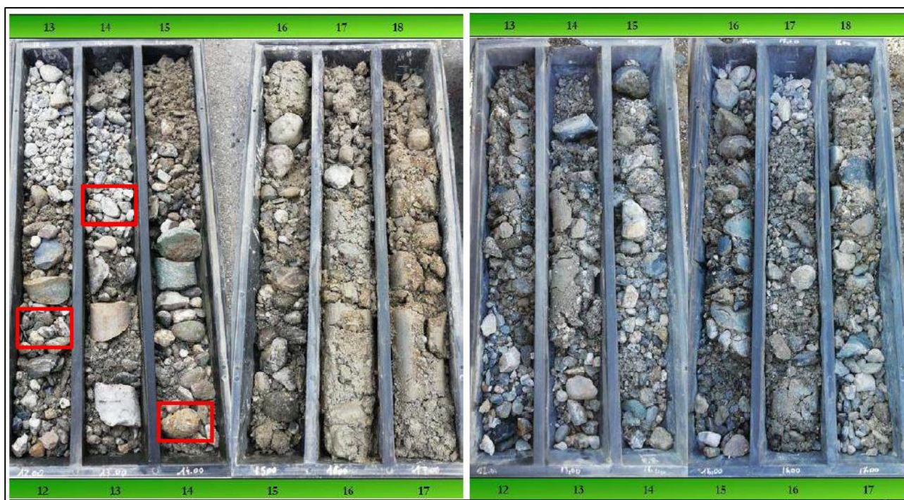
Figura 3.9: tratti tra 12-18 metri dei sondaggi S2 (a sinistra) ed S3 (a destra) dove nei riquadri rossi si possono notare tracce di cementazione
