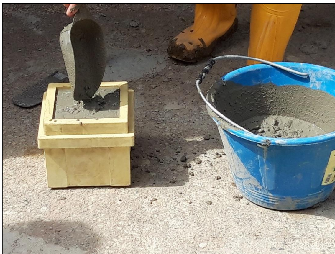
Figura 7.5: versamento del calcestruzzo all'interno dei contenitori
