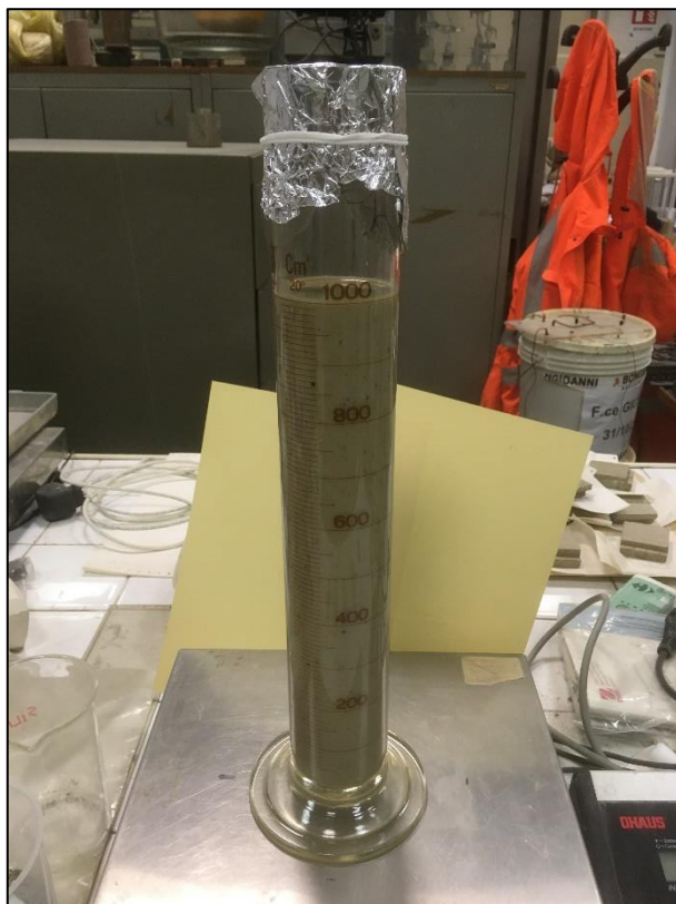
Figura 10.6: cilindro graduato utilizzato in laboratorio per le prove di sedimentazione (in foto test sulla bentonite ricircolata non passata al dissabbiatore)
