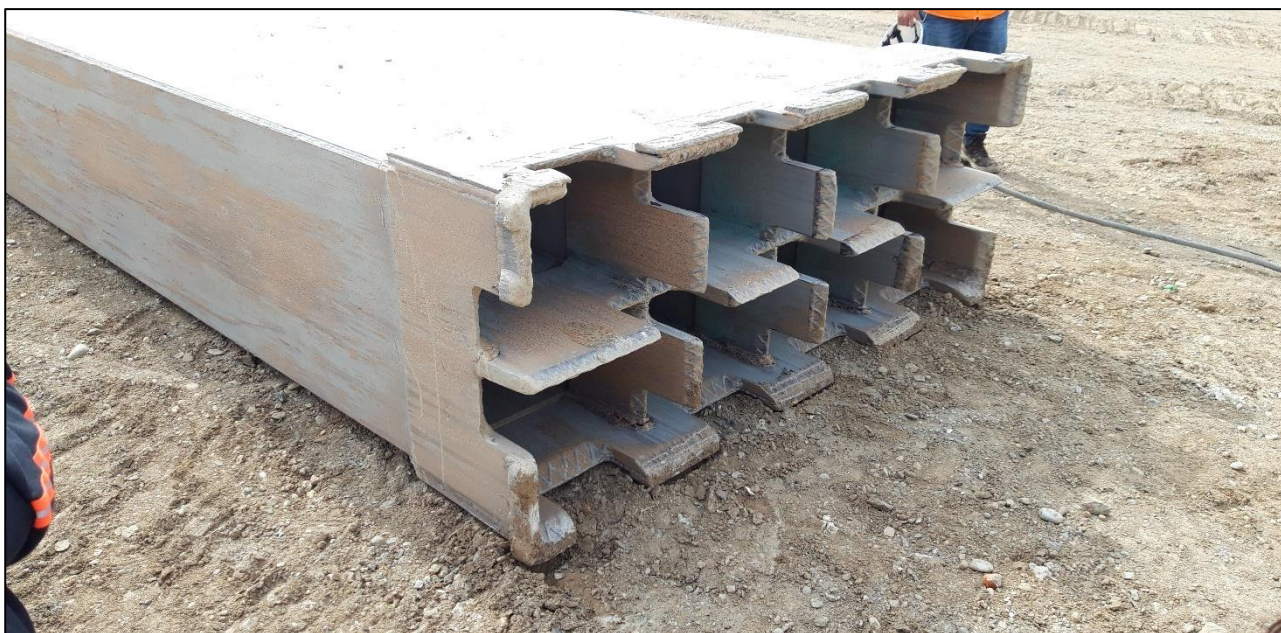
Figura 8.9: dettaglio estremità scalpello per diaframmi
