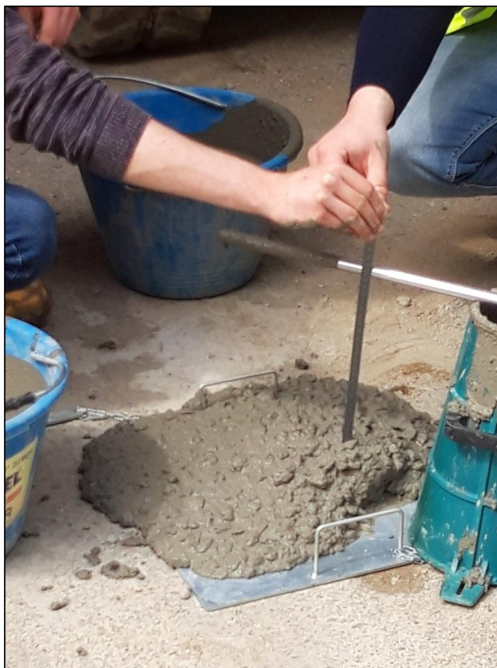
Figura 7.3: esecuzione di Slump Test, misurazione dell'abbassamento dopo la rimozione del Cono di Abrams
