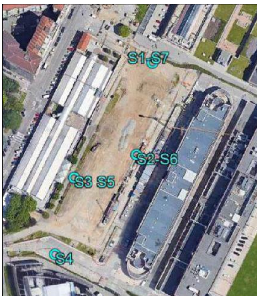
Figura 3.8: disposizione dei sette sondaggi geognostici effettuati a febbraio-marzo 2022
