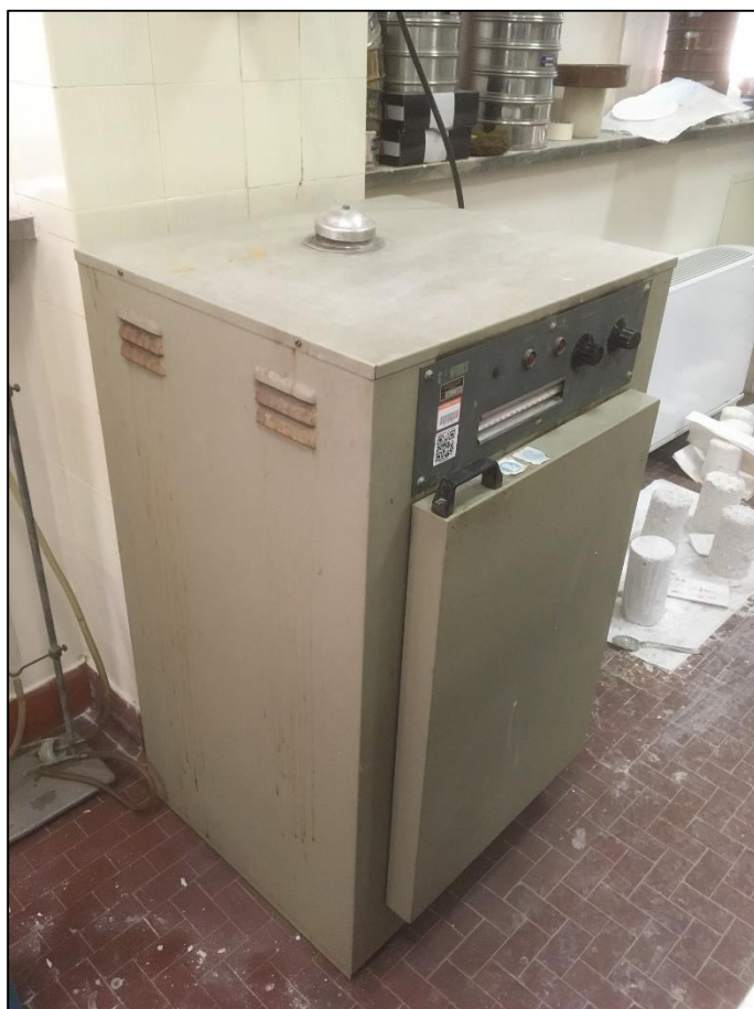
Figura 11.2: forno dove è stata asciugata la sabbia
