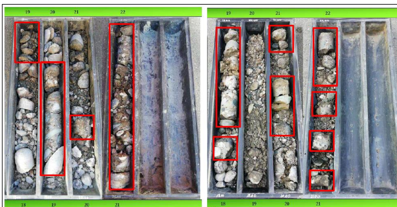
Figura 3.10: tratti tra 18-22 metri dei sondaggi S1 (a sinistra) ed S2 (a destra) dove nei riquadri rossi si possono notare livelli ad elevata cementazione (puddinghe)
