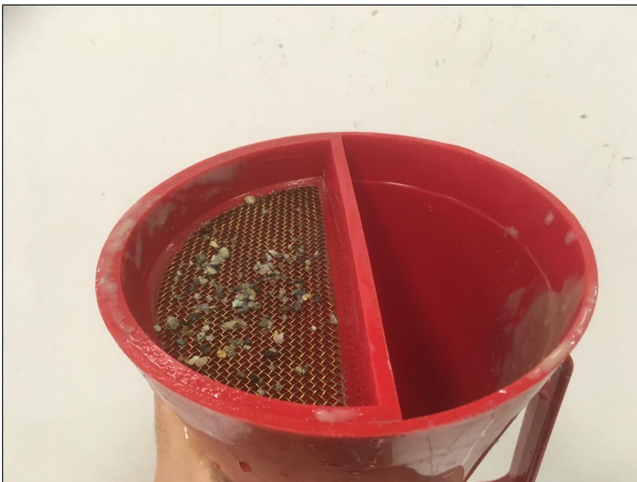
Figura 10.4: grani trattenuti sul retino dopo la prova di fluidità
