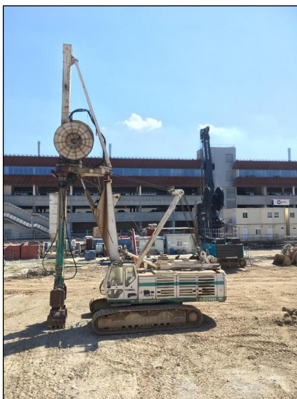
Figura 8.3: Casagrande meccanica C600HD funzionante con il braccio telescopico (con benna da 7 tonnellate)
