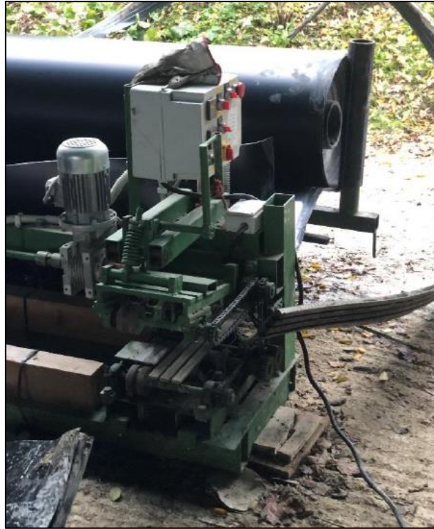
Figura 2.11: macchinario che permette la saldatura del giunto sul telo in HDPE
