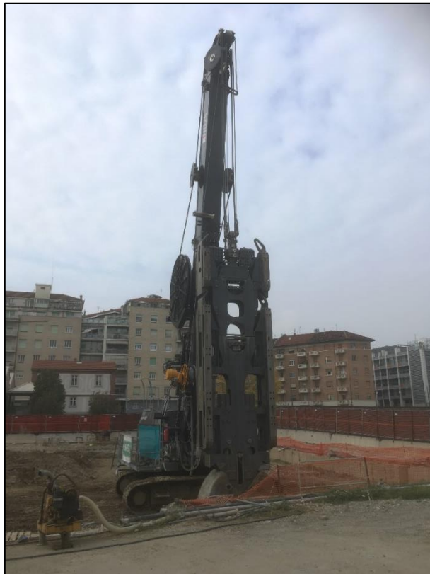
Figura 8.5: Casagrande B300 a funzionamento semi-idraulico con le funi (con benna da 24 tonnellate)
