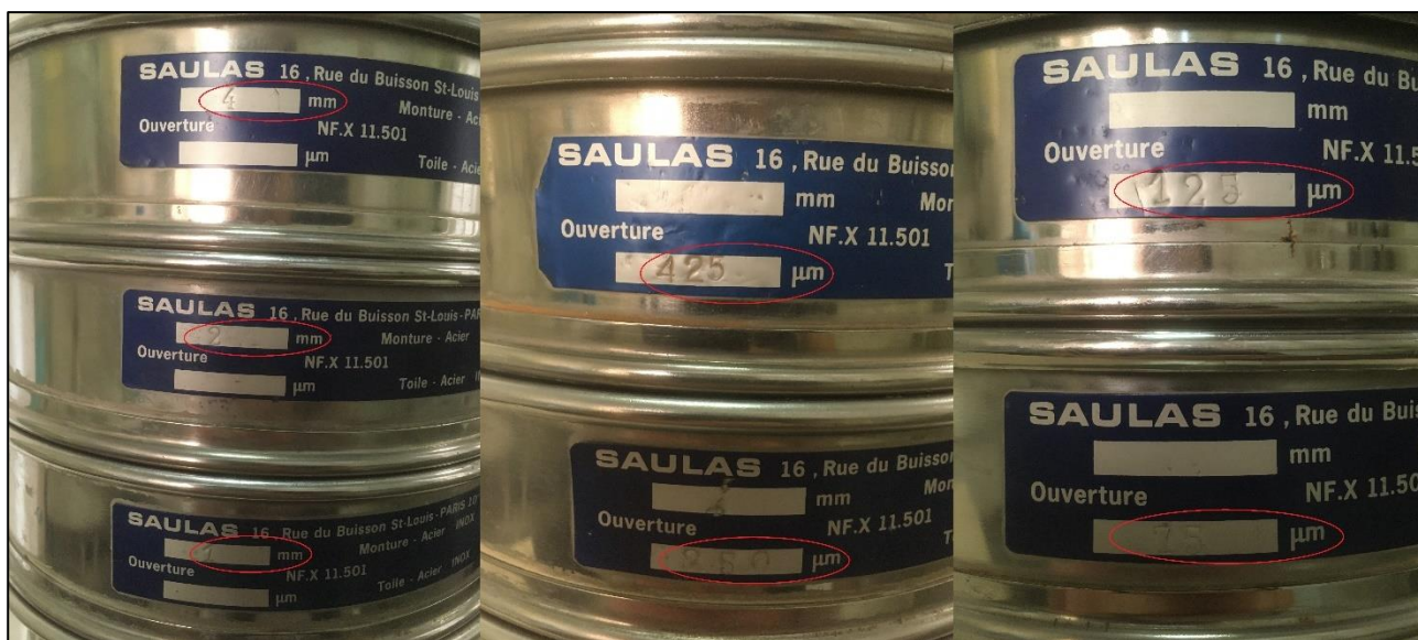
Figura 11.5: dettaglio valori fori dei vari setacci
