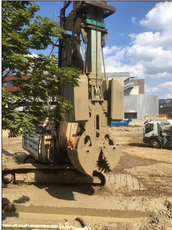
Figura 16.3: Casagrande meccanica C600HD con benna da 7 tonnellate
