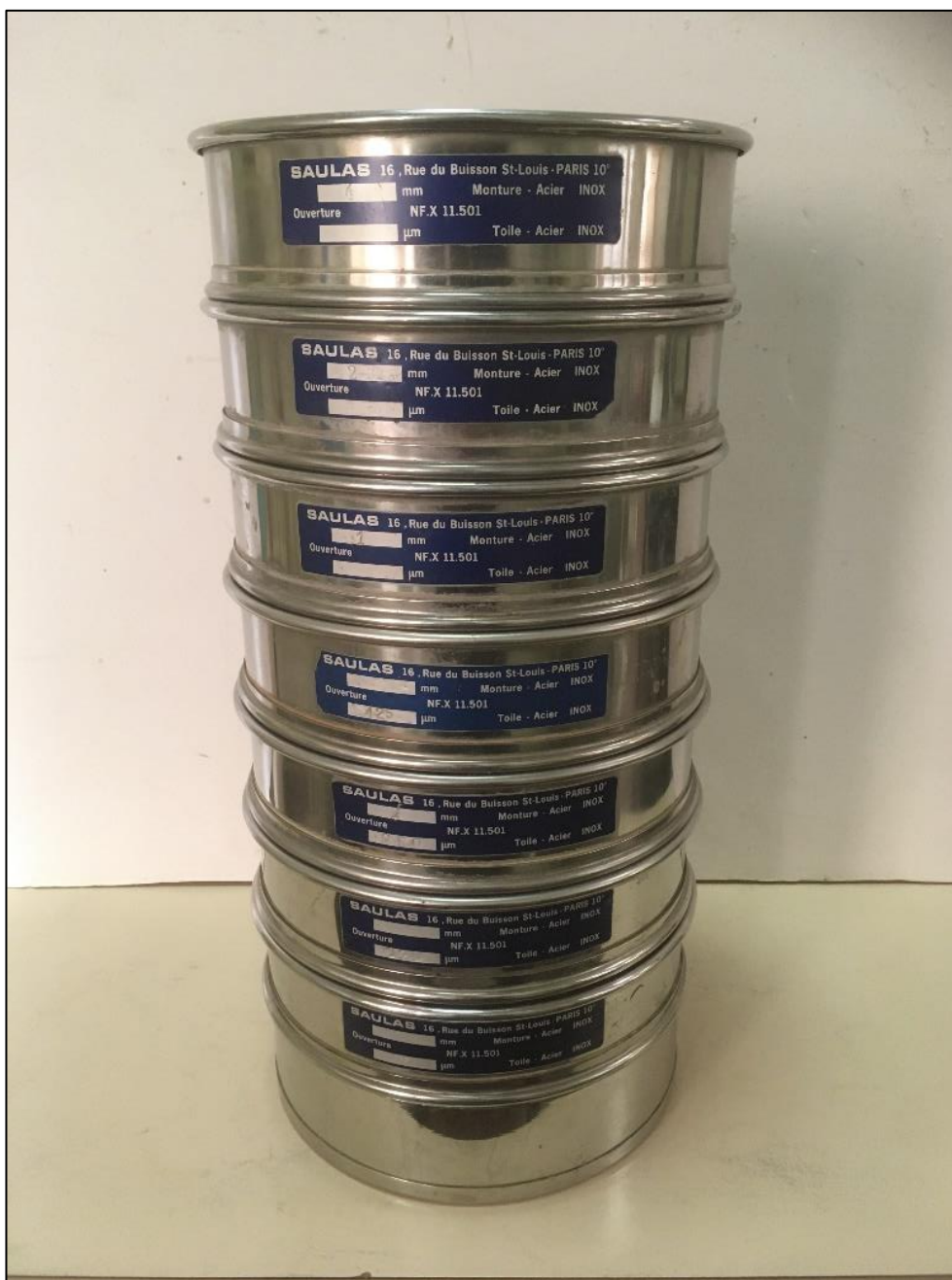
Figura 11.4: setacci utilizzati per l'analisi granulometrica
