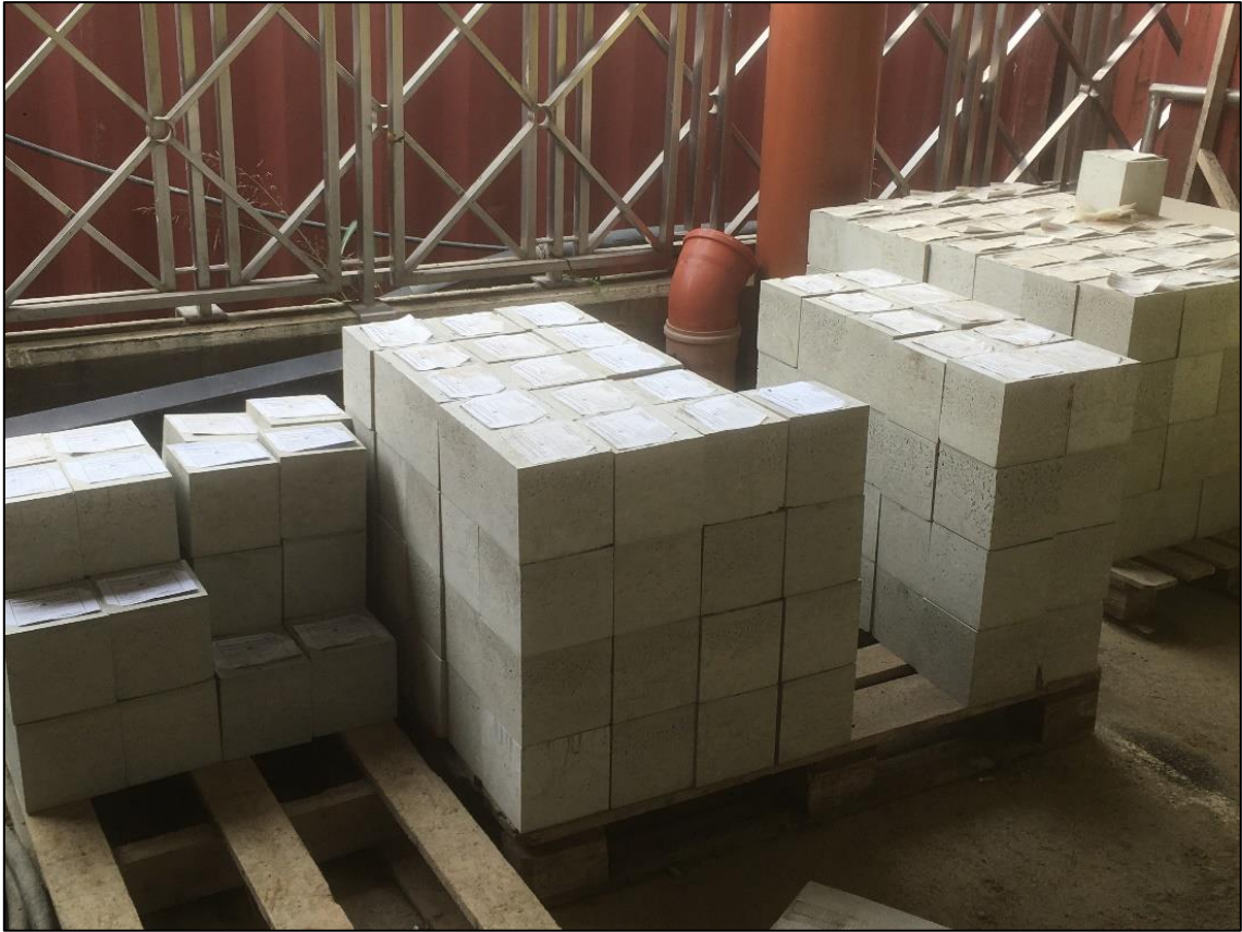
Figura 7.6: cubetti di calcestruzzo indurito pronti per la prova a compressione cubica
