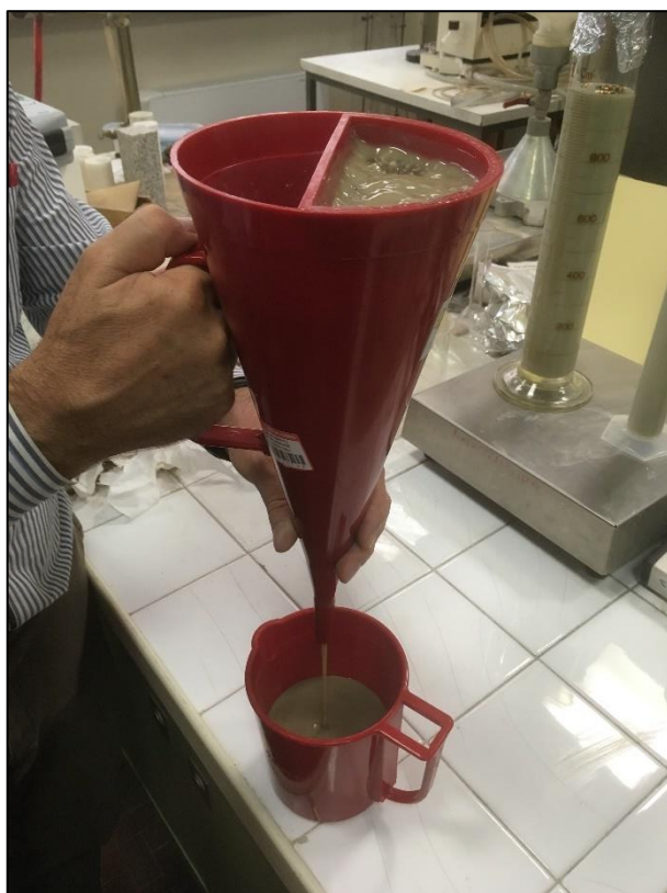
Figura 10.3: prova di viscosità in esecuzione
