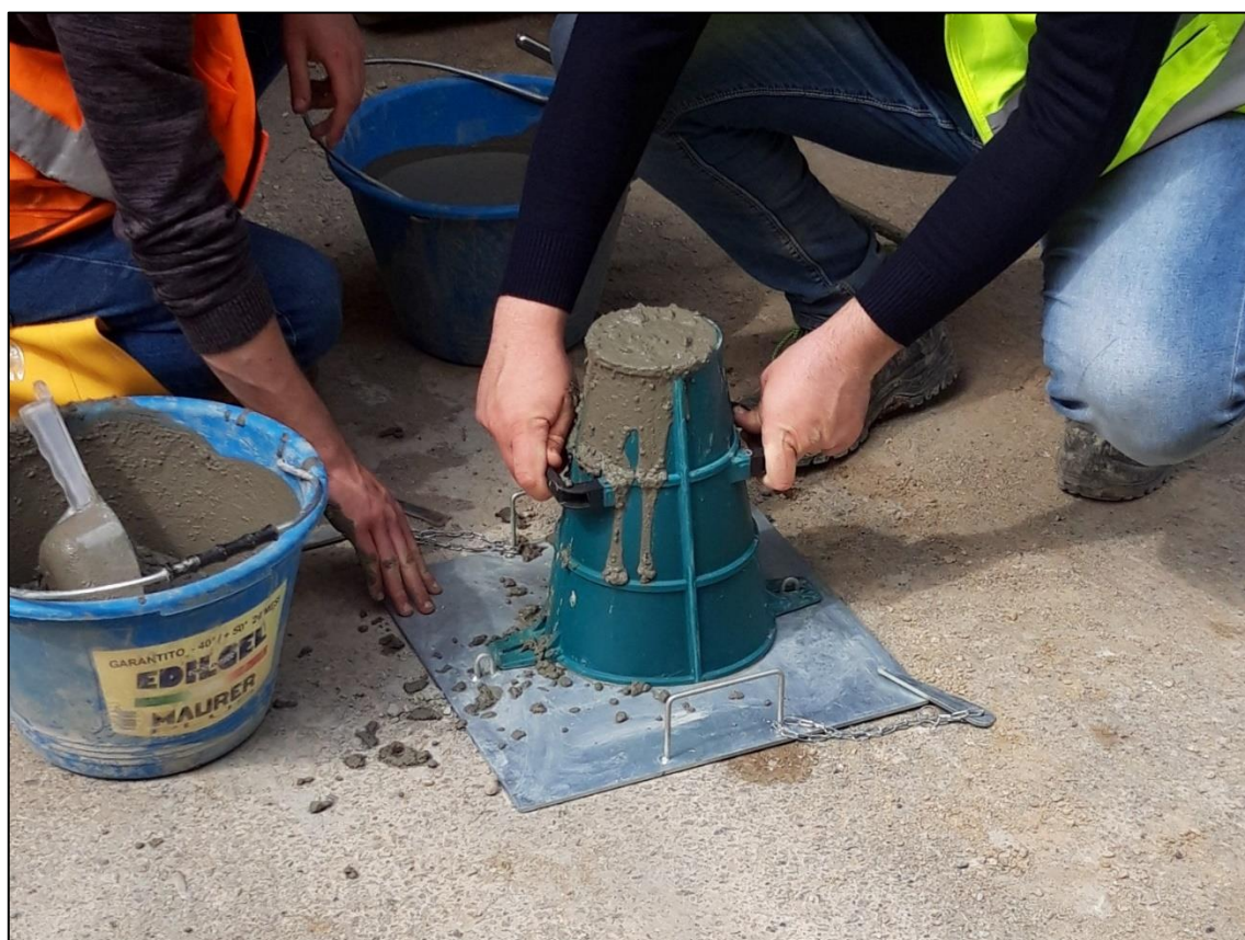
Figura 7.2: esecuzione di Slump Test, versamento calcestruzzo all'interno del Cono di Abrams
