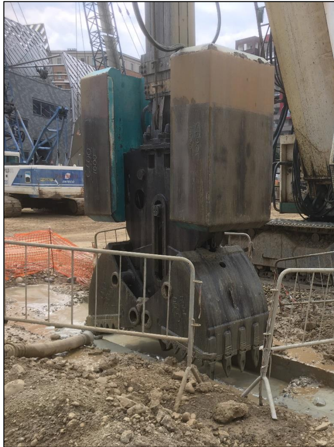
Figura 8.1: benna mordente da 7 tonnellate della Casagrande
