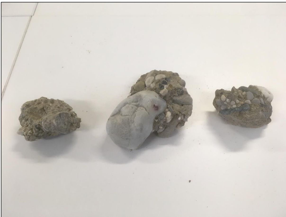
Figura 3.13: dettaglio di porzioni di puddinghe prelevati dal cantiere in esame
