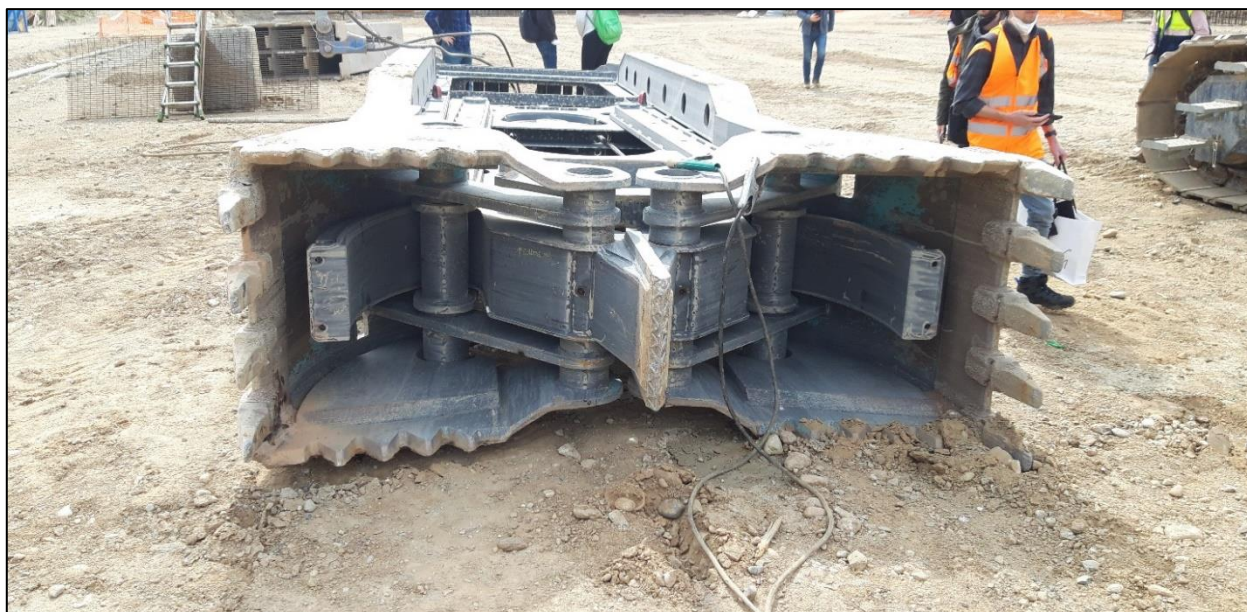
Figura 16.9: dettaglio della benna da 24 tonnellate della Casagrande
