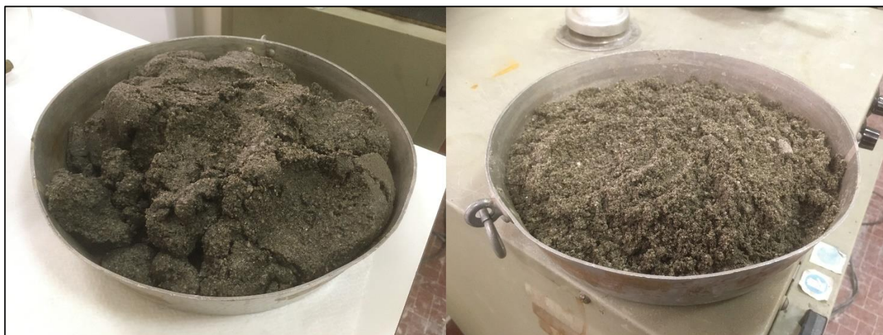
Figura 11.3: differenza tra la sabbia prima (a sinistra) e dopo (a destra) la rigrata
