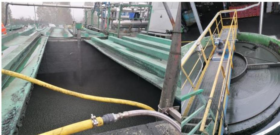
Fig. 4- Report fotografico dell'impianto di Villastellone (TO). Polmonazione (in alto sx), batteria di filtri (in alto dx), Vasca Oxo1 (in basso sx) e Sedimentatore (in basso dx).
