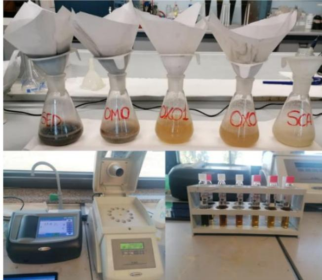
Fig. 8- Fase di analisi in LAB. su campioni filtrati, in basso a sx spettrogramma e reattore, in baso a dx kit.
