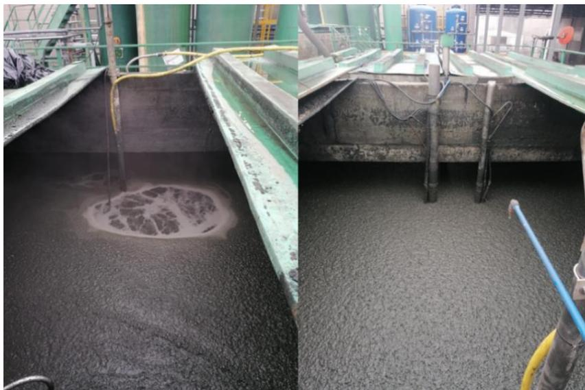
Fig. 59- Oxo1 Oxo2 con sistema d'aerazione ad ossigeno puro. Concentrazioni di MLVSS 3-4 [kgVSS/m<sup>3</sup>] e ossigeno disciolto pari 2.5 [mg/L]. Novembre 2022.
