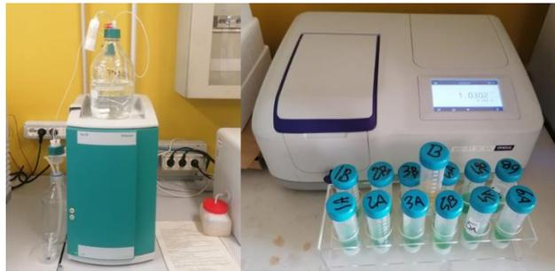
Fig. 42- (sx) analisi  $N-NO_2^-$   $N-NO_3^-$  cromatografo ionico, (dx) analisi  $N-NH_4^+$ .
