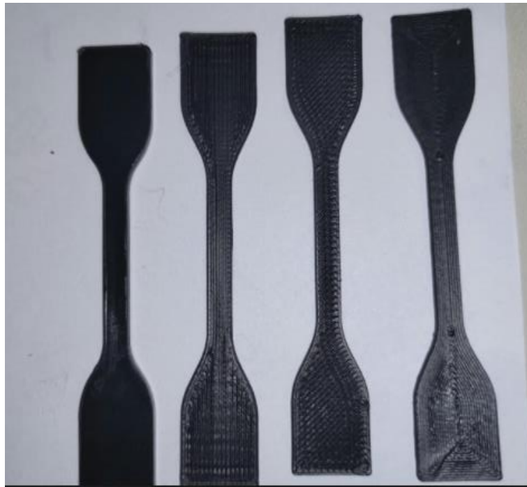
Figura 3.2.3 - Fotografia dei provini ottenuti in ordine da sinistra a destra per injection moulding, 3DP 0°, 3DP 45° e Full Shell
