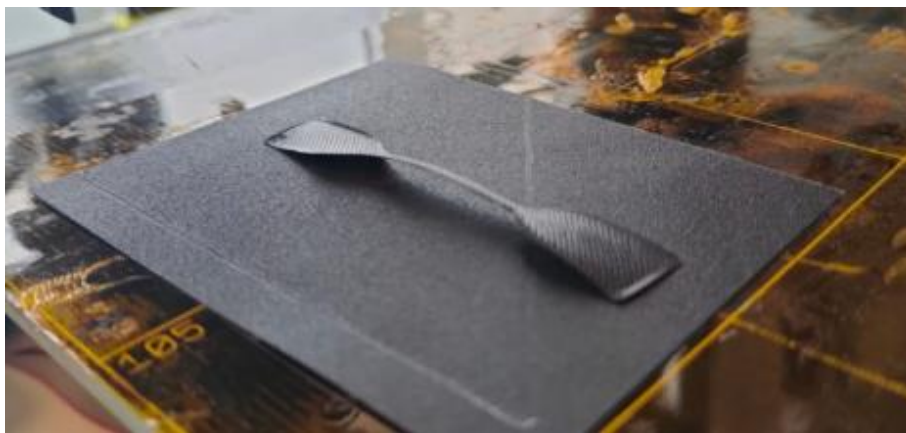
Figura 3.3.1.3- Immagine che mostra la stampa fallita a causa dell'imbarco e non aderenza del provino capovolto (senza raft) al tappetino di PP
