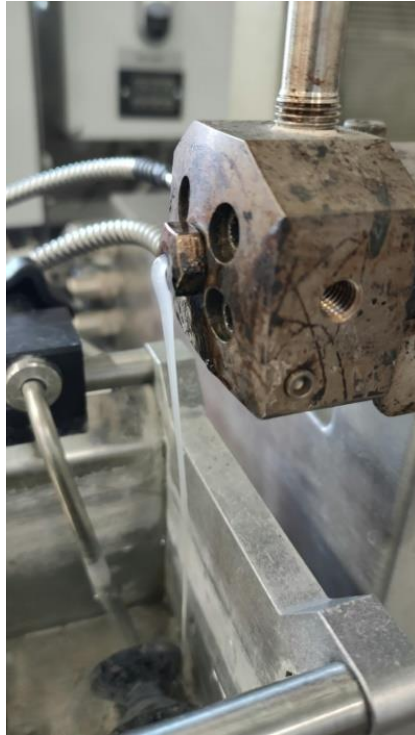
Figura 2.17 – Fotografia dell'ugello dell'estrusore mentre viene estruso PLA60/PBS40
