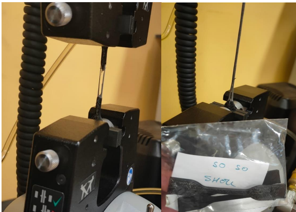
Figura 3.3.2.1.20 – Fotografia dei provini durante la prova di trazione. La fotografia a sinistra è relativa del provino stampato secondo inclinazione 0°, a destra il provino stampato con inclinazione shell.
