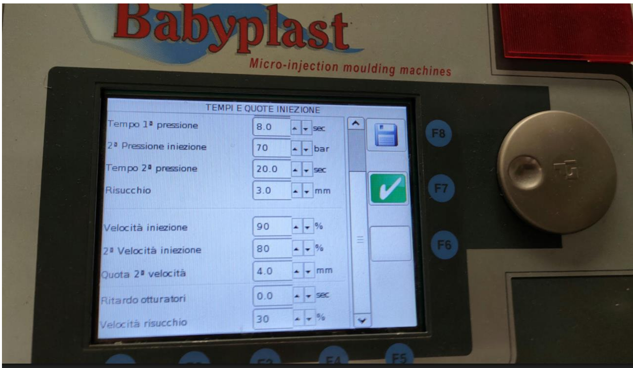
Figura 2.6.3- Immagine del pannello di controllo della Babyplast micro-injection moulding machine ed esempio di parametri da inserire per ottimizzare la fase di injection molding
