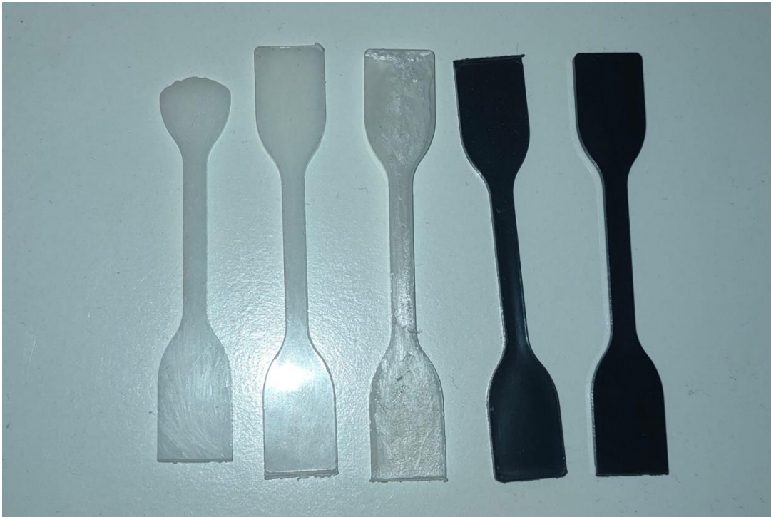
Figura 2.6.4 – Fotografia dei provini prodotti secondo IM ma scartati per la fase di caratterizzazione meccanica per prova di trazione
