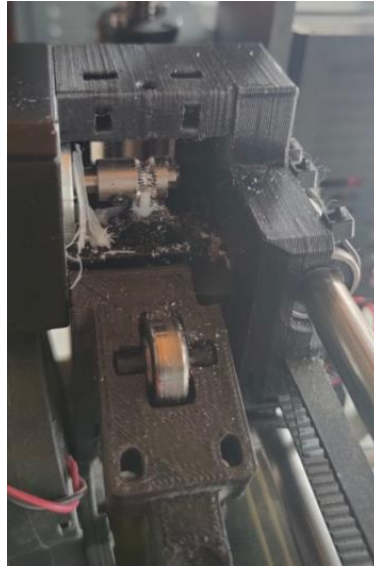
Figura 3.3.1.4- Immagine che mostra il filamento spezzato ed esfoliato all'interno del sistema di tiraggio della stampante Prusa MK2 a singola ruota dentata e cuscinetto liscio
