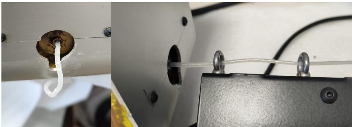
Figura 3.2.2 - Fotografie dell'estruso uscendo dall'ugello dell'estrusore PLA60/PBS30/PHB10. La foto a sinistra mostra la composizione estrusa a 168°C mentre a destra a 170°C.
