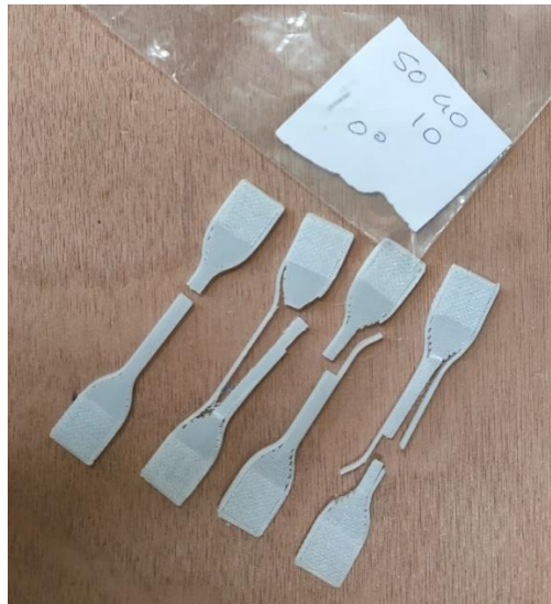
Figura 3.3.2.2.8 – Fotografia dei provini stampati 3DP a 0° fratturati dopo la prova di trazione
