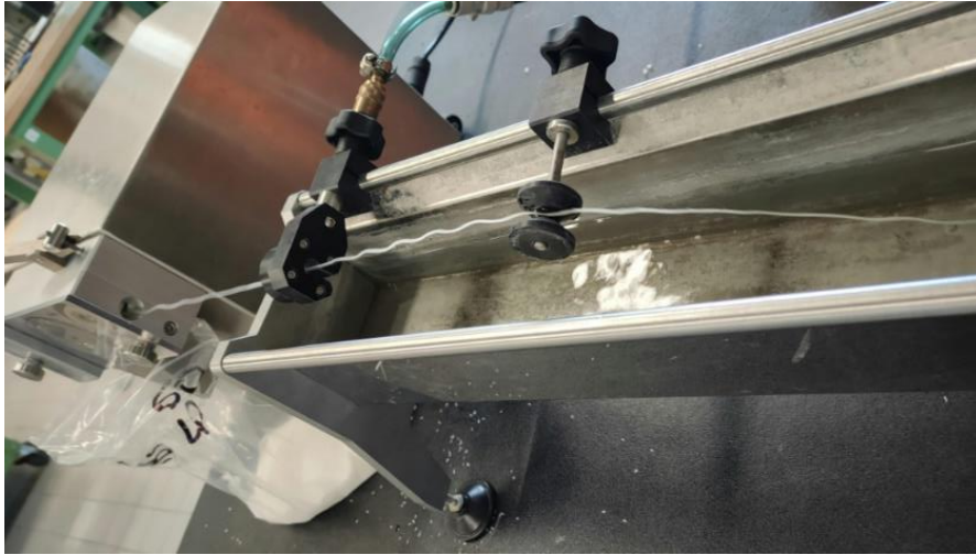
Figura 2.3- Foto del sistema di raffreddamento dell'estruso e taglierina
