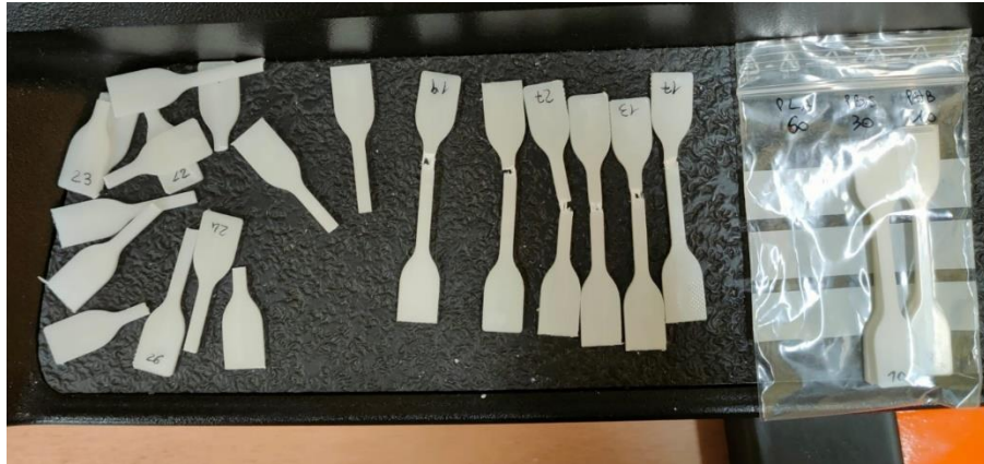
Figura 3.1.3.7 – Fotografia dei provini ad osso di cane dopo la prova a trazione
