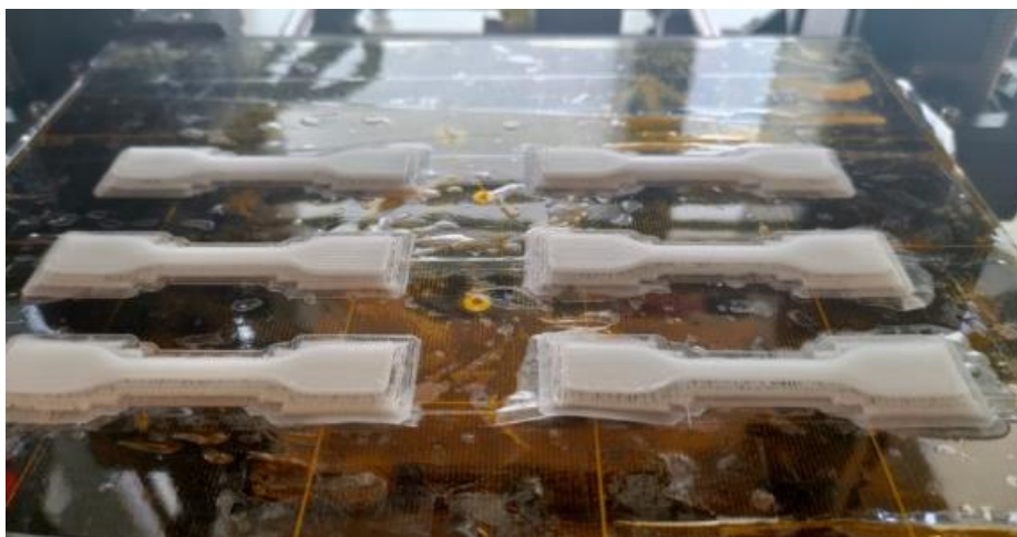
Figura 3.3.1.2- La fotografia mostra i provini di PP puro stampati in 3DP. E' possibile notare lo scotch tape, il raft e il provino finito.
