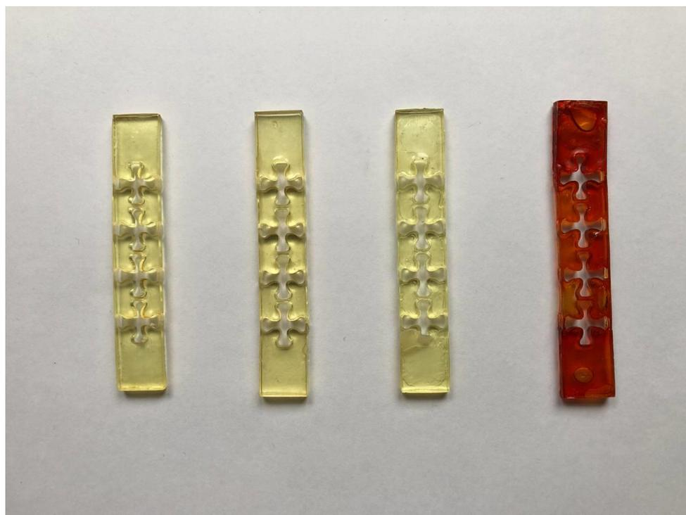
**Figura 7.3** Da sinistra: metamateriale acustico realizzato con miscela HDDA 20, HDDA 40, HDDA 50 e HDDA 50 MR
