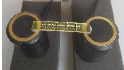
**Figura 6.8** Dettaglio della figura 6.7 in cui si può osservare l'accoppiamento trasduttore provino.
