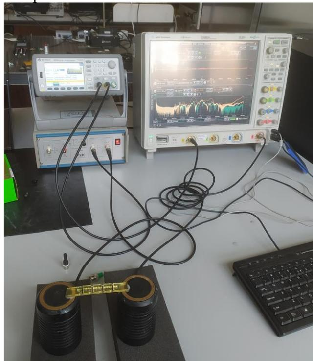
**Figura 6.7** Disposizione utilizzata per le misure con gli ultrasuoni: provino sui trasduttori i quali sono collegati uno al generatore di onde sinusoidali e uno al computer per la lettura del segnale di output.
