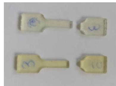
Figura 6.18 campioni di BEDA e AESO giunti a frattura.
