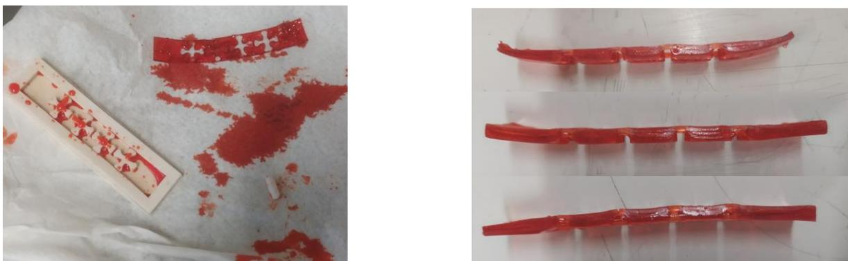
**Figura 6.3** Problemi nella realizzazione dei metamateriali modulabili: miscela non reticolata e campioni con difetti nella regolarità della sezione
