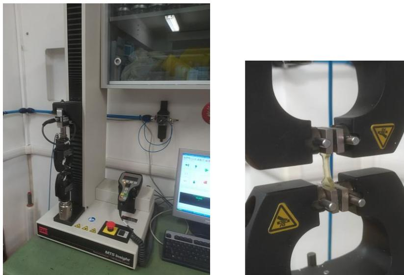
**Figura 6.5** Strumento per prove di trazione e dettaglio degli afferraggi utilizzati nei test.
