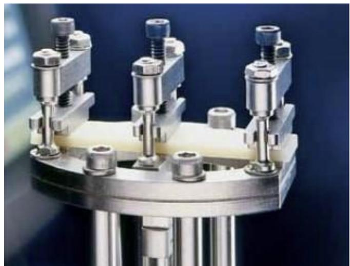
Figura 79 Sistema di fissaggio del campione dual cantilever. [20]
