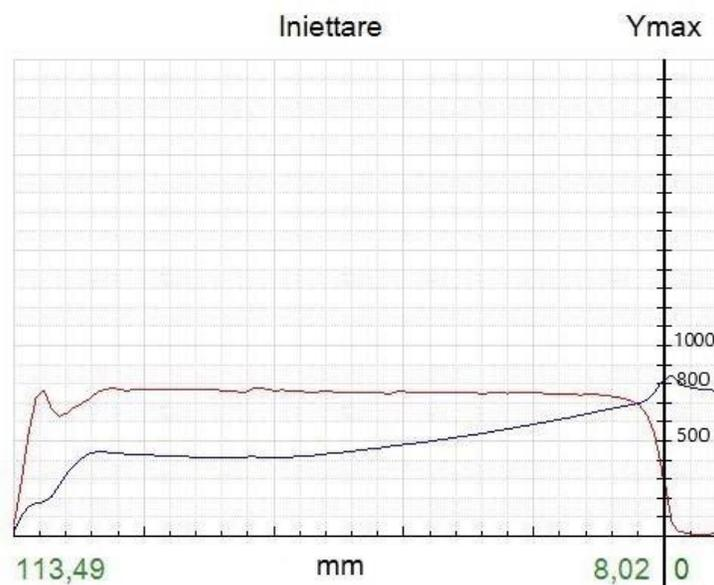
Grafico 20 Profilo di pressione di filling applicato in Prova 9.
