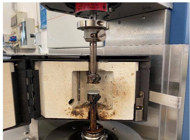
Figura 78 Dettaglio del reometro. Camera riscaldata in materiale refrattario e configurazione a piatti piani paralleli.
