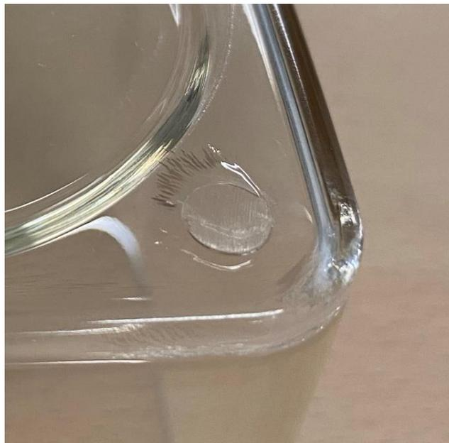
Figura 94 Deformazione causata dall'azione degli estrattori.
