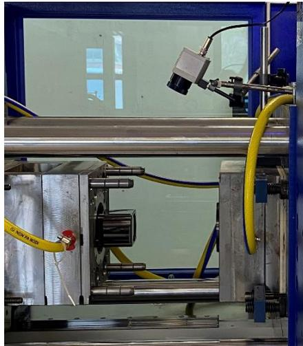
*Figura 24 Configurazione in cui è montata la telecamera termica sulla pressa.*
