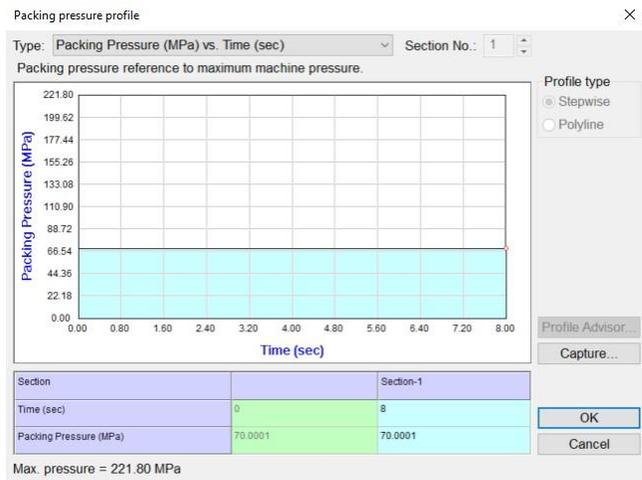
Figura 33 Profilo di pressione di packing di analisi 1.
