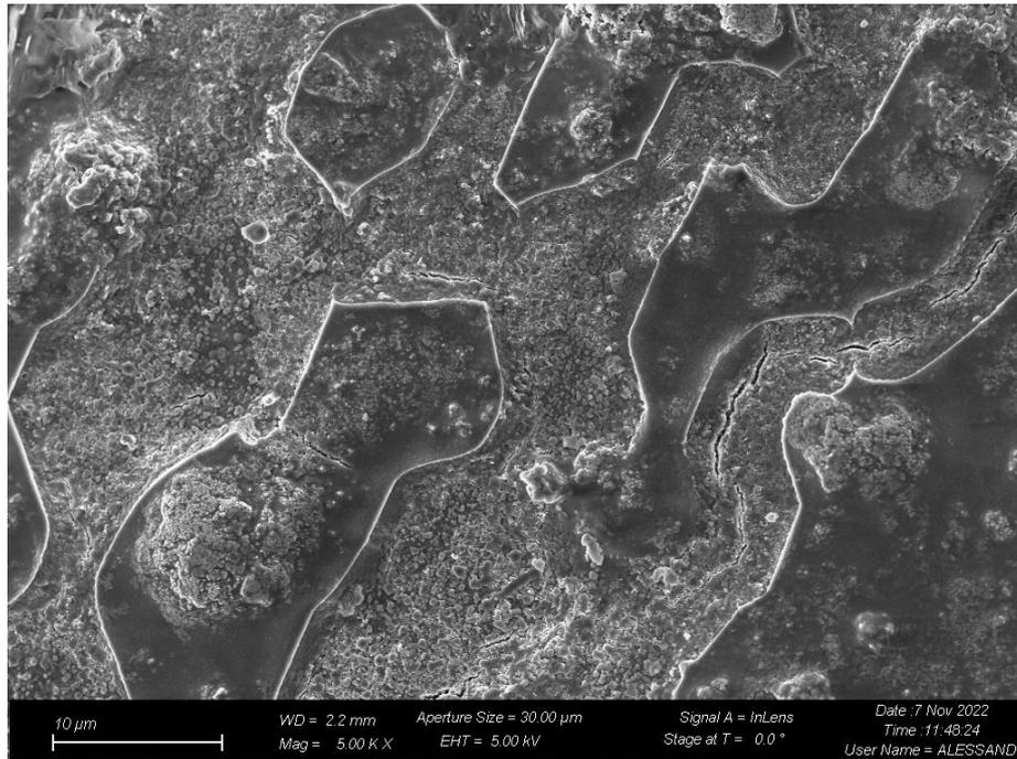
**Figura 4.34:** Immagine FE-SEM a ingrandimento 5000X di una regione dell'anodo a base di SnO<sub>2</sub> con composizione 85/10/5 ciclato.
