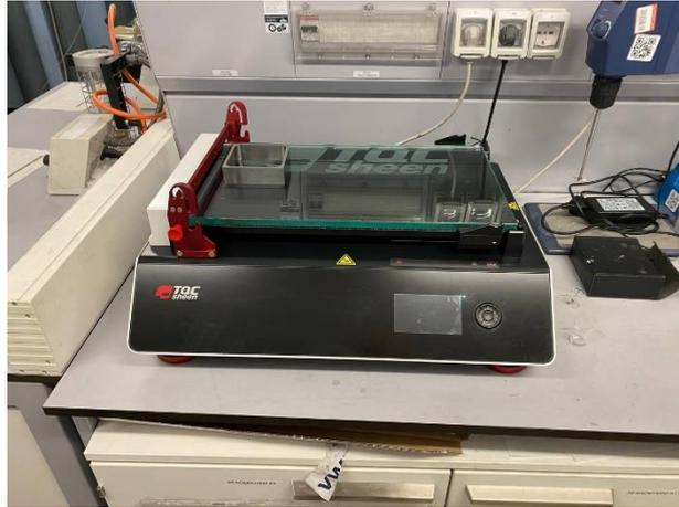
**Figura 3.2:** Modello di applicatore di film automatico TQC sheen utilizzato con appoggiato il *doctor blade*.
