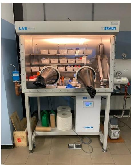
Figura 3.5: Modello di glove box MBraun® Labmaster Pro utilizzato nel lavoro di tesi.
