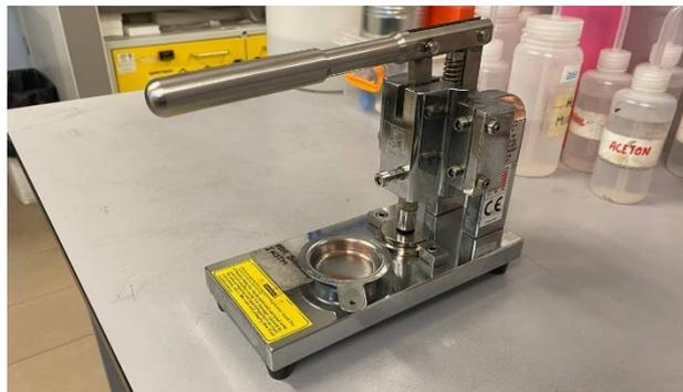
**Figura 3.3:** Modello di cutter manuale utilizzato.
