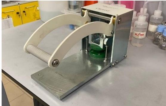
Figura 3.6: Modello di *crimper* manuale utilizzata.
