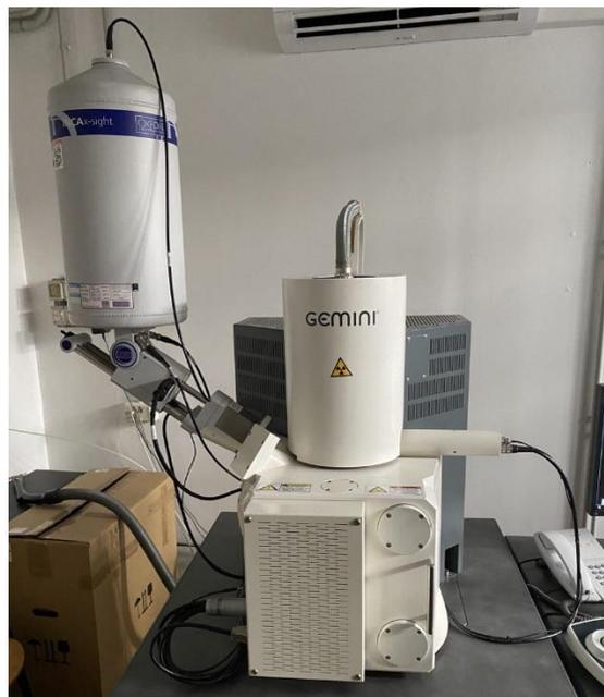
**Figura 3.22:** Modello di FE-SEM utilizzato nel lavoro di tesi.
