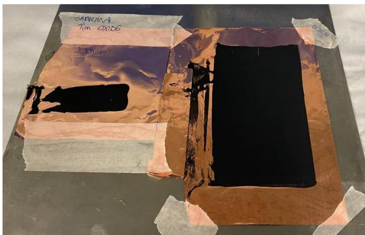
**Figura 3.14:** Stesa dell'elettrodo a base di ossido di stagno su collettore in rame.
