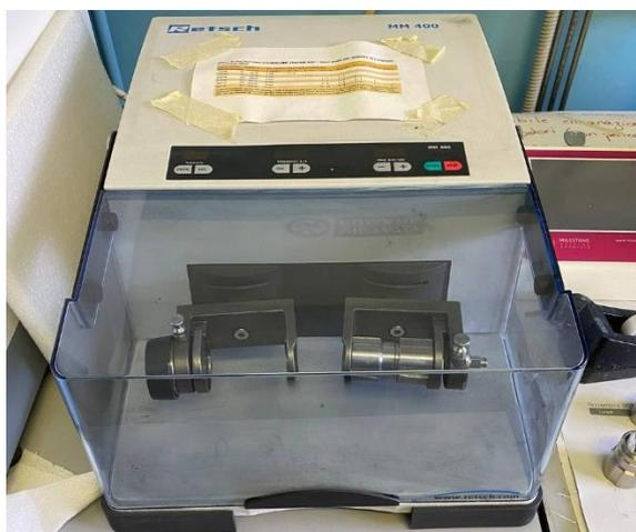
Figura 3.1: Vibromulino Retsch® MM40 utilizzato nel lavoro di tesi.
