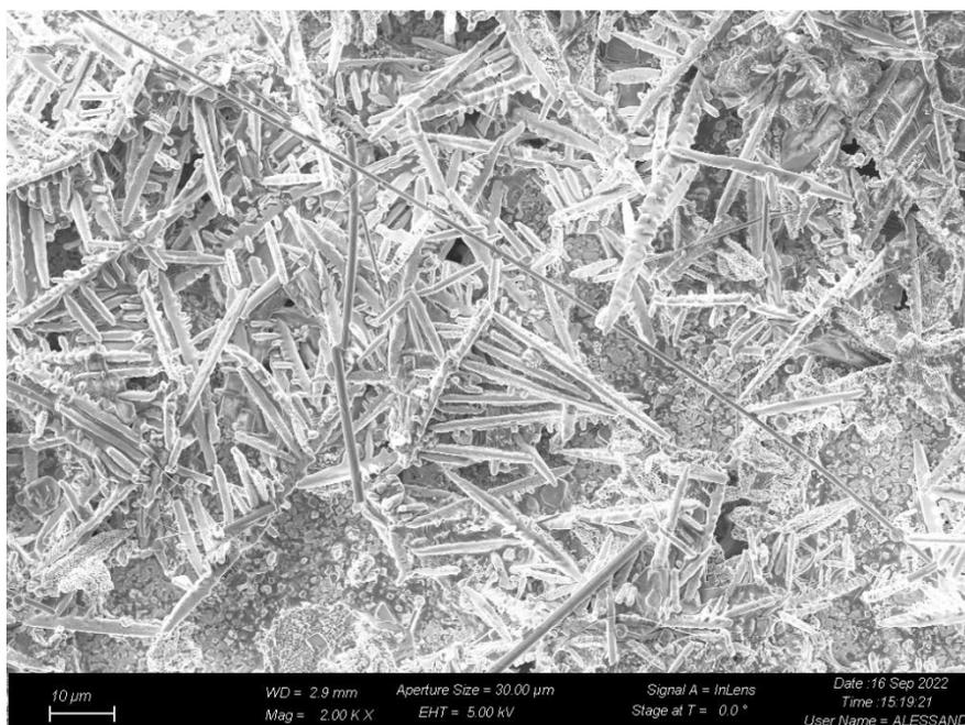
**Figura 4.13:** Immagine FE-SEM a ingrandimento 2000X di una regione dell'anodo di dendriti stagno ciclato nell'intervallo di 0.01-2 V.
