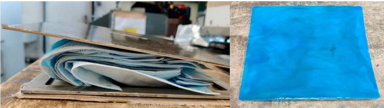
**Figura 2.8:** Disposizione delle mascherine chirurgiche e lastra ottenuta dal ciclo di pressatura
