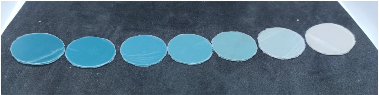
**Figura 3.35:** Provini per reologia dei vari blend prodotti al mini-estrusore.
