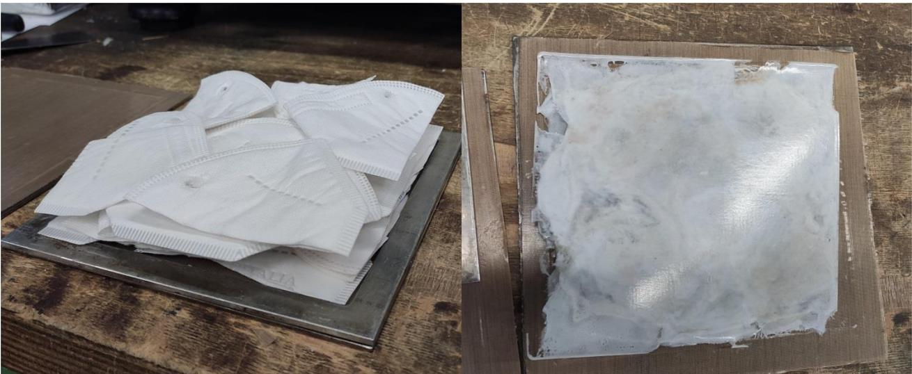
**Figura 2.9.** Disposizione delle mascherine FFP2 e lastra ottenuta dal ciclo di pressatura
