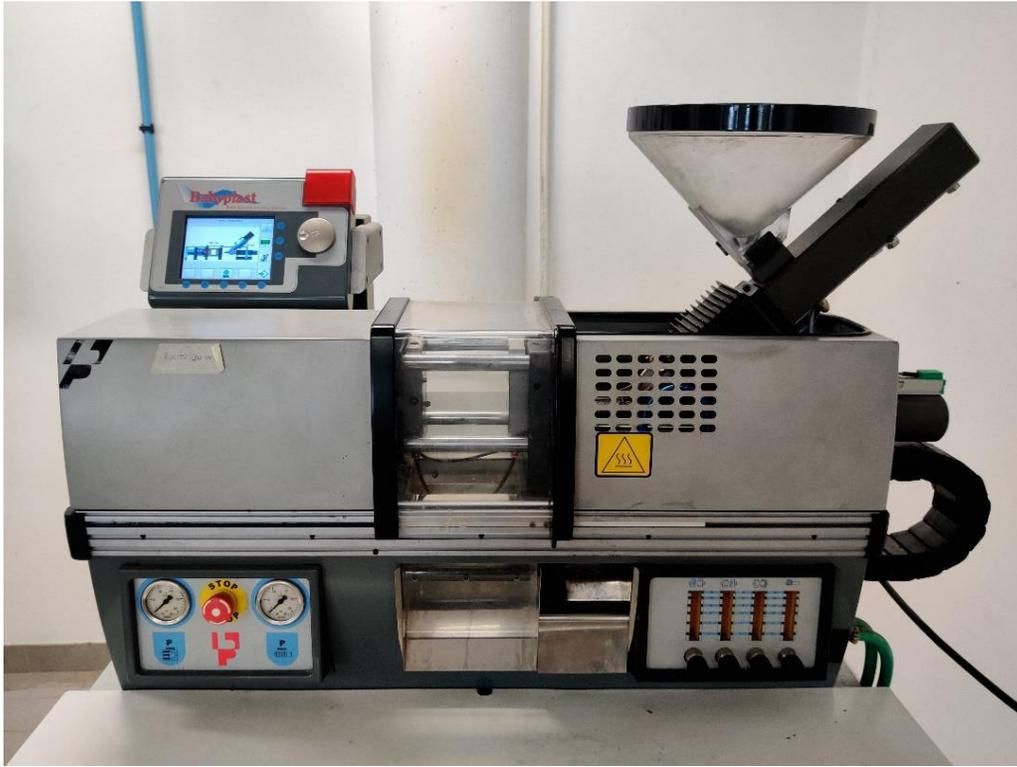
**Figura 2.15:** Stampante a iniezione Babyplast 6/10P
