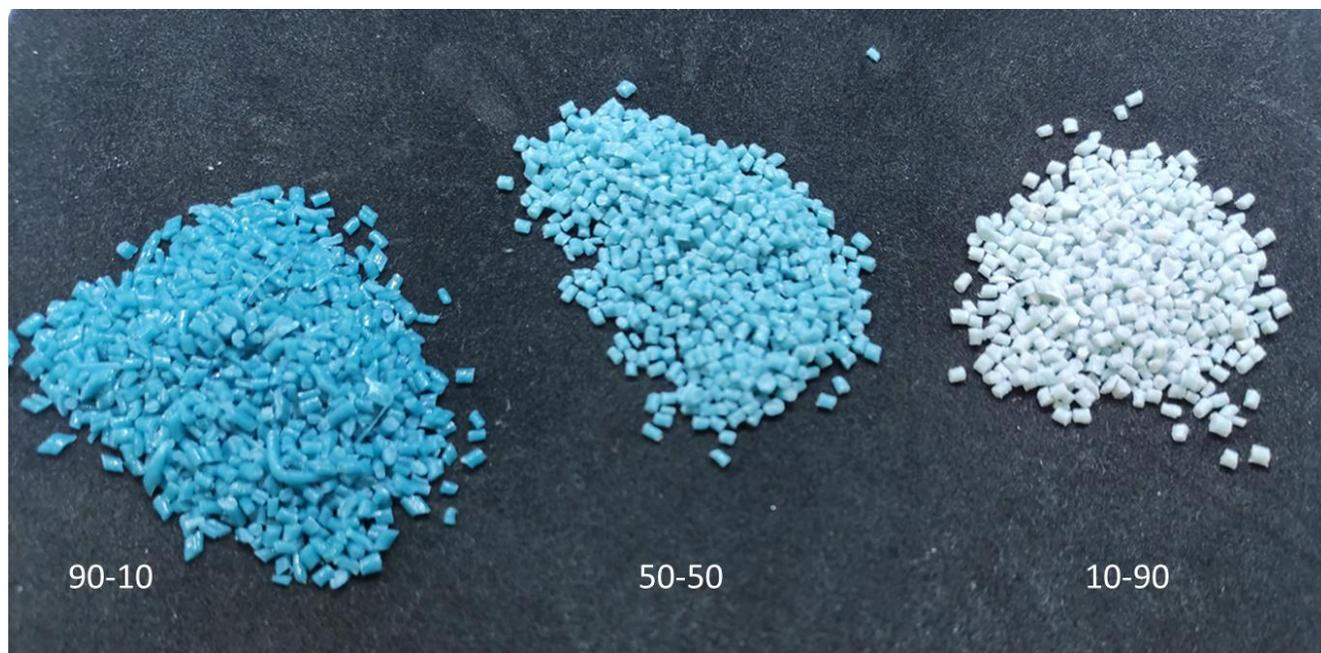
**Figura 3.38:** Pellet prodotti tramite estrusore Termofisher. Da sinistra: 90-10, 50-50 e 10-90.
