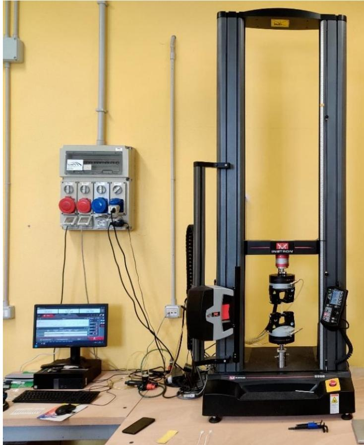
**Figura 2.16:** Dinamometro Instron 5966
