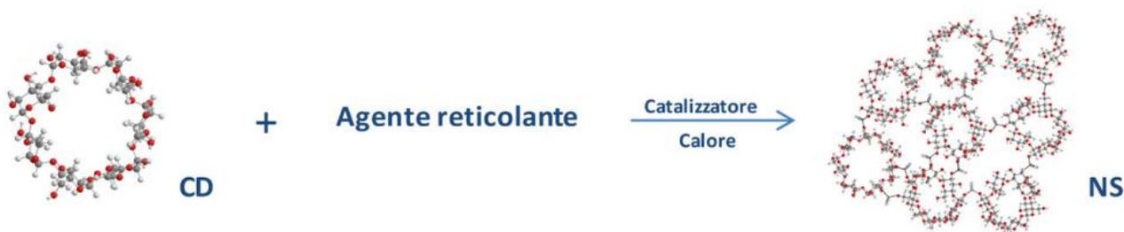
**Figura 9** Reazione di polimerizzazione di una **NS**: sulla sinistra sono presenti i reagenti (molecole di ciclodestrina) insieme ad un opportuno agente reticolante. La presenza di catalizzatore e calore induce l'inizio della reazione di polimerizzazione e l'iper-reticolazione con formazione di una **NS**. [12]
