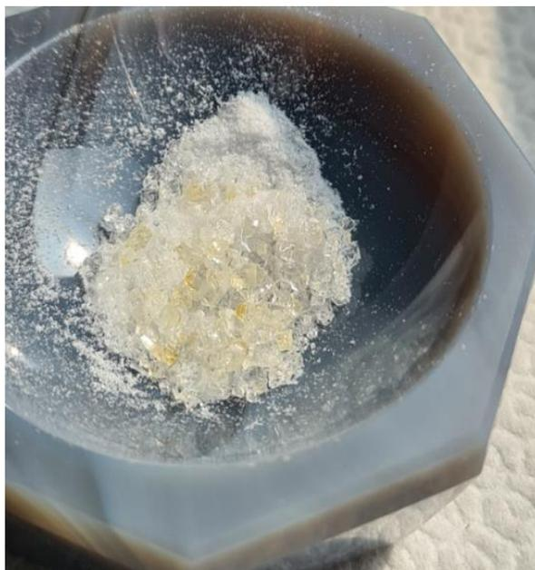
**Figura 56:** Immagine relativa alla sintesi del campione CDS2: la sintesi con una serie di spot bruni viene inserita nel mortaio per essere finemente macinata e successivamente caratterizzata.
