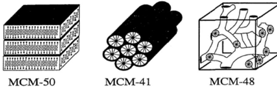
**Figura 25:** Diagramma schematico di un materiale MCM-50 (lamellare), uno MCM-41 (esagonale) ed uno MCM-48 (cubico). [35]
