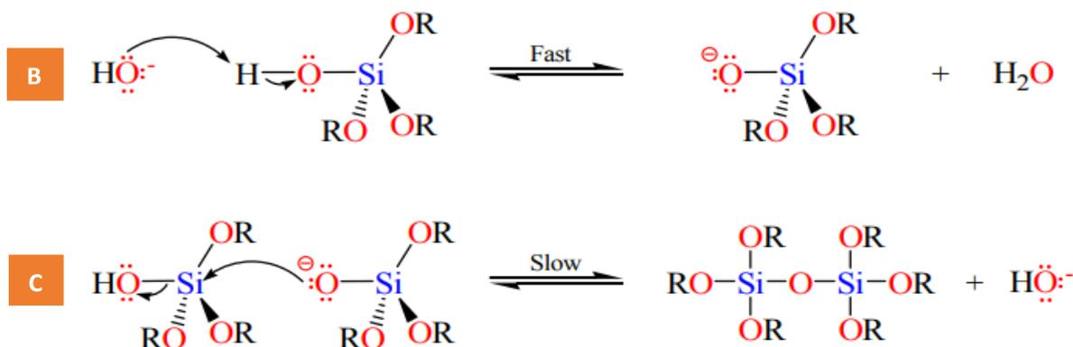
**Figura 32:** Schema di reazione della condensazione in ambiente basico in una reazione sol-gel [43]
