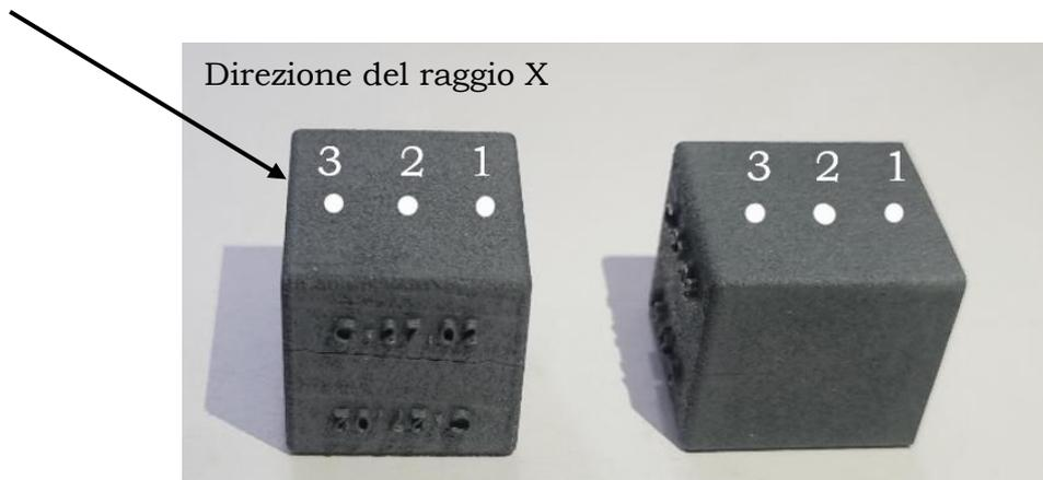
Figura 2.22-Schema per individuare i punti di misura sulla superficie delle varie facce del campione in studio.
