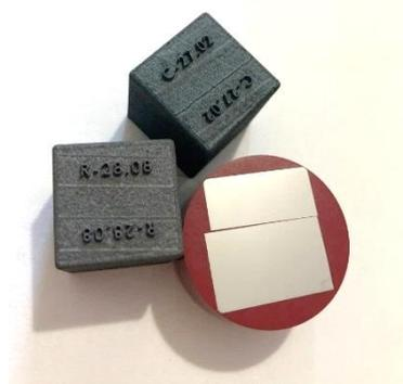
Figura 2.13-Campioni AsBuilt cubici e campione dopo inglobatura e lucidatura (sezione z in basso e xy in alto) per l'analisi di cricche e pori.
