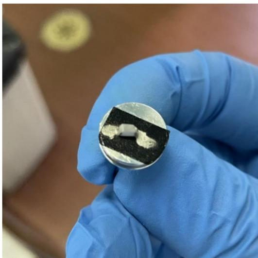
*Figura 3.11 Foto campione SEM montato sul supporto metallico per l'analisi.*
