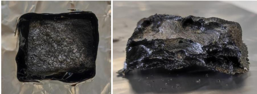
Figura 3.18 - Immagini del residuo della prova al cono eseguita sulla schiuma 4BL
