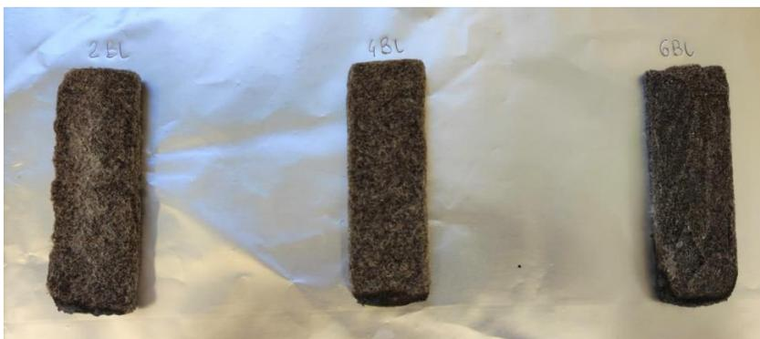
Figura 3.7 – Residui delle schiume Ker(CHpH4-CNF) in seguito al test di infiammabilità in configurazione orizzontale
