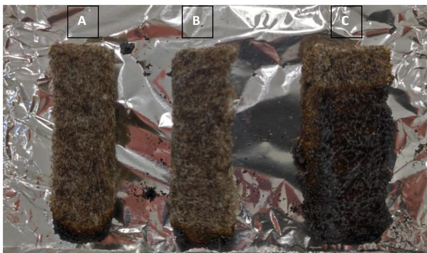
Figura 3.23 – Residui della prova di infiammabilità della schiuma 4BL in configurazione orizzontale (A, B) e verticale (C)
