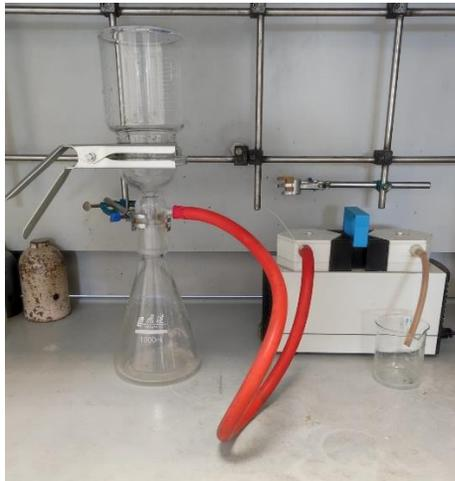
*Figura 2.1 – Sistema utilizzato per filtrare le fibre dopo la deposizione*
