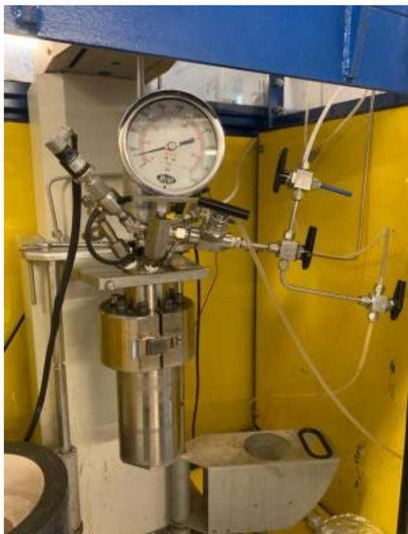
**Figura 19**, immagine reattore utilizzato per le prove di HTL
