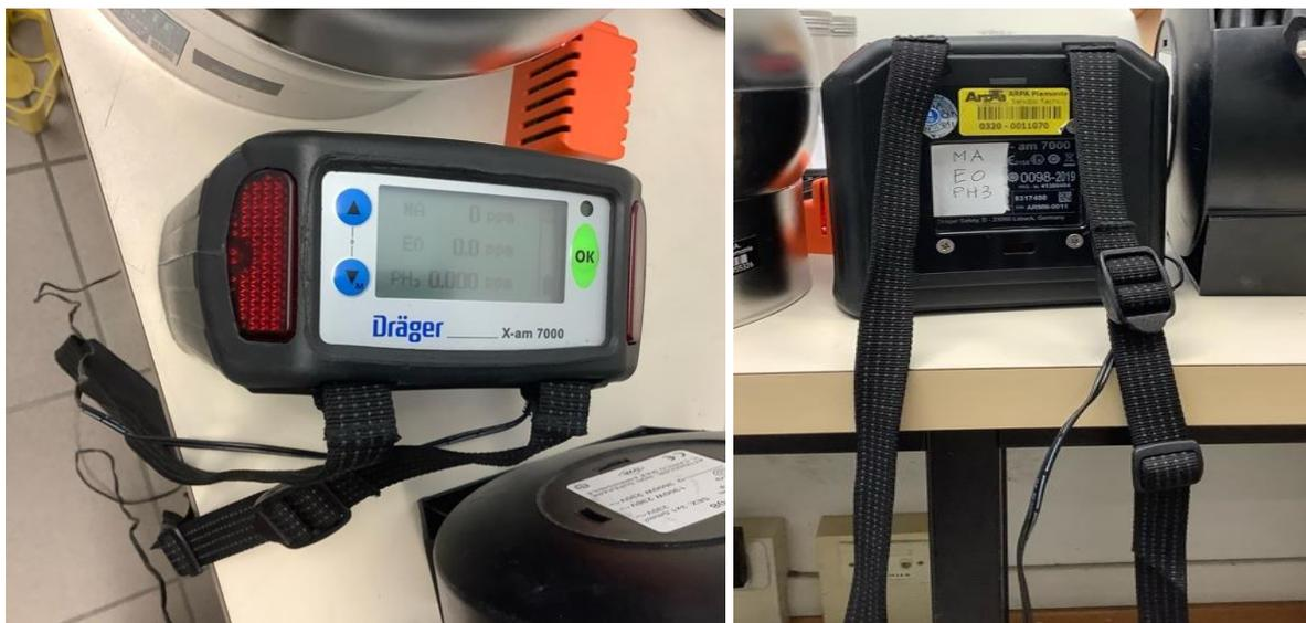
**Figura 3. 2** Vista frontale e laterale del rilevatore multigas Dräger X-am® 7000; dispositivo portatile che permette una misura continua e simultanea di massimo cinque gas, vapori tossici o combustibili, con pompa incorporata.
