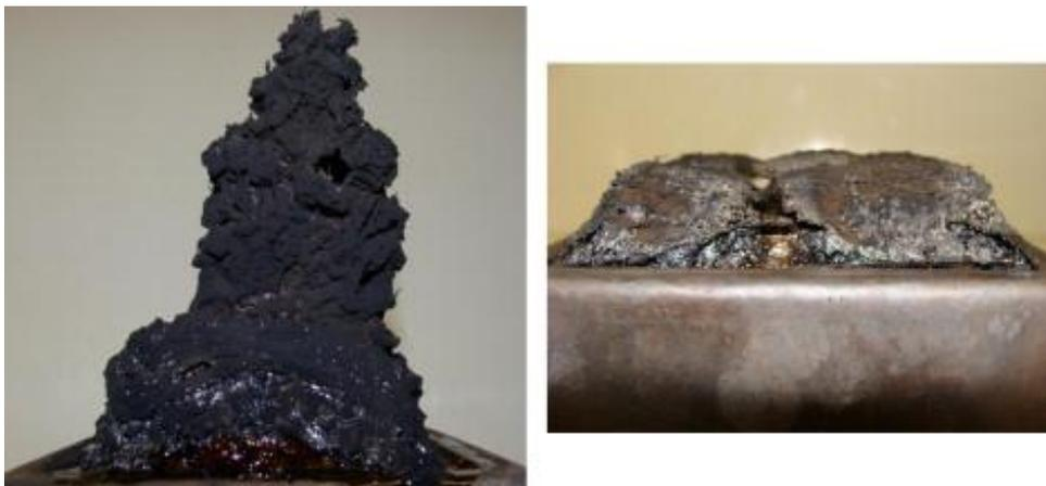
**Figura 4. 4** Esempio di materiali pirolizzanti, formazione del char (Stoliarov et al., 2014)
