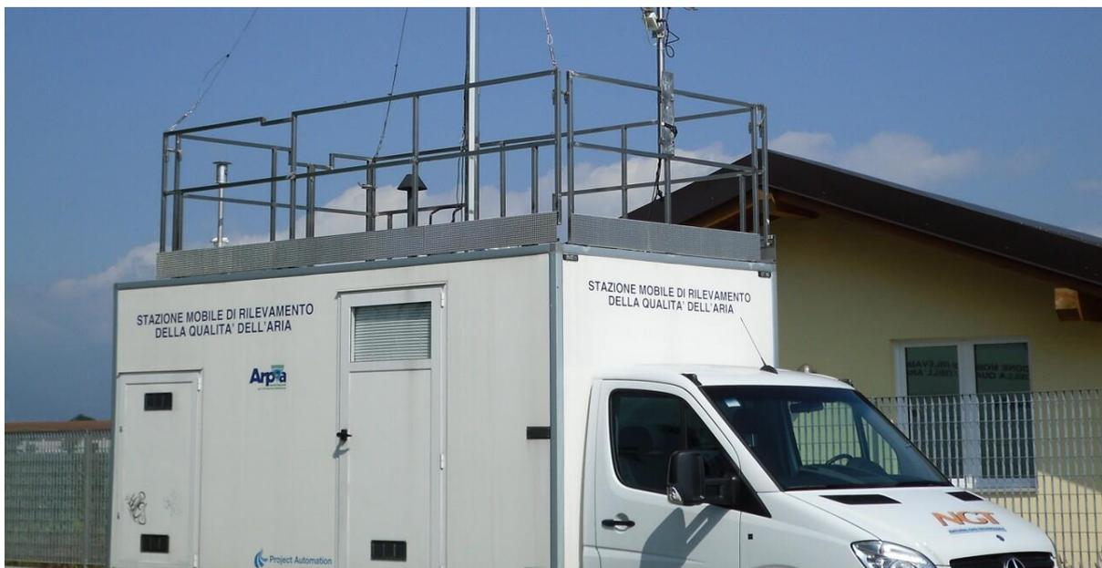
**Figura 3. 7** Piattaforma mobile per il monitoraggio della qualità dell'aria.
