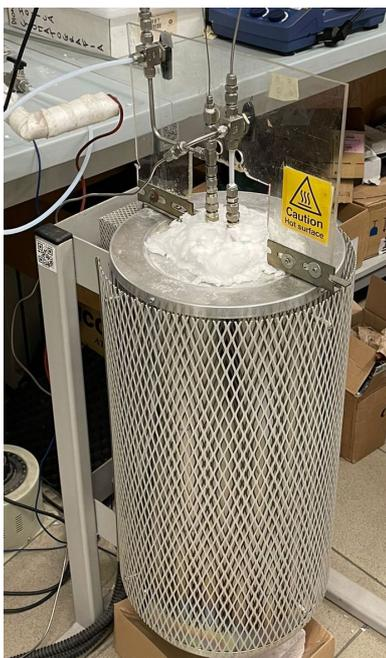
**Figura 3.11:** Scambiatore di calore utilizzato per effettuare i test catalitici sui campioni.
