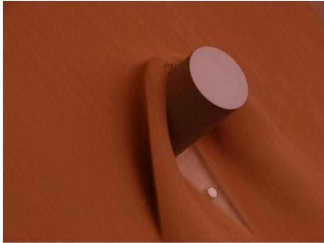
**Figura 2.2:** Visione prospettica dell'onda d'urto, del punto di stagnazione e del vuoto granulare. Il materiale che fluisce è sabbia, l'inclinazione del piano è di  $\theta = 36^\circ$  e il numero di Froude appena a monte dell'onda d'urto è circa 6. [Cui and Gray, 2013]
