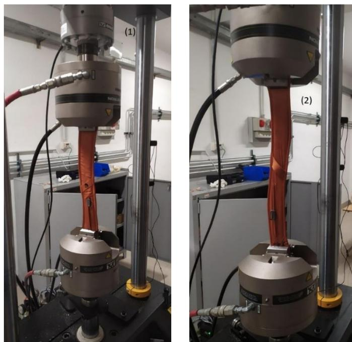
*Figura 47: Test a trazione sperimentale: (1) spallaccio scarico: geometria iniziale (2) spallaccio in tensione con raddrizzamento della geometria curva iniziale*
