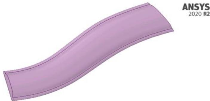
Figura 39: Geometria tagliata spallaccio utilizzata per il test di trazione
