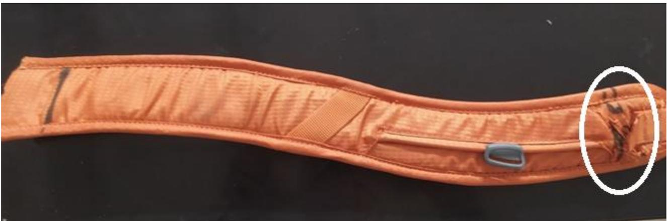
*Figura 46: Zona di rottura del campione 1 dello spallaccio durante il test di trazione*
