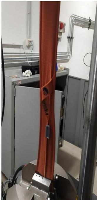
*Figura 48: Fine prova di trazione con rottura tessuto con taglio a 45°*
