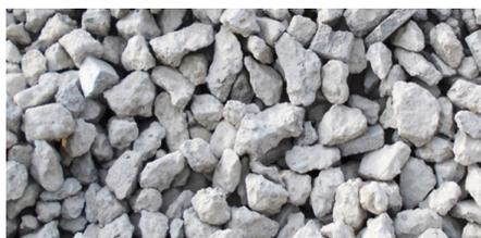
aggregato riciclato ( $\varnothing$  5/15 mm), cioè un aggregato ottenuto dal recupero di materiali precedentemente utilizzati in altre costruzioni: questa tipologia di aggregato contiene frammenti di calcestruzzo, di
