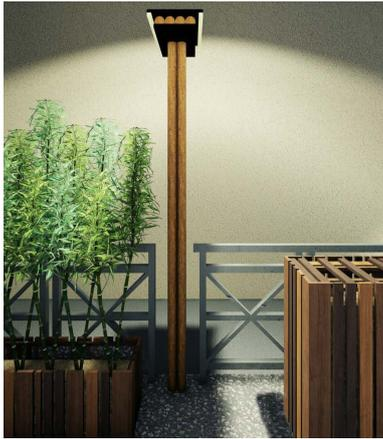
I lampioni in questione, necessari per l'illuminazione del marciapiede, sono costituiti da fasci di due canne di bambù legati tra loro, al di sopra dei quali sono disposti fasci di quattro canne di bambù in direzione ortogonale, poggianti su un supporto costituito da un tavolato in legno. I fasci sono realizzati mediante l'utilizzo di fascette metalliche. Al di sopra, un pannello fotovoltaico utile ad alimentare il lampione
