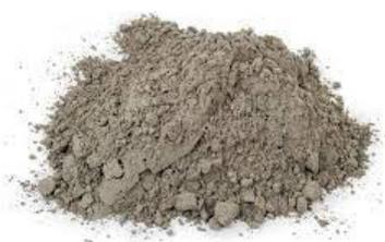
CEM III/B 32,5 R, cioè un cemento d'altoforno in cui vi è una concentrazione di loppa basica d'altoforno compresa tra il 66 e l'80%<sup>[93]</sup>. Sviluppa una resistenza a compressione > 17 MPa dopo 2 giorni ed una
