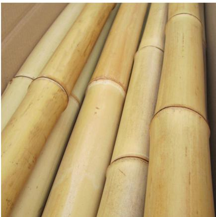
In seguito alle considerazioni elaborate nel corso del presente studio, il materiale selezionato per la realizzazione della struttura portante modulare è il bambù. Si tratta di una pianta sempreverde denominata “acciaio vegetale”<sup>[80]</sup>, grazie alle sue caratteristiche di forza e resistenza, nonostante sia flessibile e molto leggero rispetto ad altri materiali. L’elevato tasso di
