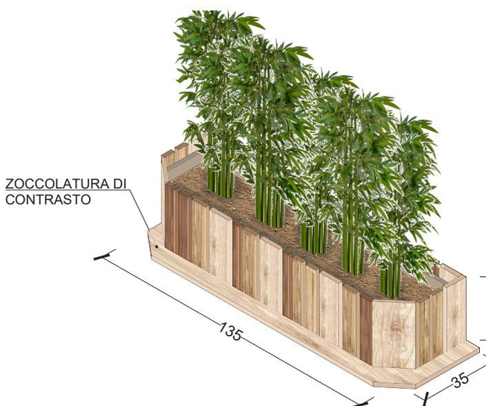
Inoltre, saranno disposte delle fioriere, in cui vengono coltivate specie di bambù che non raggiungono altezze eccessive. Tali elementi saranno realizzati con doghe di legno e rivestiti internamente da una membrana per evitare che la terra di
