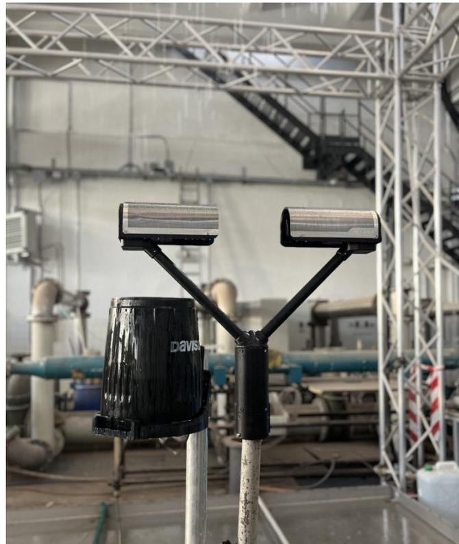
**Figura 4.2:** Disdrometro utilizzato nel simulatore di pioggia
