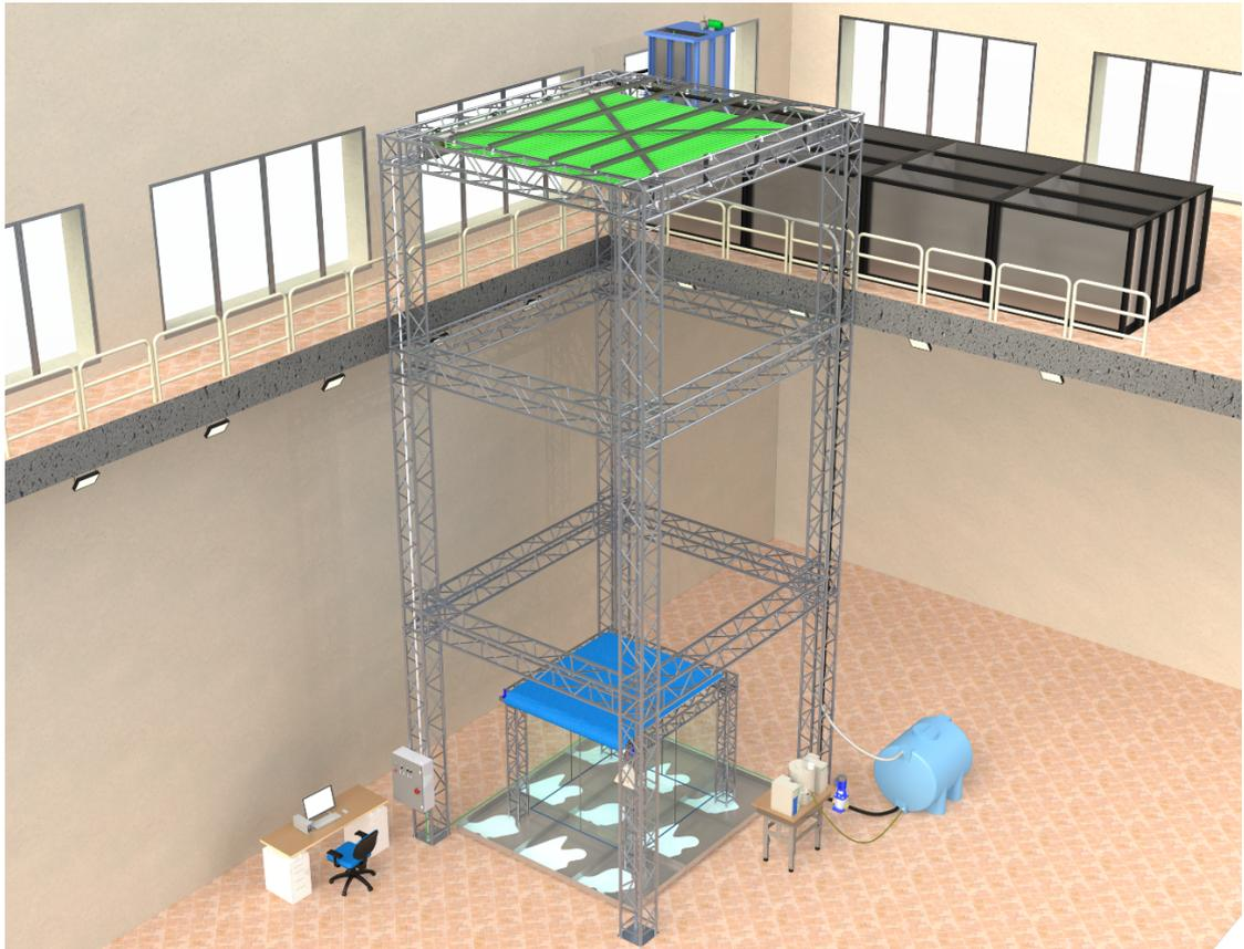
**Figura 5.10:** Sistema completo per la simulazione del fenomeno di deposizione
