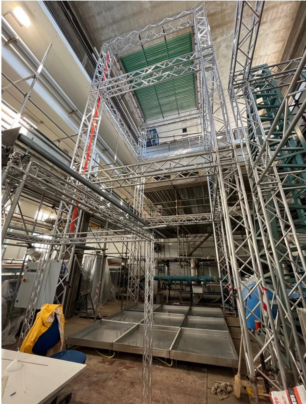
**Figura 5.5:** Foto del simulatore di pioggia nel laboratorio del Politecnico di Torino
