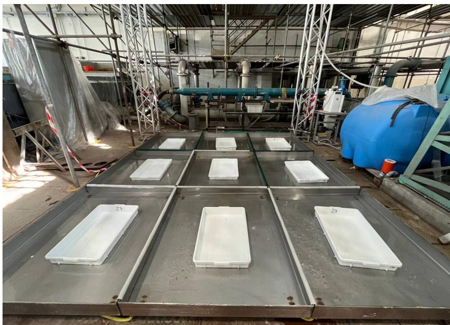
**Figura 4.3:** Vasche per determinare l'intensità distribuite nell'area di interesse del simulatore di pioggia
