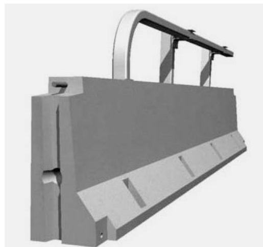
Figura 2.9 Barriere miste acciaio-calcestruzzo
