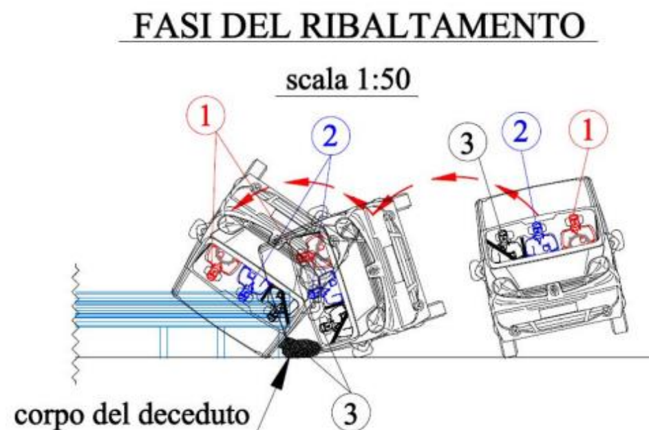
Figura 4.6: Schema rappresentativo della fase di ribaltamento del furgone e posizione degli occupanti
