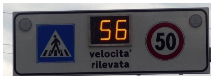
Figura 3.26: Dissuasore con misuratore di velocità
