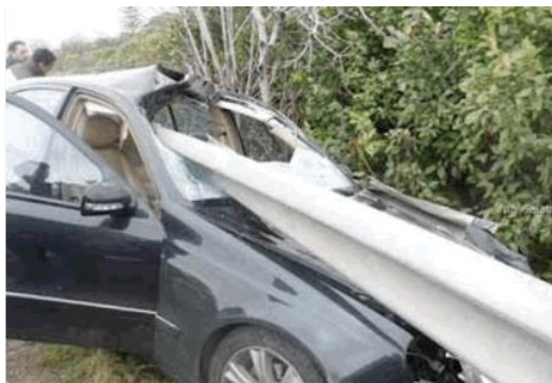
Figura 2.1: Terminale non correttamente progettato
