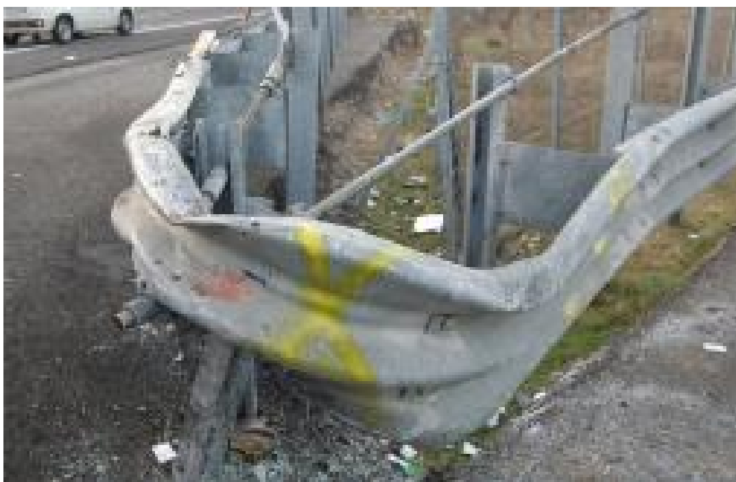
Figura 4.5: cuspid a seguito dell'impatto
