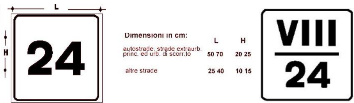
Figura 5.8: Segnale di progressiva distanziometrica con annesse dimensioni
