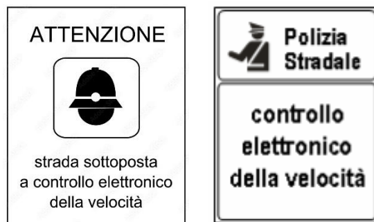
Figura 3.25: Cartelli di preavviso per controllo elettronico della velocità
