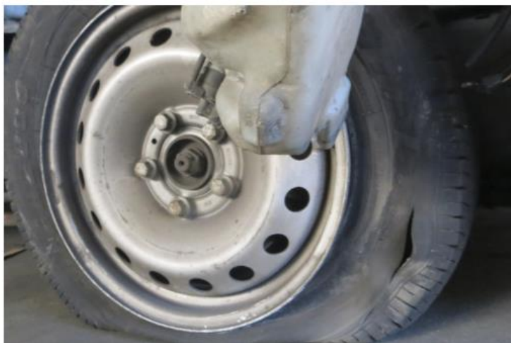
Figura 4.8: Pneumatico anteriore destro squarciato
