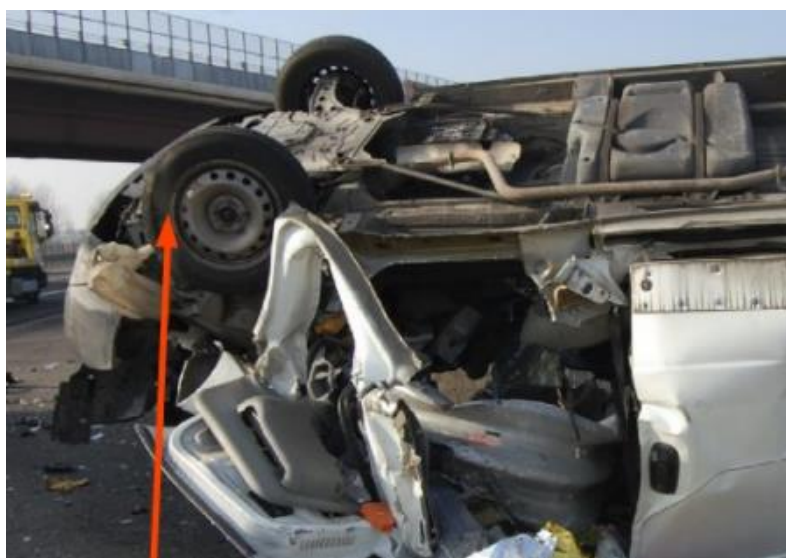
Figura 4.9: Posizione finale del veicolo ribaltato con messa in risalto dello pneumatico lacerato.
