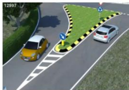
Figura 3.22 : isola di traffico rialzata
