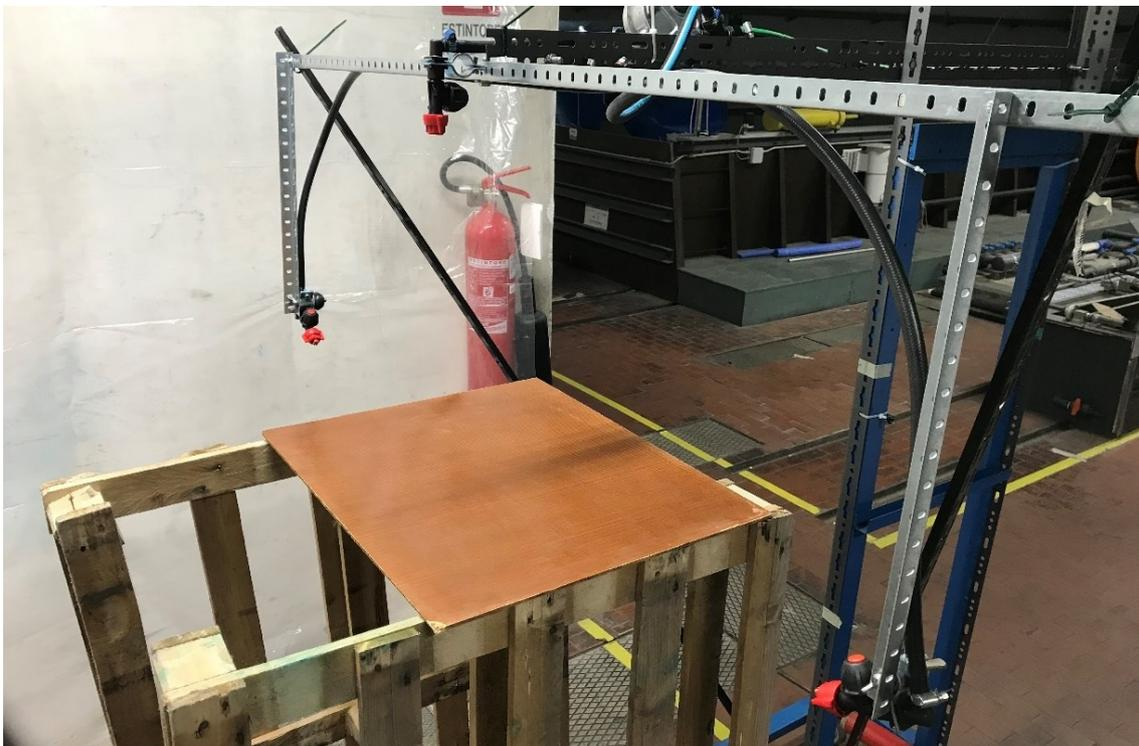
Figura 6.1 – Banco prova con struttura a tre ugelli e simulatore di vigneto
