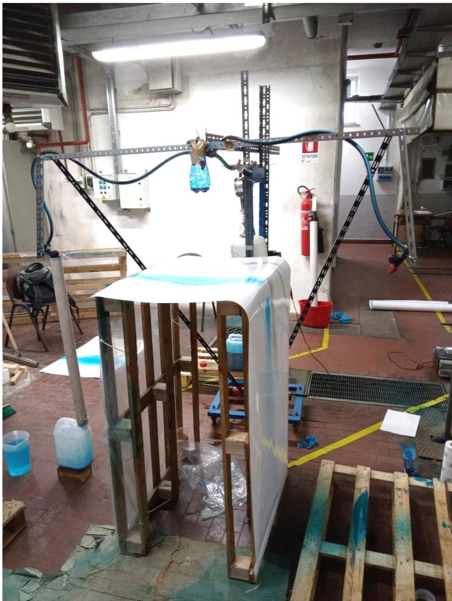
Figura 9.2 - Prove con tre ugelli su simulatore di vigneto alimentate da vaso di espansione, esecuzione di una prova
