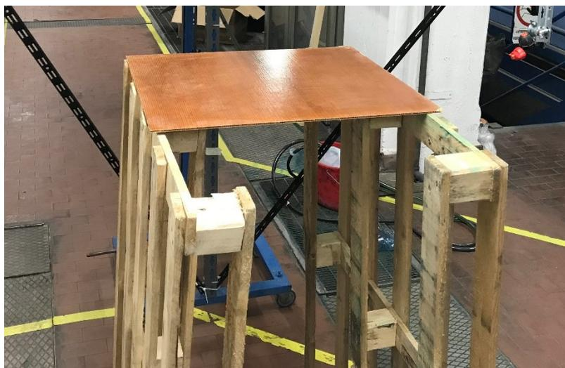
Figura 2.8 – Struttura in legno del simulatore di vigneto.
