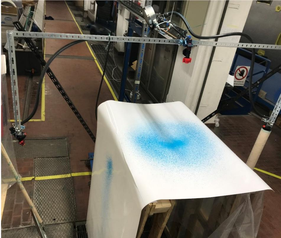
Figura 1.2 – Esecuzione di una prova di spruzzatura su carta per lo studio del sistema di irrorazione.
