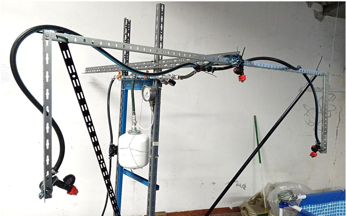
Figura 9.1 – Prove con tre ugelli su simulatore di vigneto alimentate da vaso di espansione, banco prova
