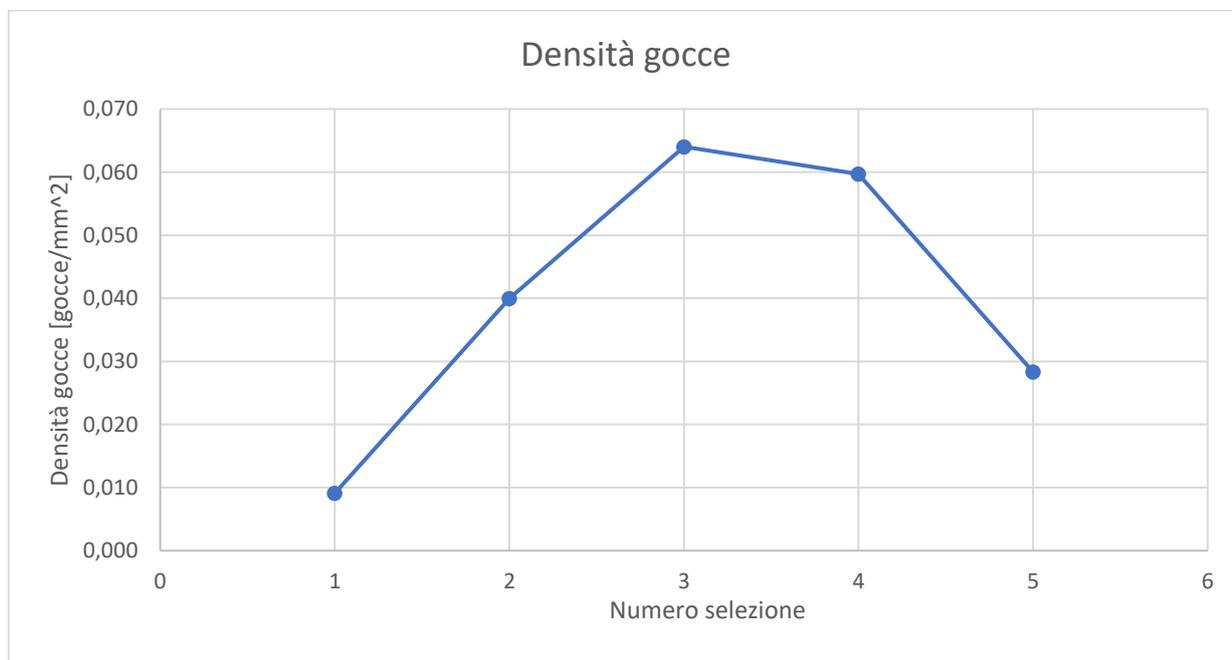
Figura 5.7 - Prova con ugello HCA8001 con angolo di 90° rispetto al foglio, andamenti densità di gocce
