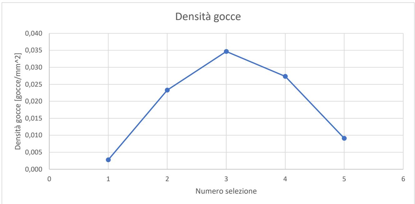
Figura 5.11 - Prova con ugello HCA8001 con angolo di 45° rispetto al foglio, andamento densità gocce
