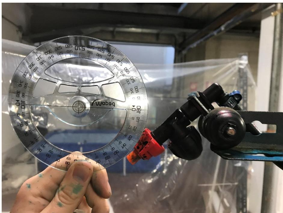
Figura 2.6 – Regolazione dell'angolo di inclinazione dell'ugello, grazie al porta-ugello
