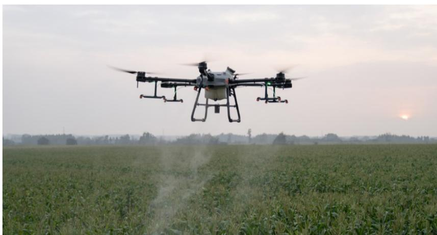
Figura 0.1 – Drone agricolo per l’irrorazione di fitofarmaci. Fonte: <https://www.eliteconsulting.it/fatti-sorprendenti-sulla-spruzzatura-dei-droni/>
