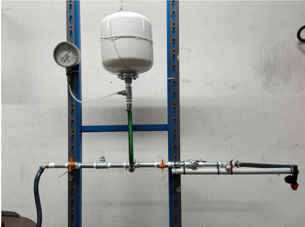
Figura 8.5 – Circuito prova serbatoio anti-sloshing con un ugello
