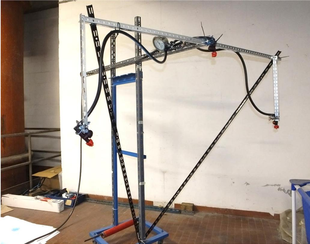
Figura 6.4 – Struttura porta ugelli
