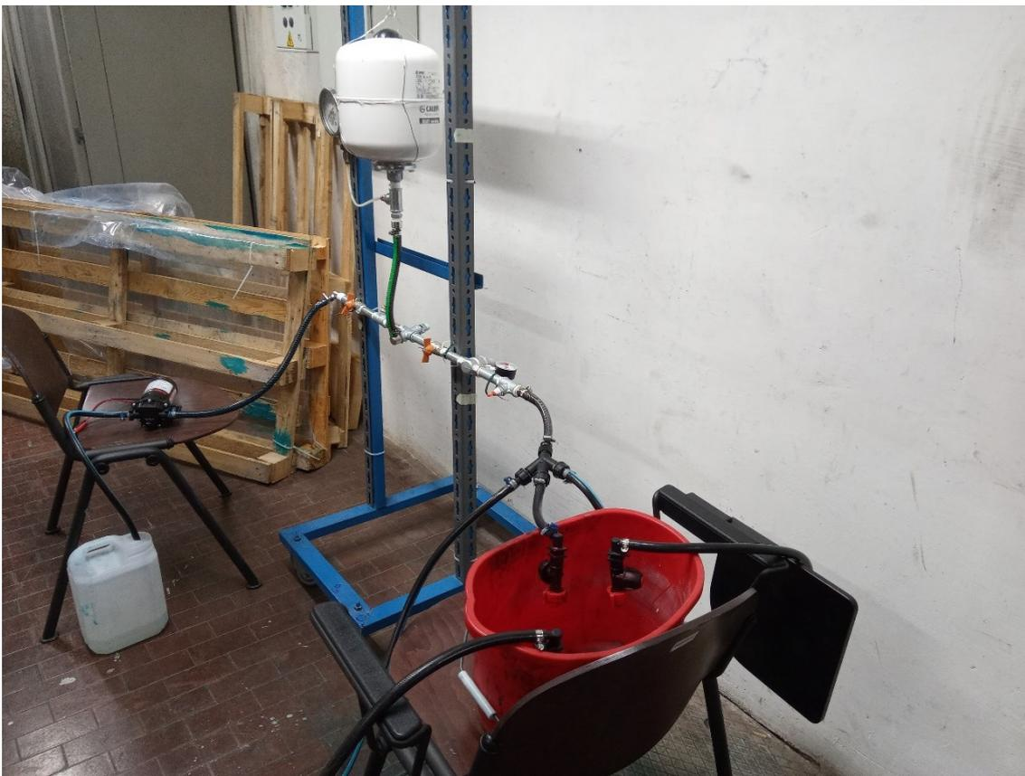
*Figura 8.8 – Circuito prova serbatoio anti-sloshing con tre ugelli*
