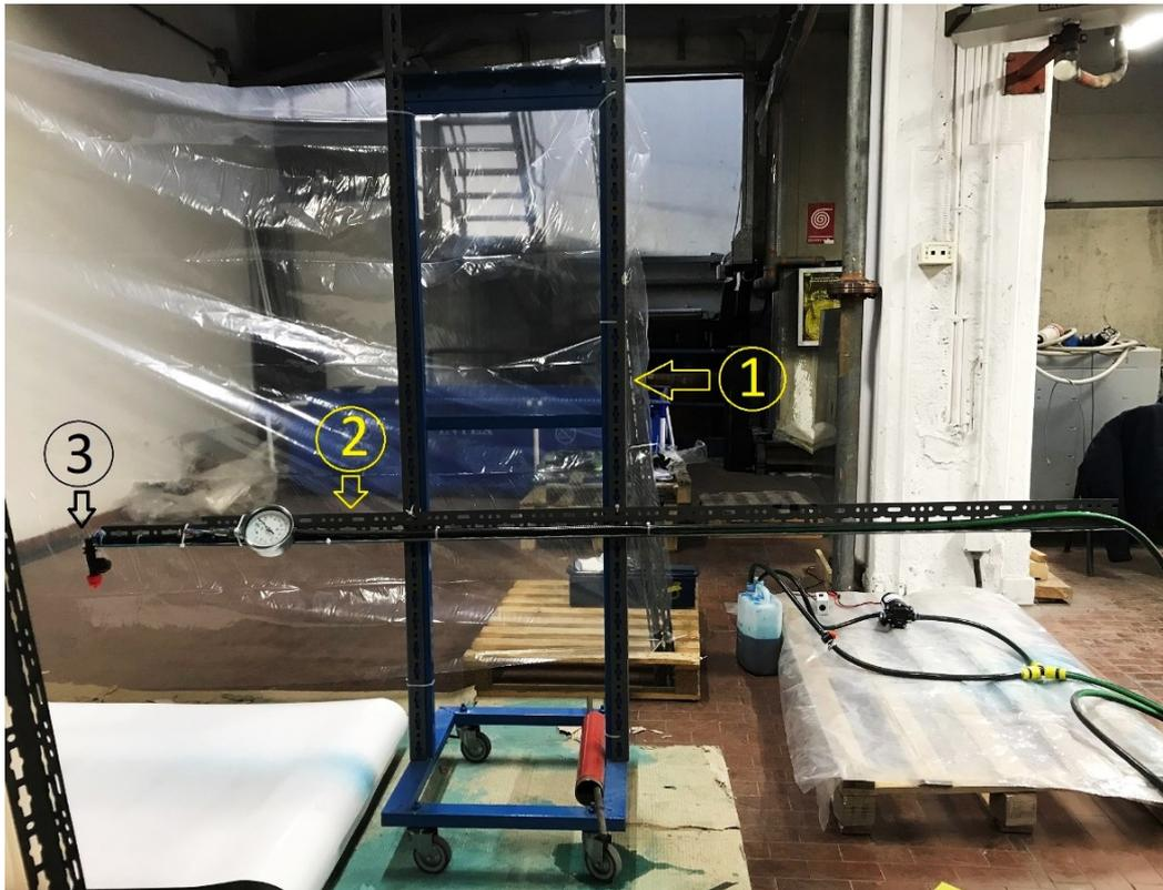
Figura 2.4 – Struttura porta ugelli, singolo ugello
