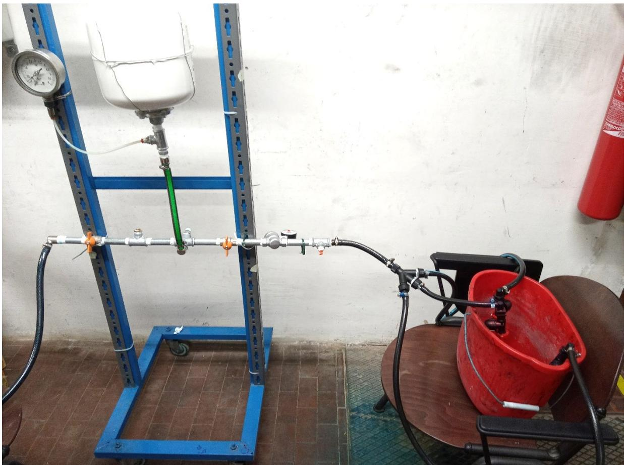
Figura 1.5 – Circuito utilizzato per le prove su serbatoio anti-sloshing.
