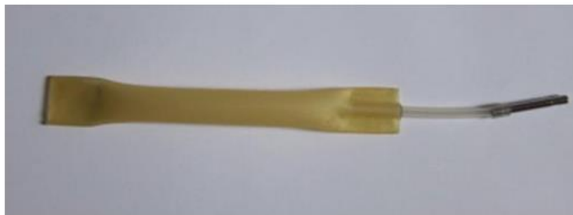
FIGURA 2.1.1) Camera elastomerica in lattice e tubo di alimentazione realizzato dalla Dottoressa Sirolli [43]
