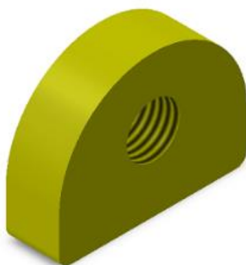
FIGURA 1.1.2.31) Tappo di chiusura anteriore con foro filettato
