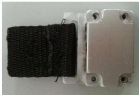
FIGURA 2.1.2) Testata di chiusura vista dall'alto e fettuccina per cucitura del muscolo pneumatico sul guanto realizzato dalla Dottoressa Sirolli [43]
