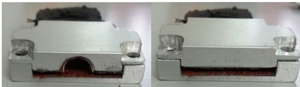
FIGURA 2.1.3) A sinistra la testata di chiusura per l'estremità con tubo di alimentazione. A destra la testata di chiusura dell'altra estremità [43]
