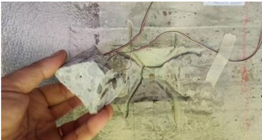
**Figura 4.3:** Prova di rilascio tensionale su calcestruzzo mediante provino tronco piramidale
