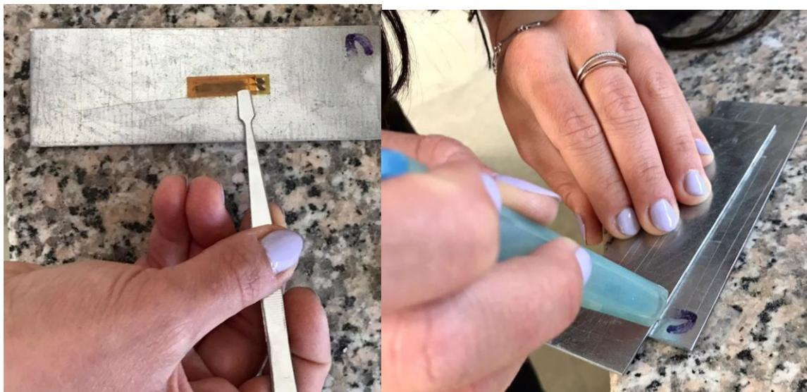
**Figure 4.9:** Procedura di applicazione estensimetri
