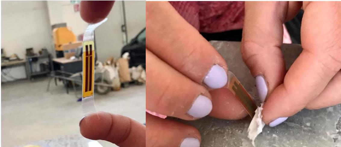
**Figure 4.10** : Procedura di applicazione estensimetri
