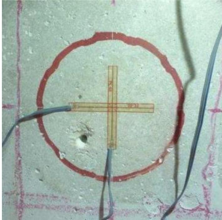
**Figura 4.2:** Prova di rilascio tensionale su calcestruzzo mediante carota circolare
