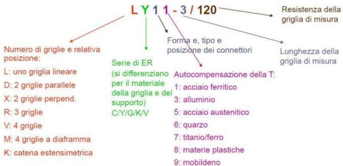
**Figura 5.4:** Numero di serie estensimetri a resistenza
