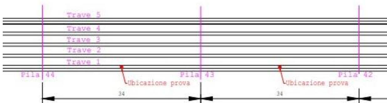
**Figura 4.25:** Pianta del ponte con relative posizioni delle prove
