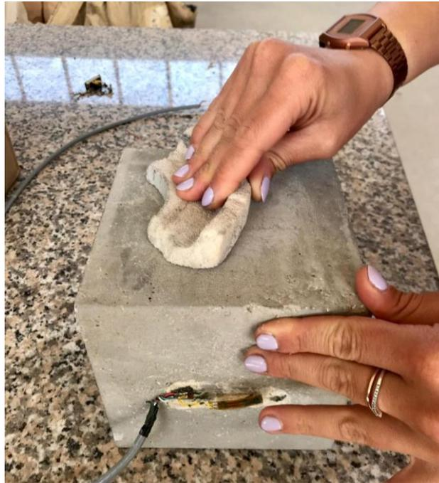
**Figura 4.4 :** Procedura di applicazione estensimetri
