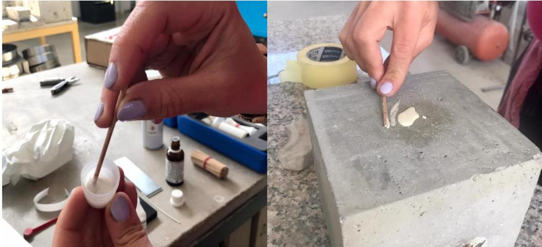
**Figure 4.6 :** Procedura di applicazione estensimetri
