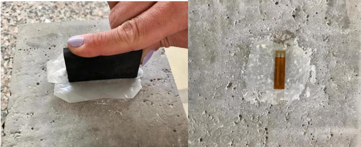
**Figure 4.12** : Procedura di applicazione estensimetri
