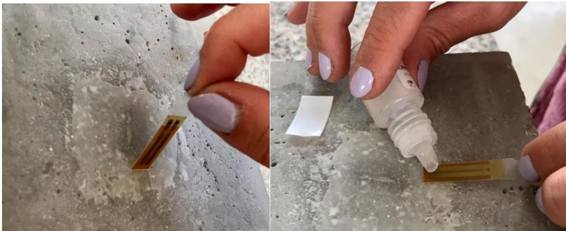
**Figure 4.11** : Procedura di applicazione estensimetri
