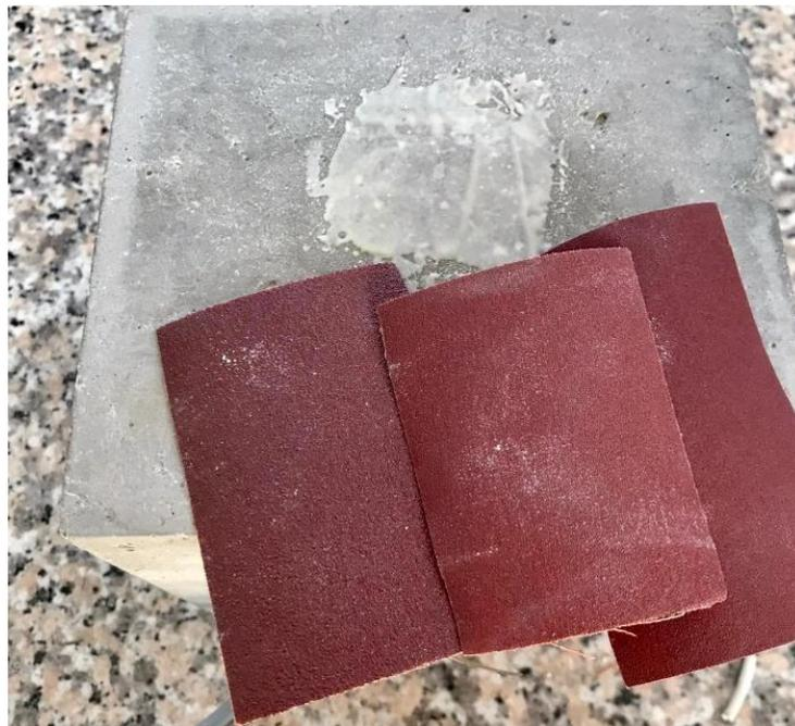
**Figura 4.7 :** Procedura di applicazione estensimetri
