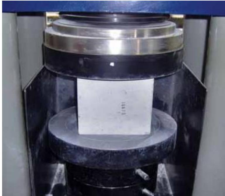
*Figura 19 - Rottura a compressione di un provino cubico 15x15x15 cm*
