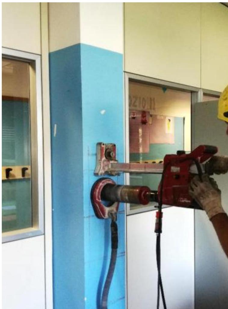
*Figura 36 - Esecuzione dei carotaggi meccanici per il prelievo del campione di calcestruzzo*
