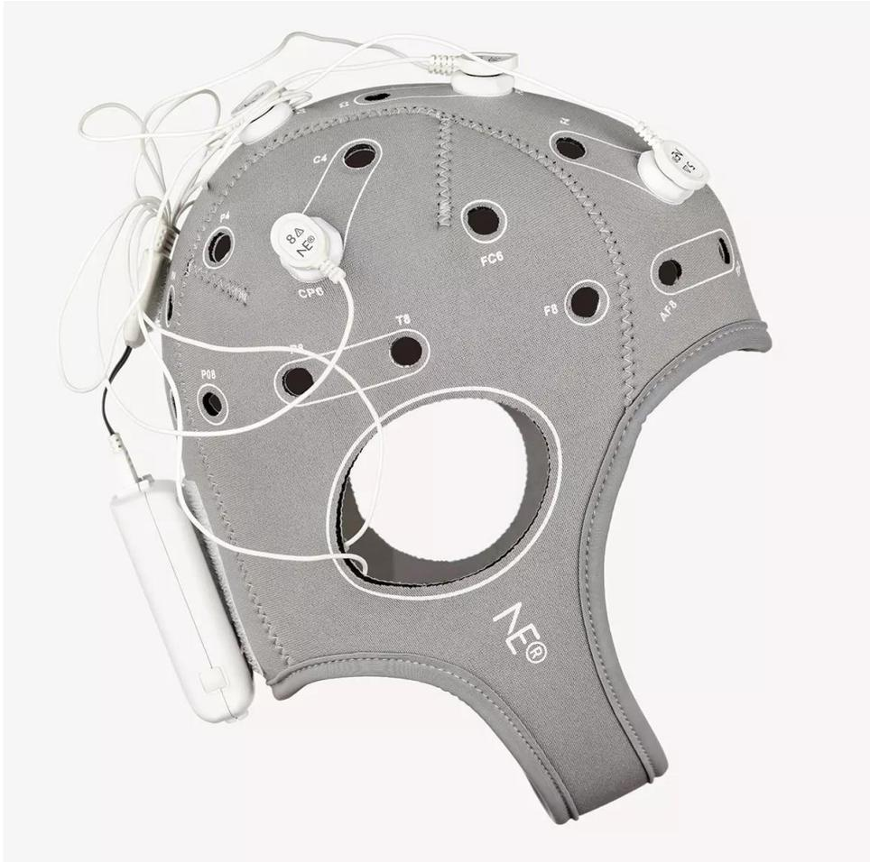
*Figura 10. Esempio di cuffia predisposta per il montaggio rapido degli elettrodi per registrazione EEG basata sul sistema 10-20. In questo caso si tratta della cuffia fornita con il sistema di registrazione Enobio 8 di Neuroelectronics [64].*
