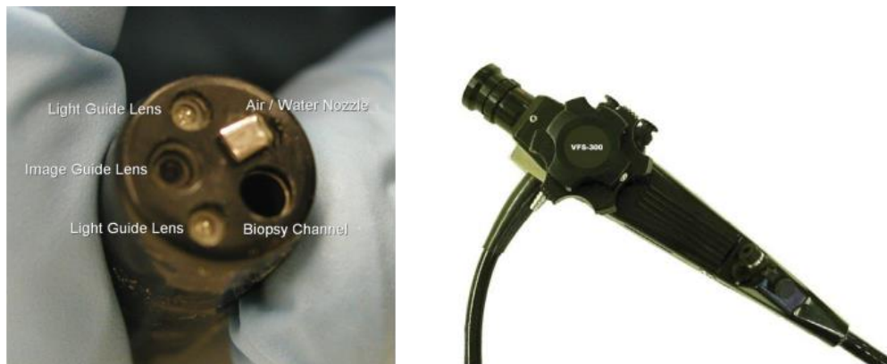
Figura 2 (a) Particolare della punta e (b) Particolare delle rotelle
