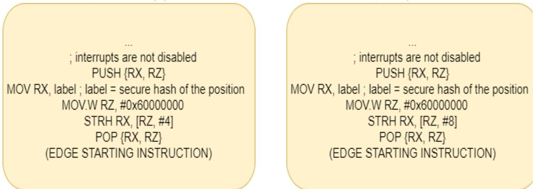
(c) ARM-FPGA instrumentation for type 5). (d) ARM-FPGA instrumentation for type 7).
