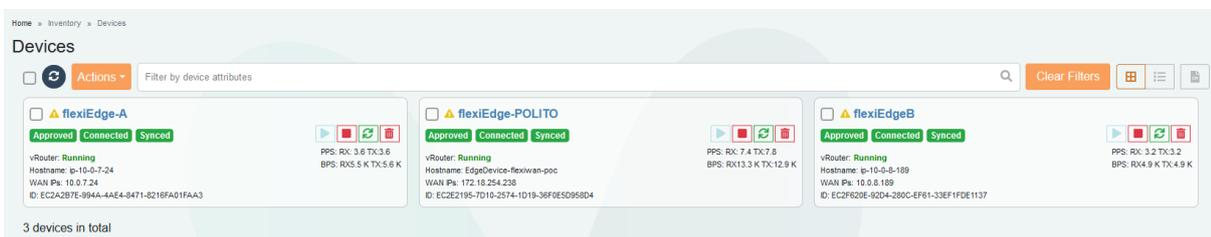
A questo punto, si procede ad abilitare le interfacce del dispositivo, che avranno assegnati automaticamente gli indirizzi IP delle corrispondenti *network interface* su AWS precedentemente definite (compreso l'indirizzo IP pubblico):
