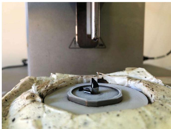
*Figura 37. Esempio di provino portato a rottura: si nota il disco in polistirolo che circonda il sistema di misura*
