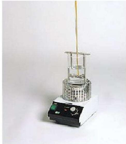
Figura 19. Prova di rammollimento (Corso di costruzioni di strade, ferrovie e aeroporti, slide corso)
