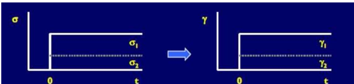
Figura 4. Andamenti di tensione e corrispondente deformazione espresse in funzione del tempo per materiale elastico (Corso di costruzioni di strade, ferrovie e aeroporti slide corso)
