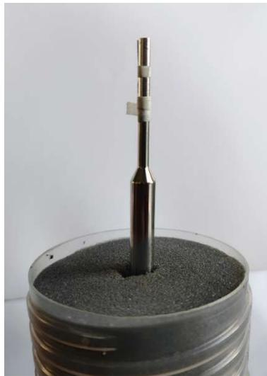
*Figura 38. Preparazione provino: cassero in alluminio*
