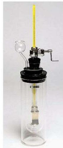
Figura 20. Prova Frass (Corso di costruzioni di strade, ferrovie e aeroporti, slide corso)
