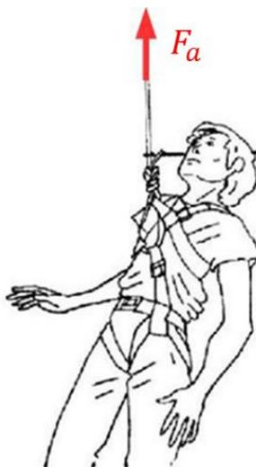
*Figura 1-11 applicazione della forza d'arresto*
