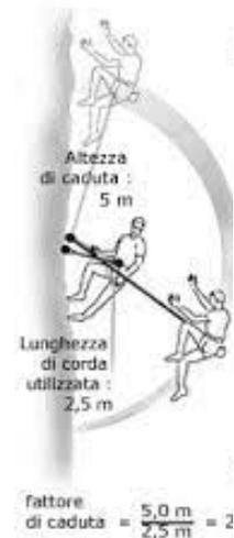
*Figura 1-15* fattore di caduta pari a 2
