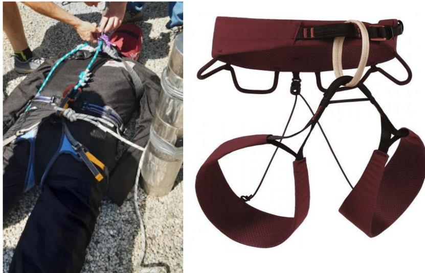
*Figura 5-2 A sinistra il manichino delle prove sperimentali e a destra la tipologia di imbrago usato*
