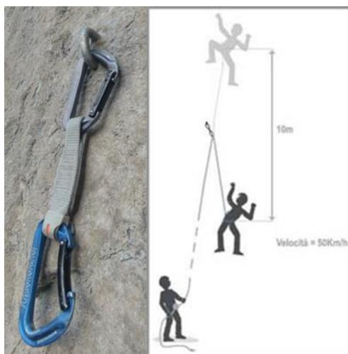
*Figura 1-9 a sinistra un rinvio e a destra uno schema di una caduta*
