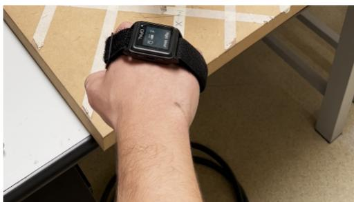
Figura 4.2: Posizione del sensore inerziale durante il telecontrollo.
