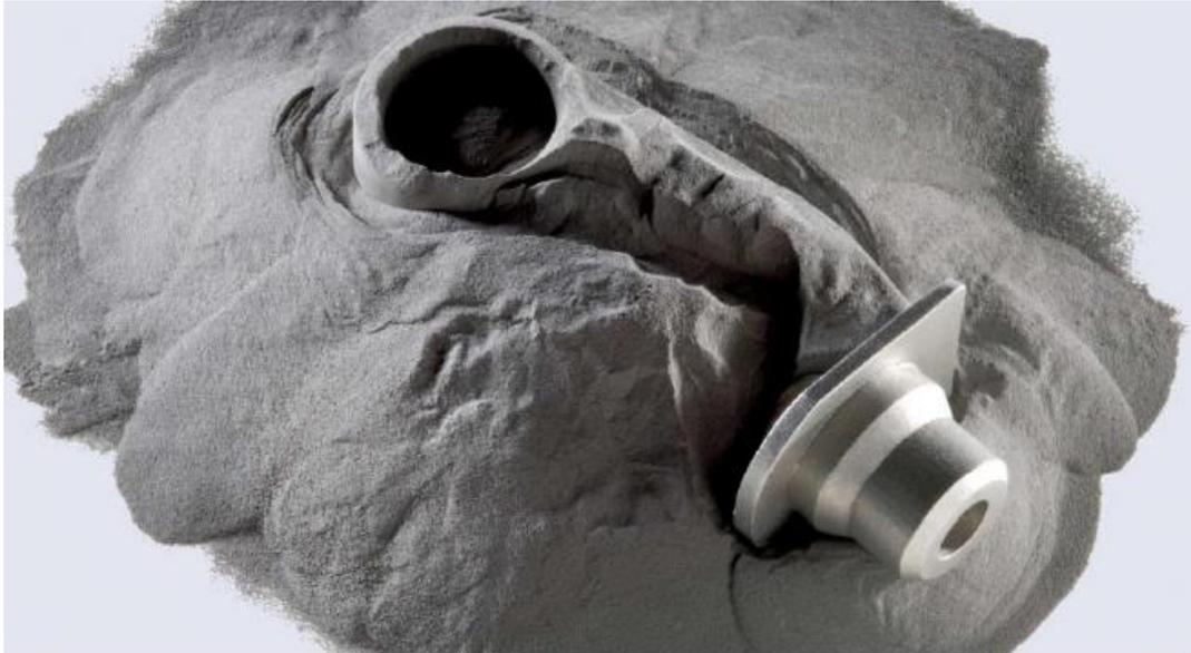
Figura 5: estrazione job e rimozione eccesso polvere
