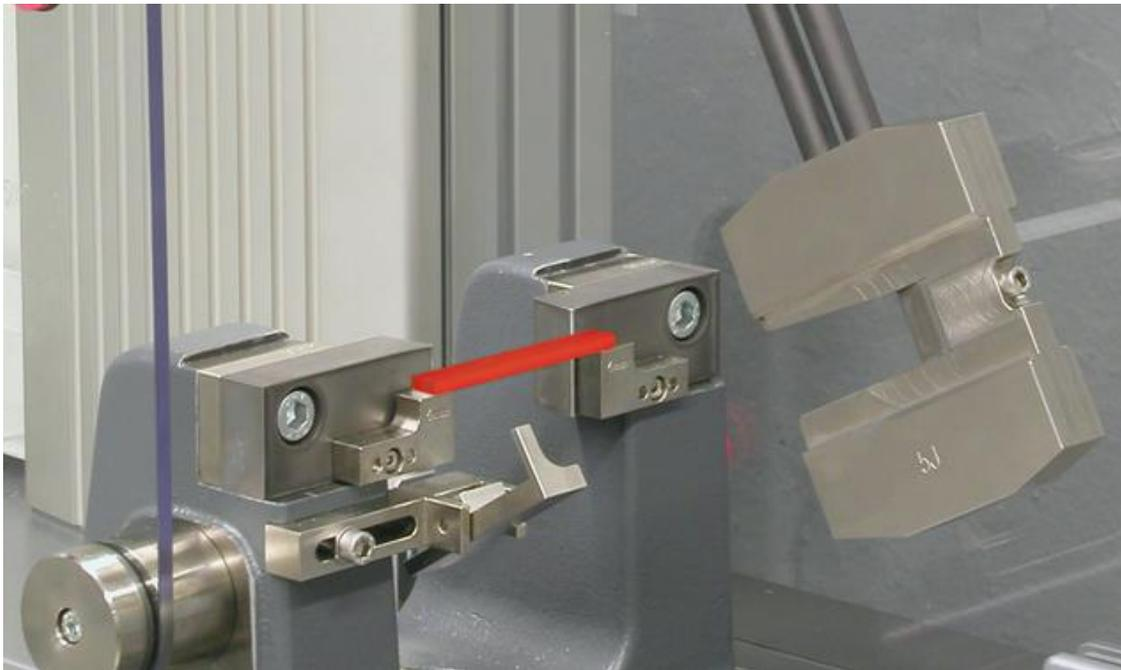
Figura 98: prova di Charpy
