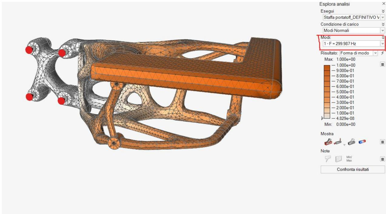
Figura 51: frequenza risonanza nuova geometria, AlSi10Mg
