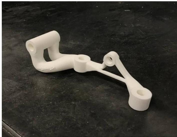
Figura 17: prototipo funzionale realizzato tramite SLS, materiale: PA 12
