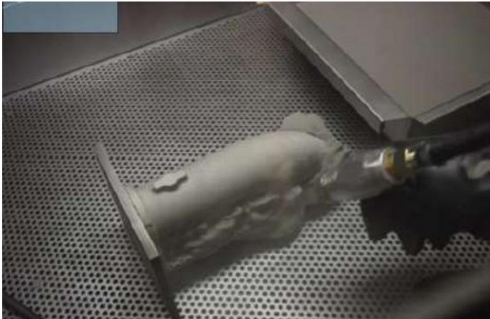
Figura 9: processo di sabbiatura
