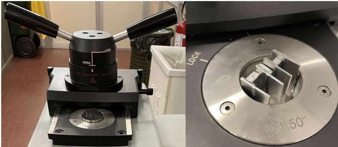
*Figura 34 Operazioni di inglobatura*
