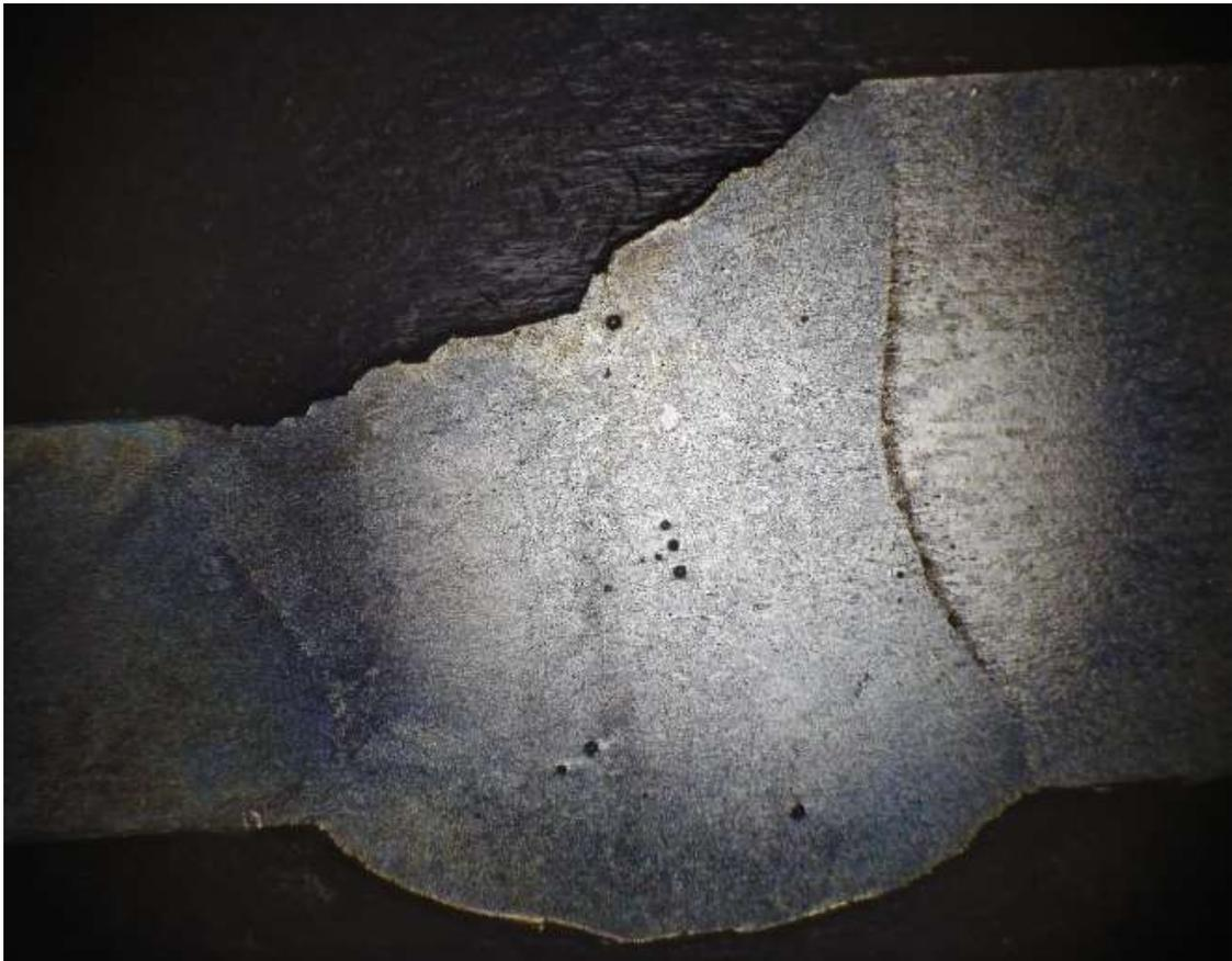
*Figura 39 Metallografia del cordone di saldatura dopo attacco acido*
