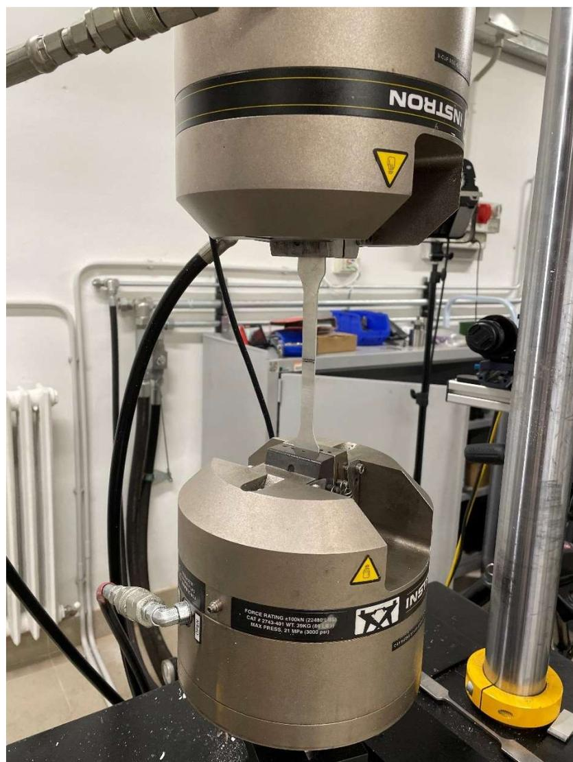
*Figura 49 Particolare del posizionamento del provino sulla macchina di prova*
