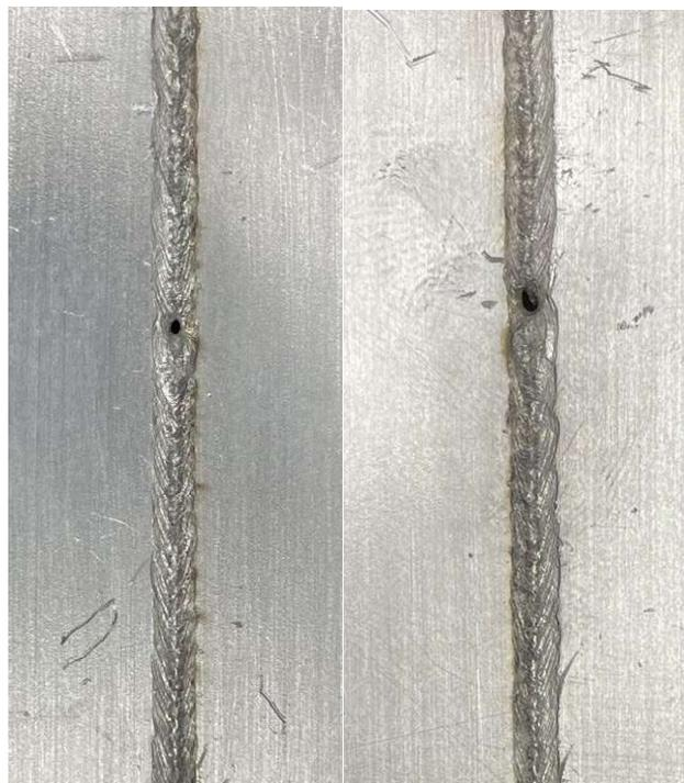
*Figura 67 Difetto di discontinuità nel cordone di saldatura, a sinistra vista superiormente, a destra vista da sotto*
