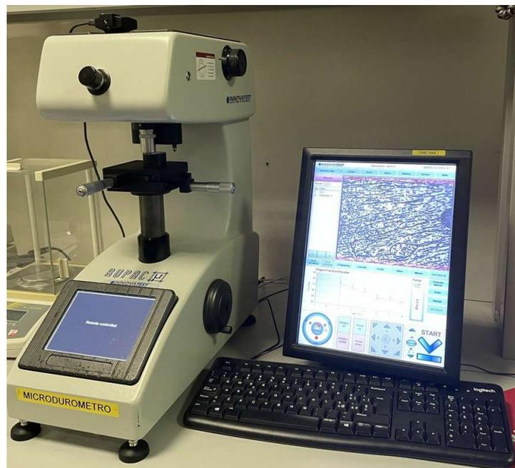
*Figura 45 Microdurometro*
