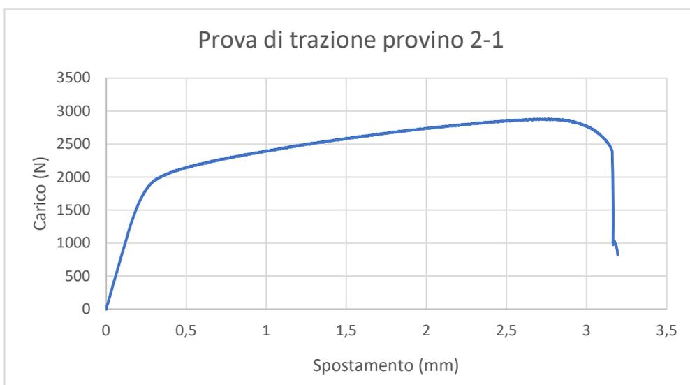
Figura 65 Grafico Carico-Spostamento provino 2-1
