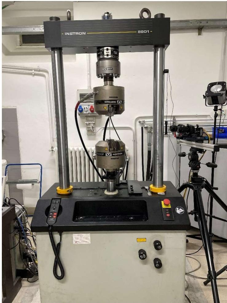
*Figura 48 Macchina servo-idraulica Instron 8801*
