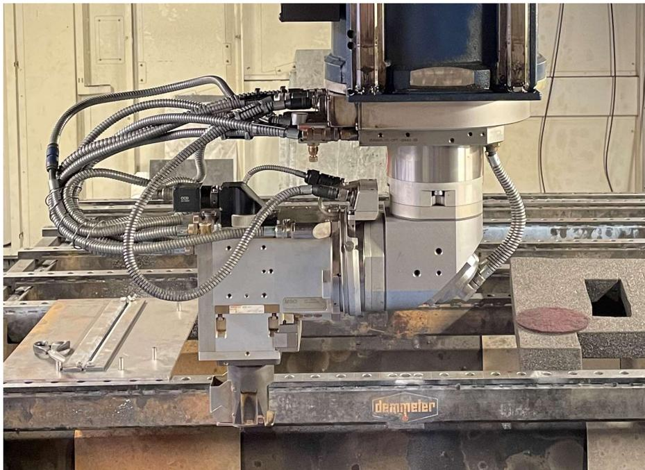
*Figura 28 Testa di saldatura*
