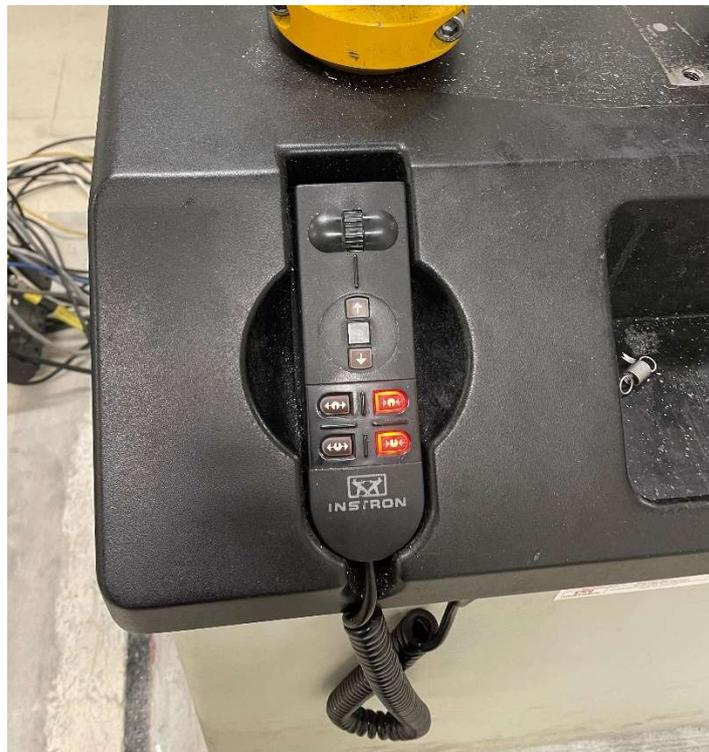
*Figura 52 Interfaccia per il comando manuale della macchina servo-idraulica*
