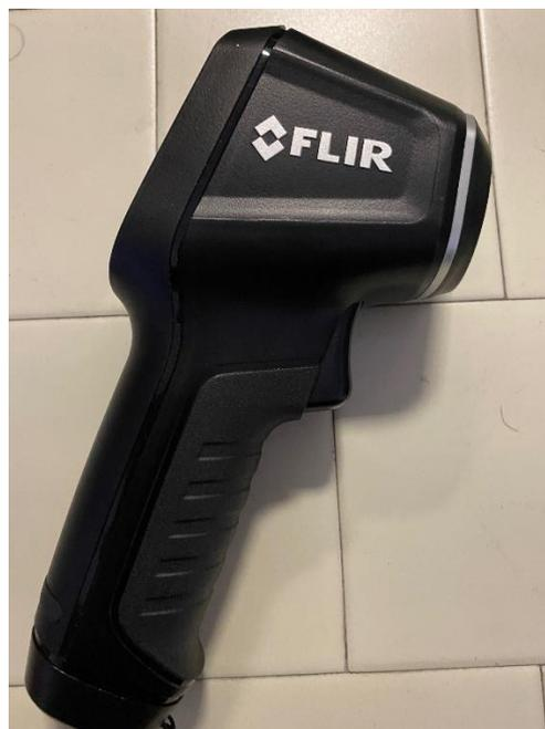
Figura 43: Pirometro per monitoraggio della temperatura del campione
