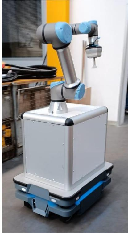
*Figura 1.3 - sistema robotico composto da un MiR250 e un UR5*
