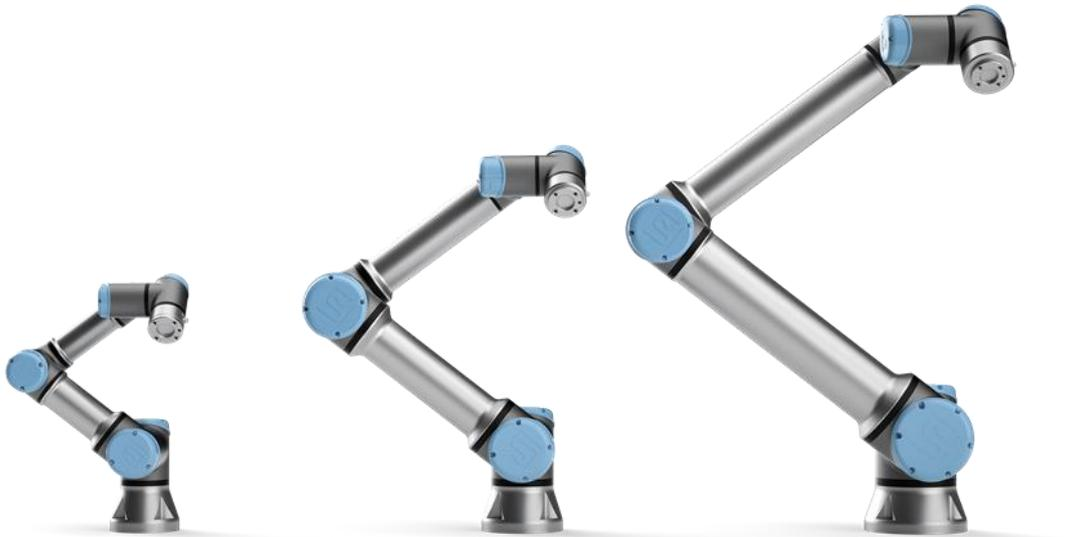
*Figura 1.2 - Modelli UR3, UR5 e UR10 della Universal Robots*
