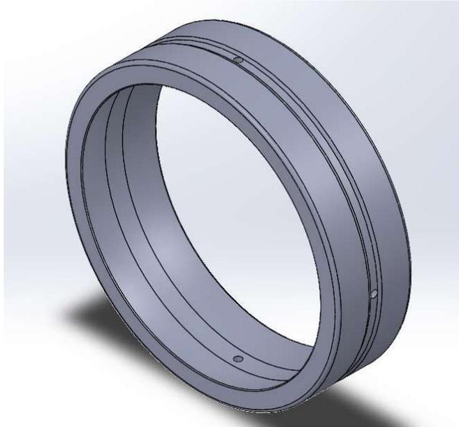
*Figura 4.4, modello CAD Solidworks del solo anello esterno del cuscinetto SKF 22240 CCK/W33 oggetto di studio*
