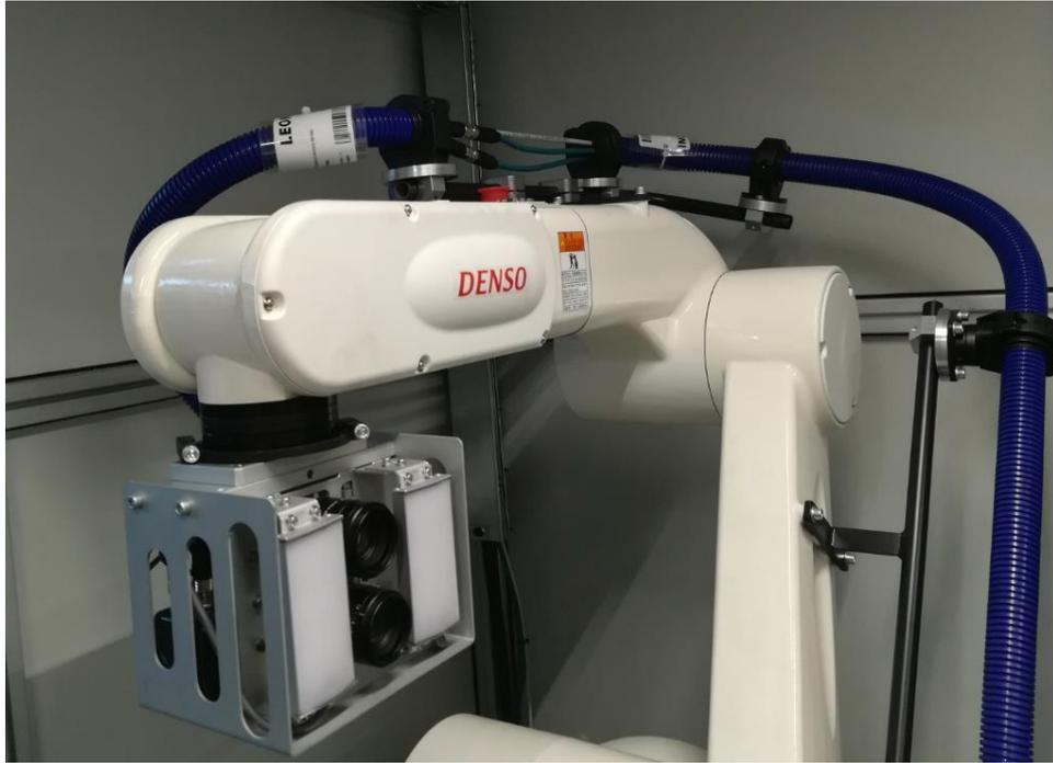
*Figura 2.5 Sistema di visione con braccio robotico*
