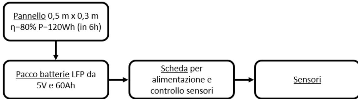
Figura 53: Schema collegamento alimentazione sensori
