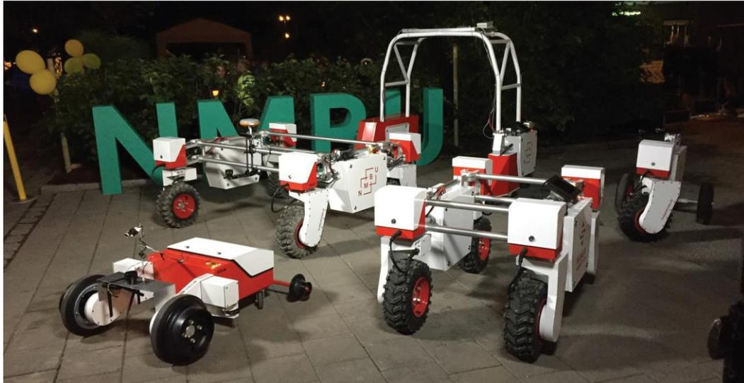
Figura 12: Esempi di robot assemblati con moduli Thorvald
