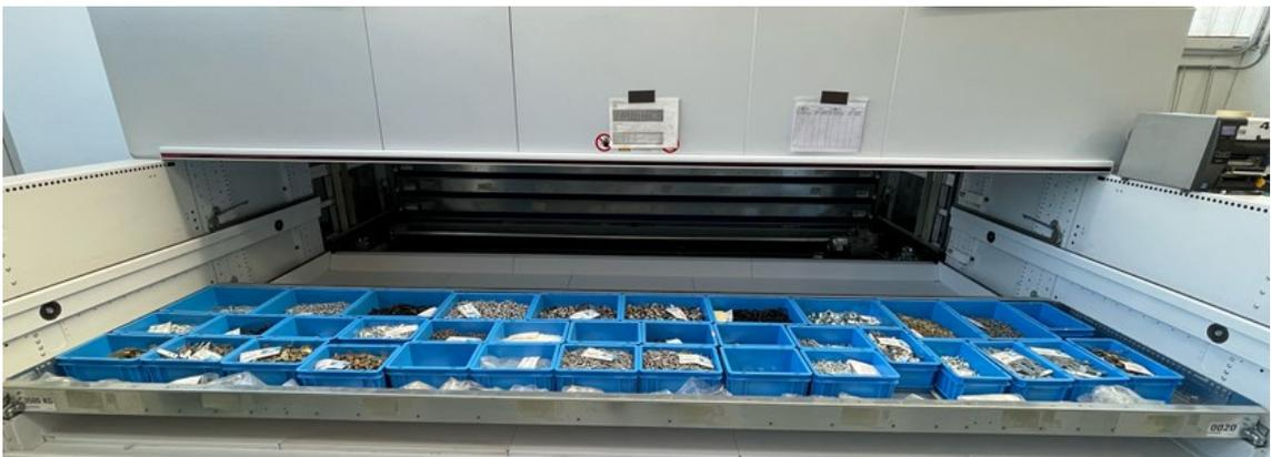
*Figura 3.20 Esempio di cassetto dei magazzini automatici adibiti allo stoccaggio di componenti*
