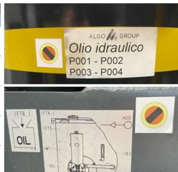
Figura 4.8 Legenda oli, esempio di identificazione fusto olio, esempio di identificazione corretto olio a bordo macchina
