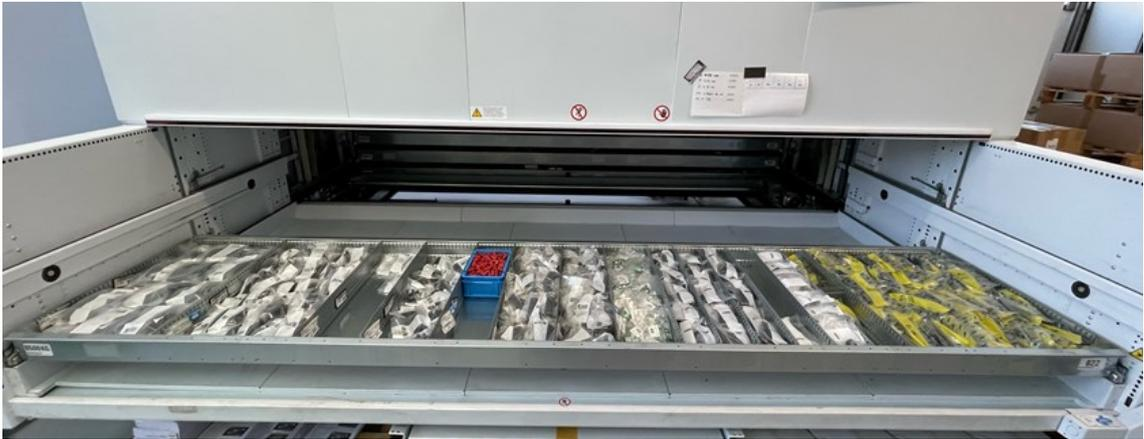
*Figura 3.19 Esempio di cassetto dei magazzini automatici adibiti allo stoccaggio di prodotti finiti*
