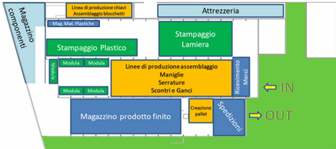
Figura 2.9 Layout del Blocco A – Dettaglio carico e scarico merci
