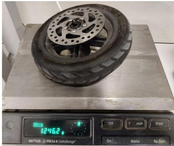
*Immagine 2.2.2. Fotografia reale del peso della ruota posteriore fornita dal dipartimento di autoveicolo del Politecnico di Torino*
