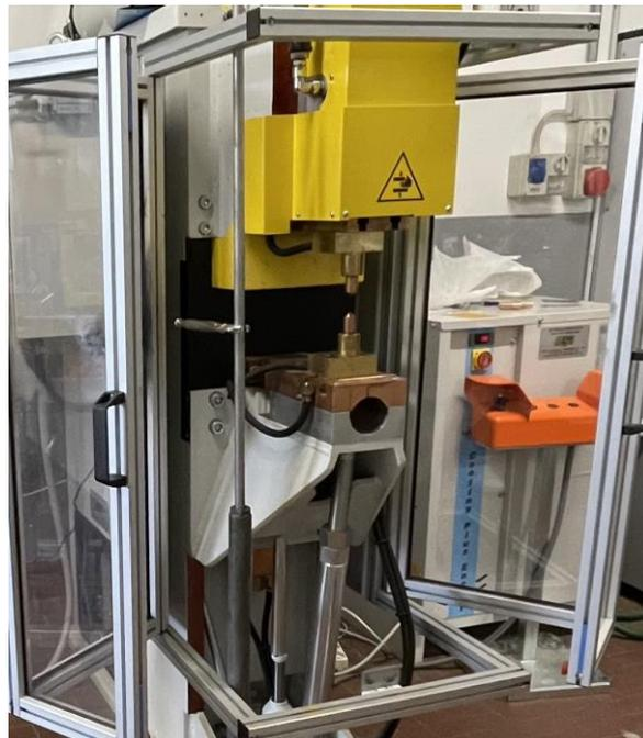
*Figura 5 - saldatrice a punti*
