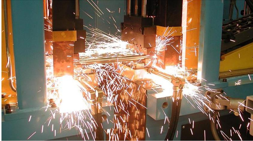
*Figura 4 - saldatura per scintillio [10]*
