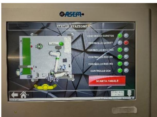
Figura 22 - Controllo conformità fanale OP40
