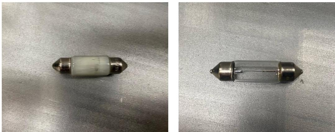
Figura 38 - A sx lampadina KO, a dx lampadina conforme
