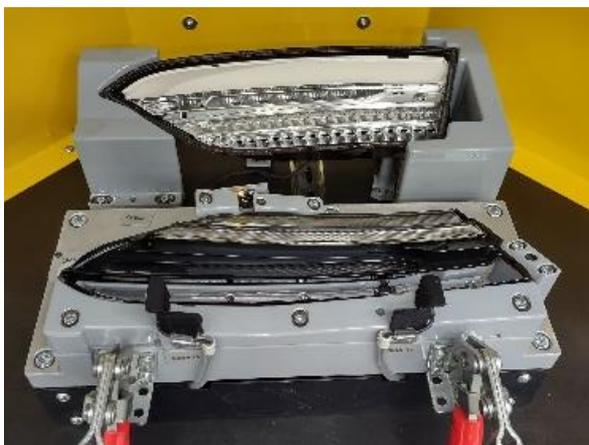
*Figura 18 – Posaggio con bezel saldato e gruppo corpo fase OP20*
