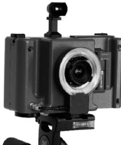
Fig. 2.11: fotocamera metrica INCA 3
