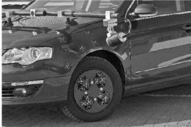
Fig. 2.10: fotocamera ad alta velocità per riconoscimento dei target (AICON)
