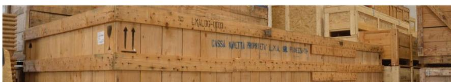
Figura 25. *“Cassa Navetta” in legno, utilizzata per il trasporto di pezzi di grandi dimensioni*
