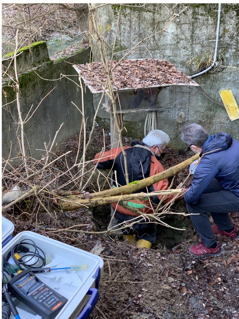
Figura 3.35-Campionamento con contenitore sterile da 0,5 l presso la sorgente Lavagello, 2022.
