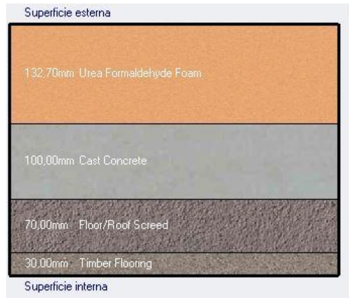
Figura 12: Stratigrafia delle strutture opache orizzontali di pavimento contro terra di entrambi gli edifici
