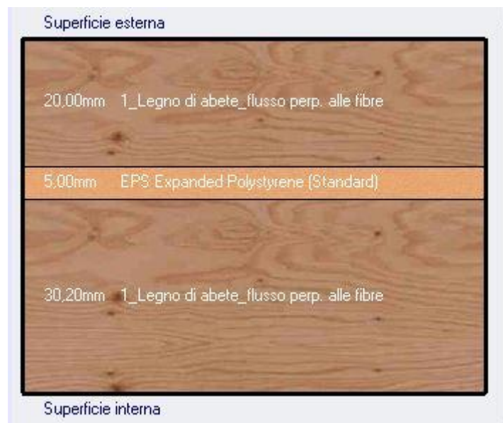
Figura 17: Stratigrafia chiusura tecnica opaca per entrambi gli edifici
